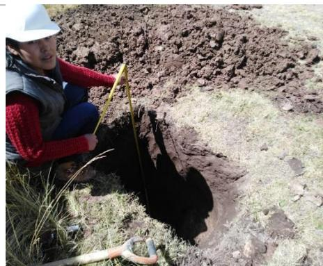
**Foto 12:** Medición de la profundidad de excavación de la calicata.
