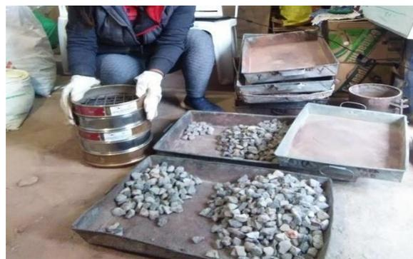
**Foto 24:** Tamizaje para Análisis Granulométrico
