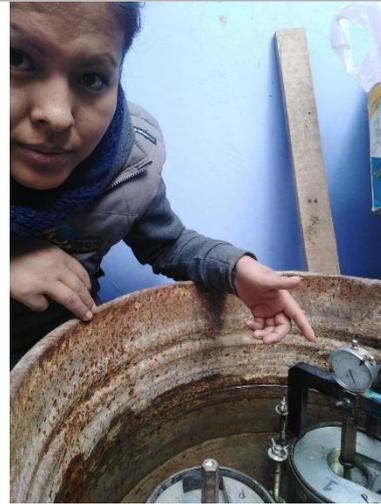
**Foto 20:** Medición de expansión de espécimen (CBR).
