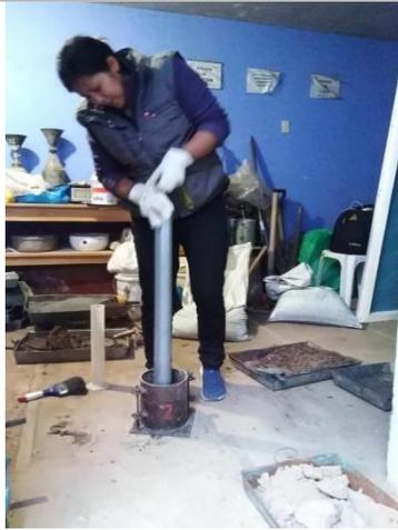
**Foto 19:** Ensayo de compactación (Próctor Modificado).
