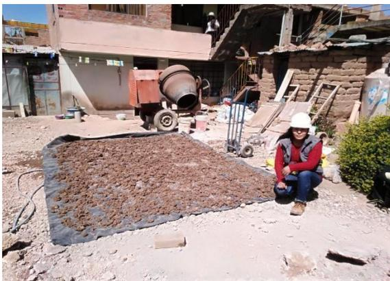
**Foto 17:** Secado de muestra extraída.
