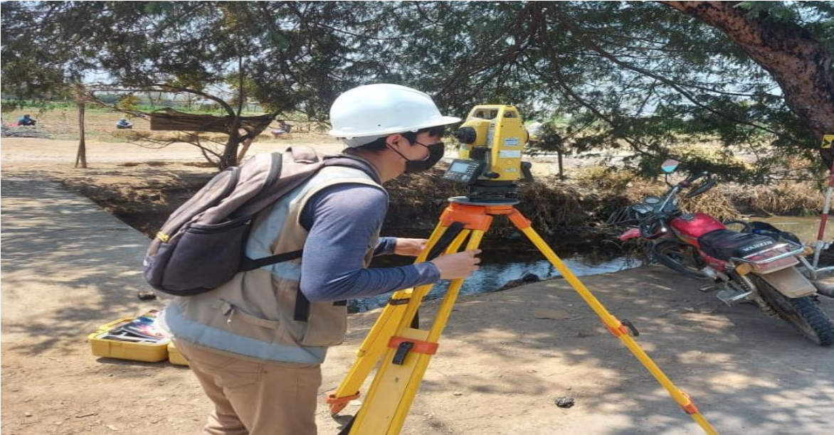
Foto N°3. Centros Poblados Puente Mayta a Mariscal Castilla: levantamiento topográfico de la carretera BMs N°10, X=675266.941; Y=9199016.650; Z=140.480, septiembre - 2022.
