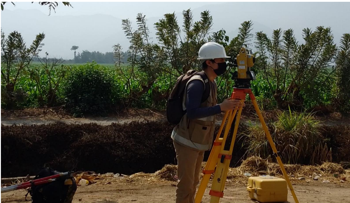
Foto N°1. Centros Poblados Puente Mayta a Mariscal Castilla: levantamiento topográfico de la carretera BMs N°4, X=677477.533; Y=9192106.239; Z=147.611, septiembre - 2022.
