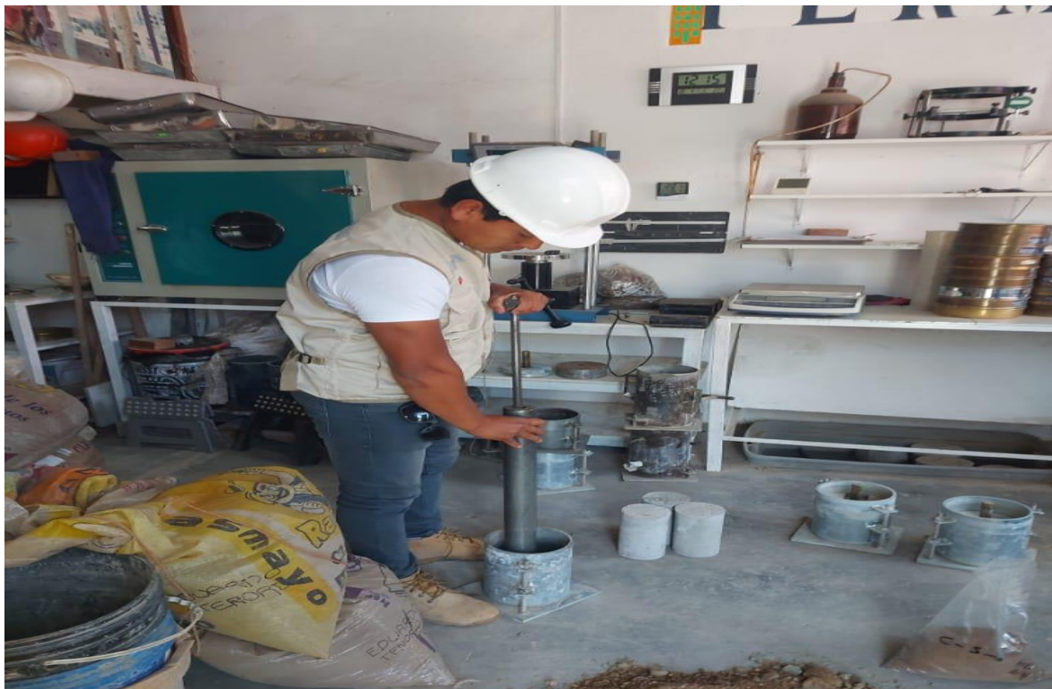
Foto N.º 17. Ensayo de CBR en el laboratorio FERMATI, septiembre - 2022.
