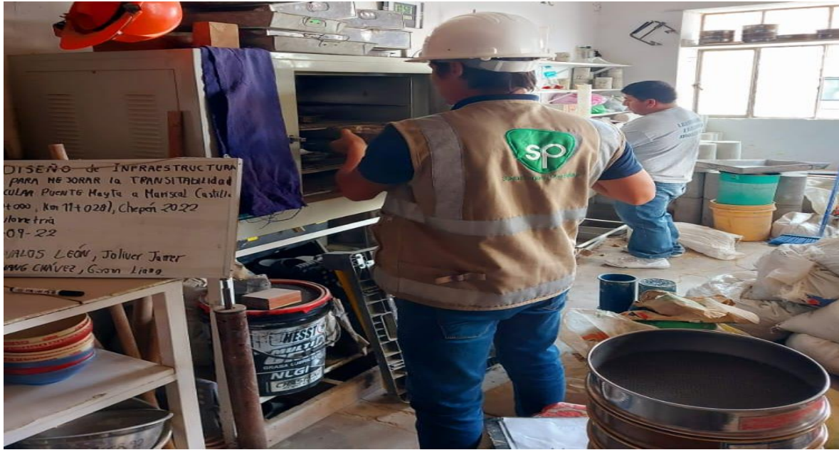
Foto N.º 16. Ensayo de Granulometría procediendo las muestras a colocar al horno del laboratorio FERMATI, septiembre – 2022.
