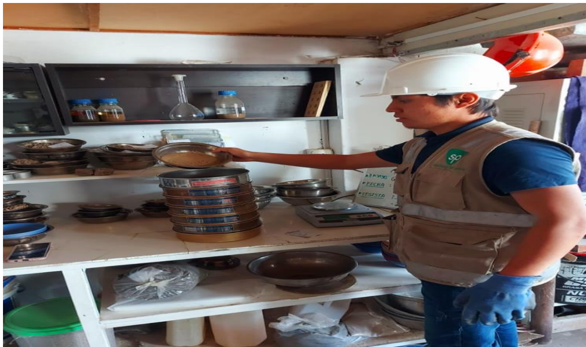
Foto N.º 12. Ensayo de Granulometría en laboratorio FERMATI, septiembre – 2022.
