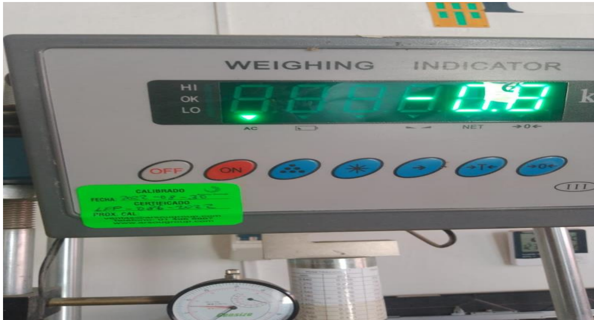
Foto N.º 18. Calibración del equipo CBR del laboratorio FERMATI, septiembre - 2022.
