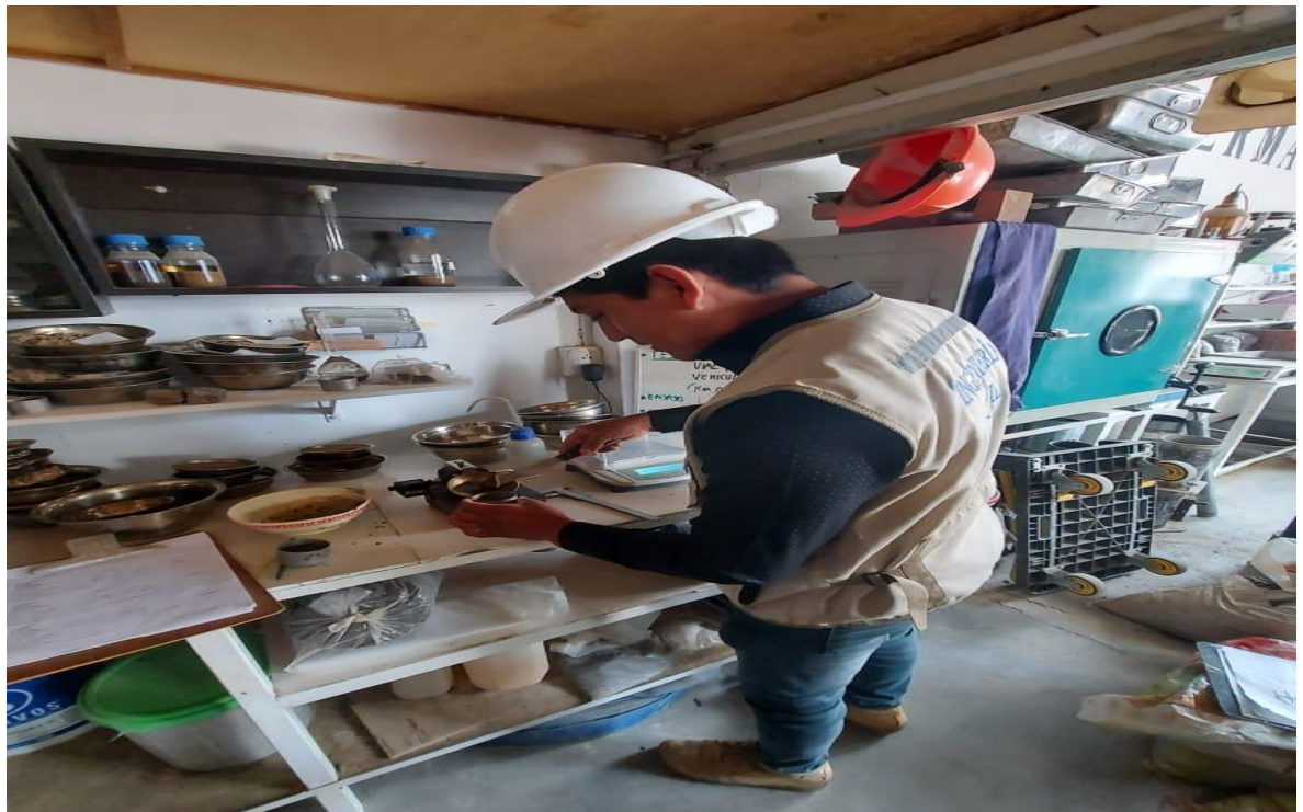
Foto N.º 10. Ensayo de Límites (LL, LP, IP) en el laboratorio FERMATI, septiembre – 2022.
