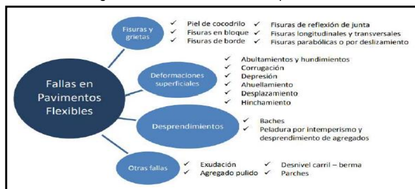
Figura 4. Resumen de fallas en pavimentos
