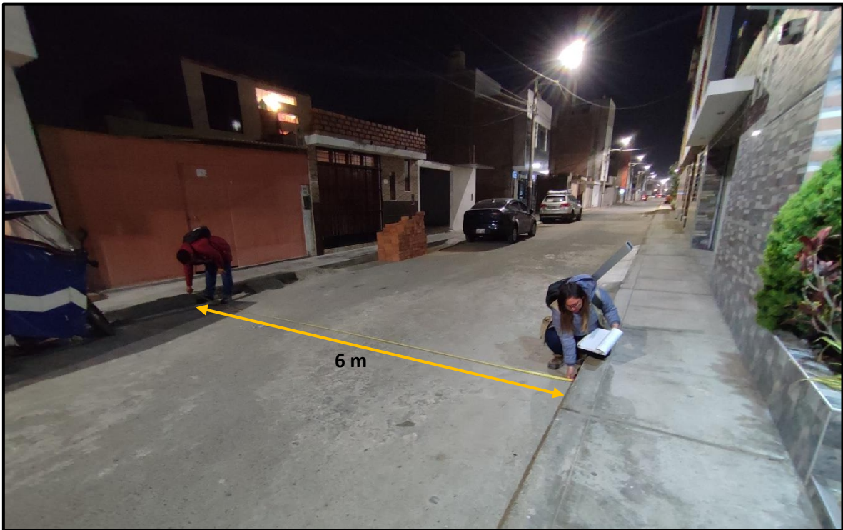
FOTO 03: Medición del Ancho de la Calzada
