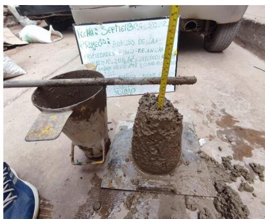
Figura 12. Prueba SLUMP
