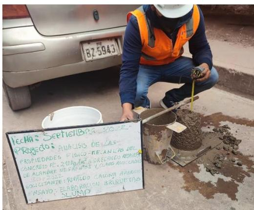
Figura 11. Ensayo de Asentamiento
