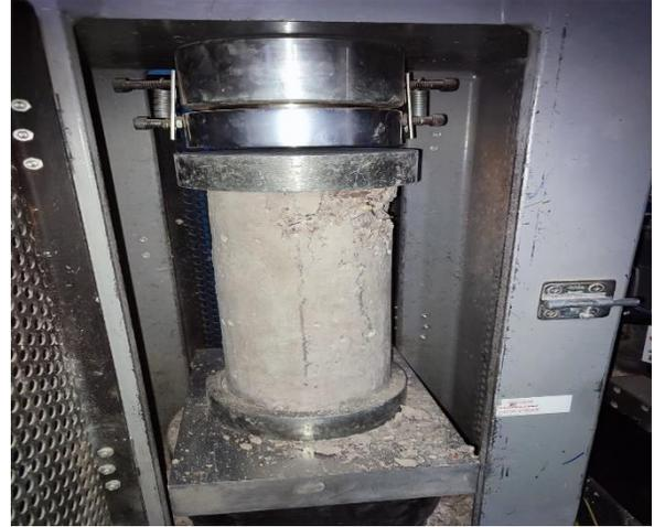
Resistencia a Compresión del concreto con 1.25% de RAN y 12% de CR (28 días)
