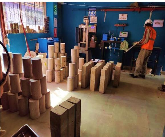
Probetas para la Resistencia a Compresión, Flexión y Tracción de la edad de 7 días.
