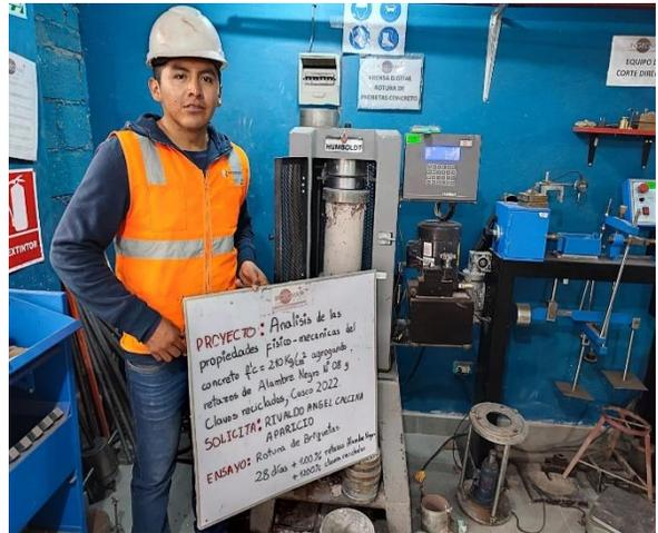
Resistencia a Compresión del concreto con 1.00% de RAN y 12% de CR (28 días)
