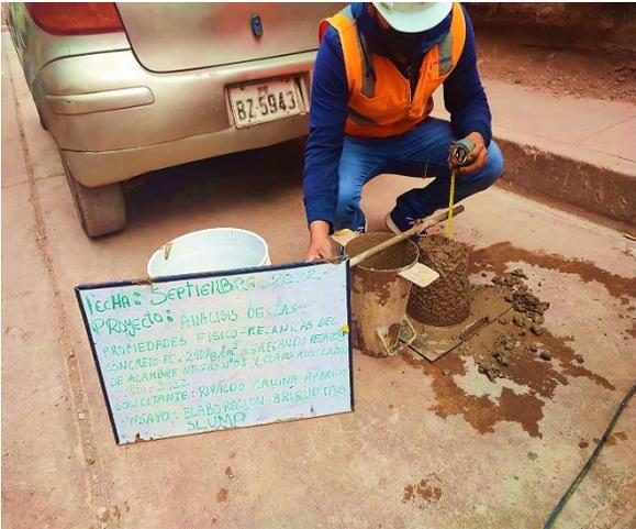
Ensayo de Trabajabilidad (SLUMP)
