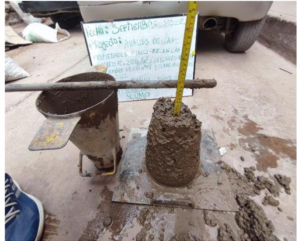
Ensayo de Trabajabilidad (SLUMP)
