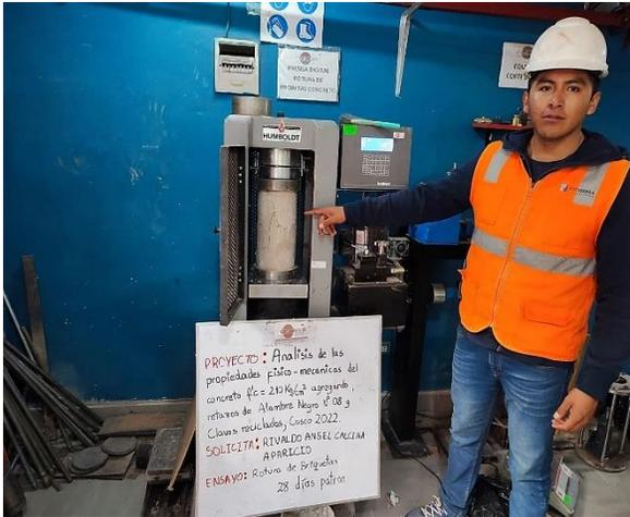
Resistencia a Compresión del concreto Patrón (28 días)
