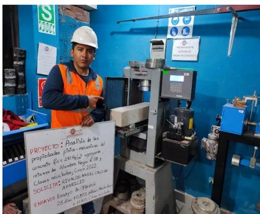
Figura 17. Resistencia a Flexión
