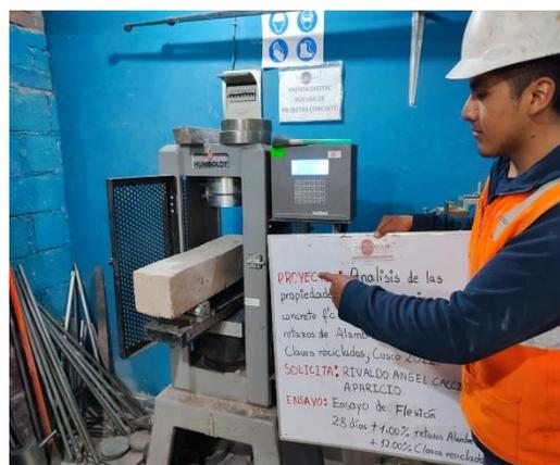
Figura 18. Resistencia a Flexión
