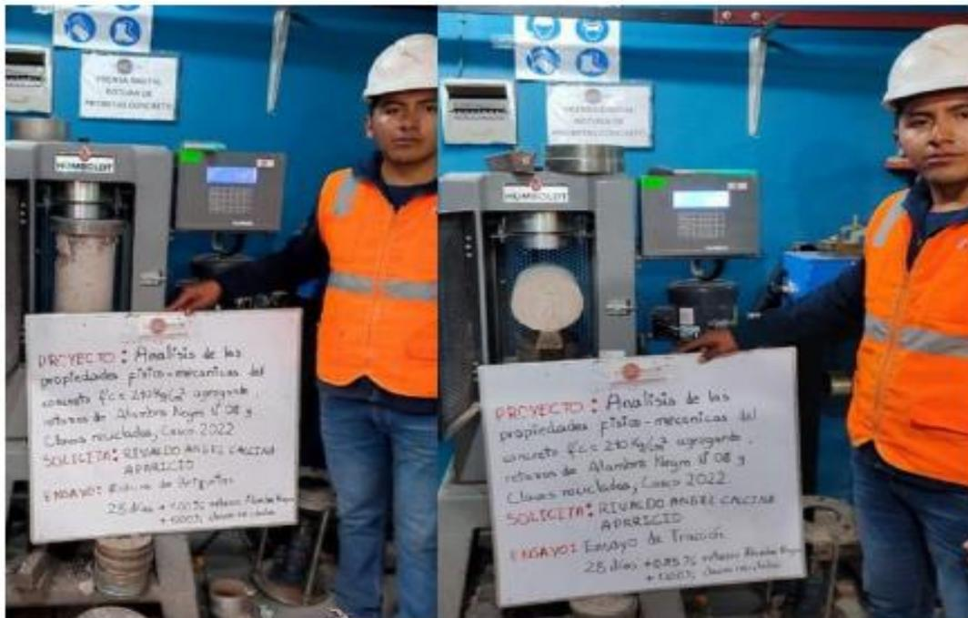
**ESPECIMENES CILINDRICOS DE CONCRETO**
