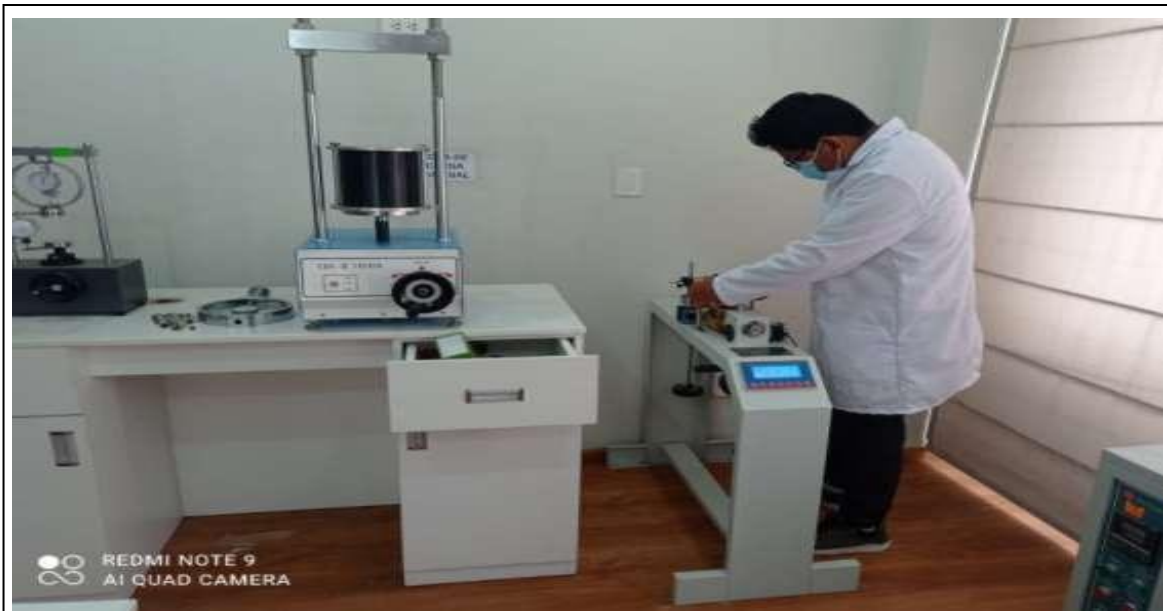
Foto N°8: Ensayo de laboratorio, ensayo de corte directo de muestra alterada extraída del área de estudio.
