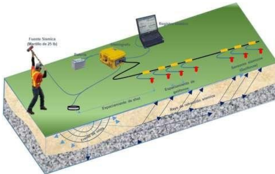
Figura 3.3. Disposición de los geófonos y shot (puntos de disparo)
