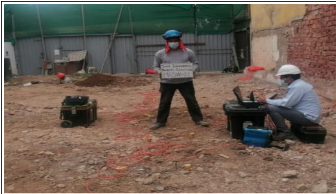
Figura 23. Ensayo de MASW-01 para determinar las velocidades de ondas S Fuente: Elaboración Propia
