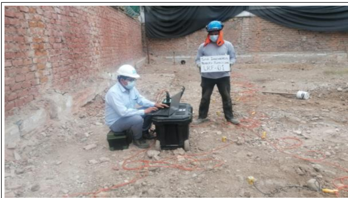
Figura 24. Ensayo de Refracción sísmica LRF-01 y MASW Fuente: Elaboración Propia
