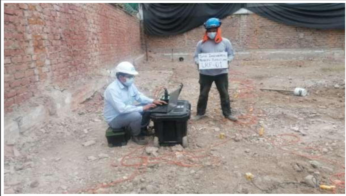
Foto N°7: Ensayo de Refracción sísmica LRF-01, Para determinar las velocidades de ondas P.
