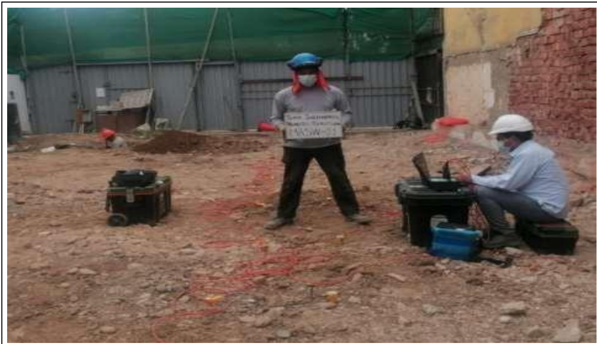
Foto N°6: Ensayo de MASW-01 para determinar las velocidades de ondas S.
