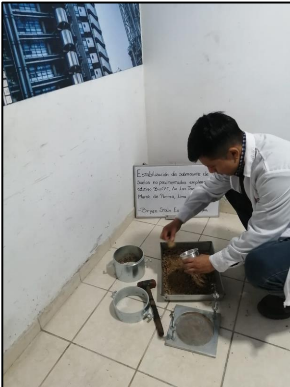
Fotografía 13: Ensayo de Proctor Modificado.
