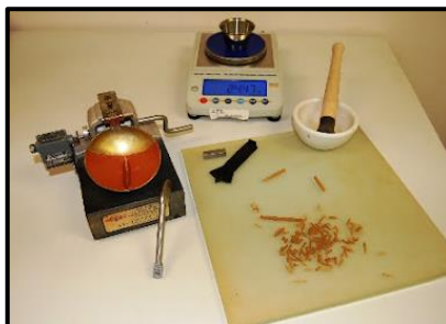
Figura 2. Equipos para el límite líquido.
