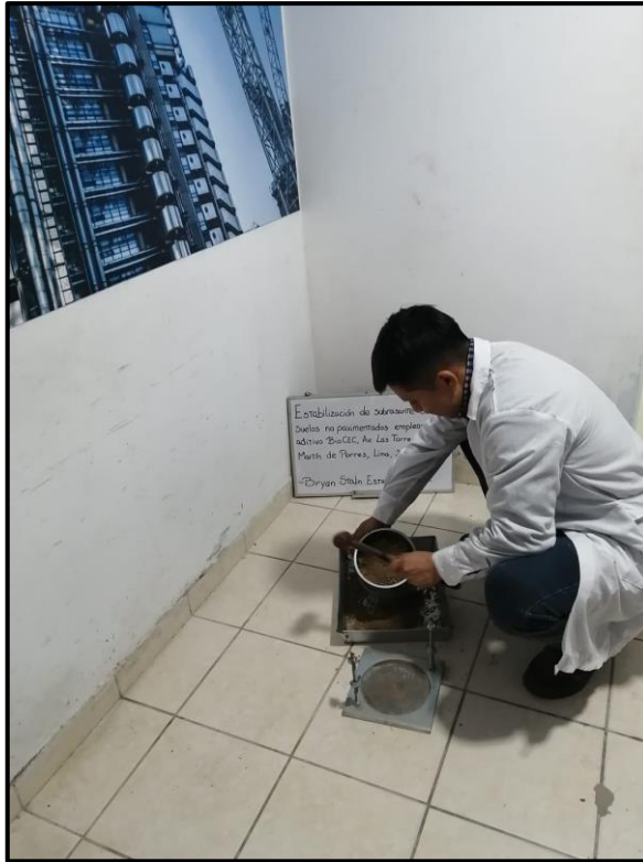
Fotografía 14: Ensayo de CBR.
