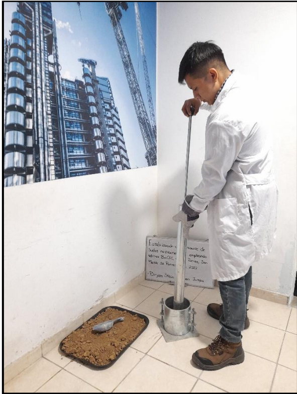
Fotografía 13: Ensayo de Proctor Modificado.
