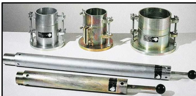
Figura 4. Equipos para el Proctor Modificado.
