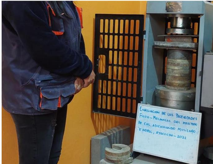
Figura N° 24: Ensayo de resistencia a la flexión en especímenes
