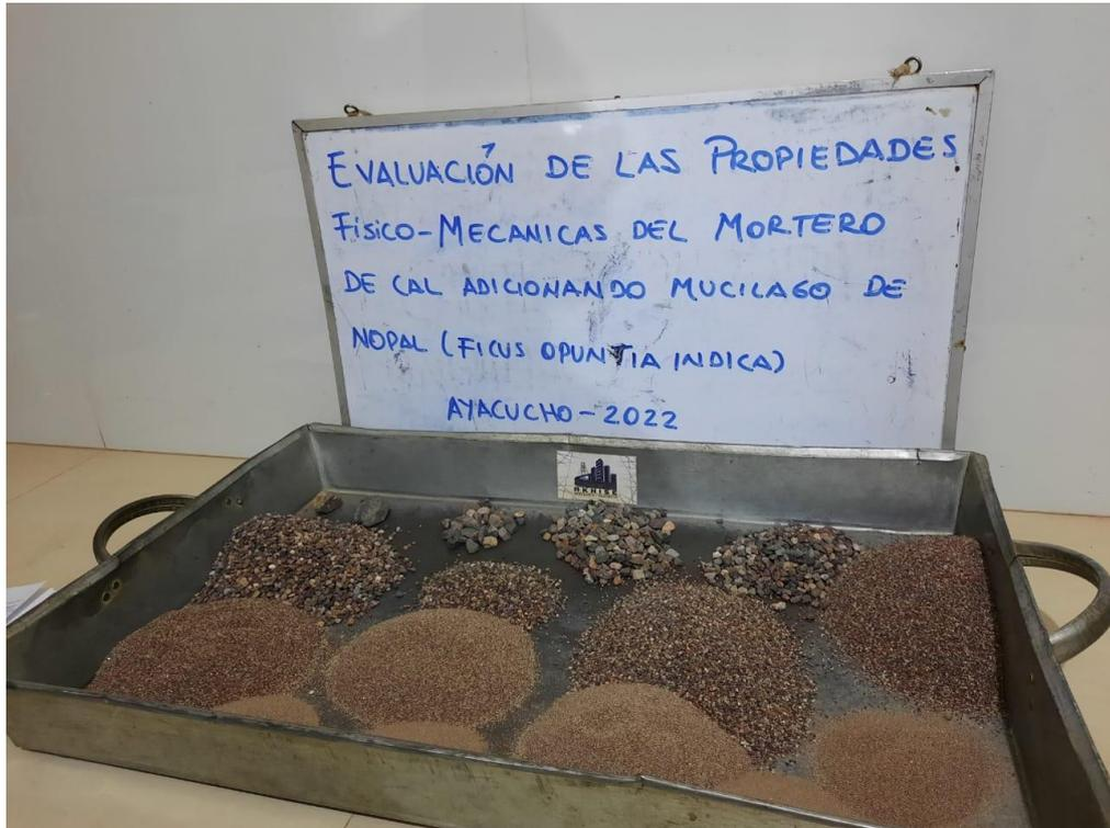
Figura N° 13: Agregado fino retenido por cada tamiz
