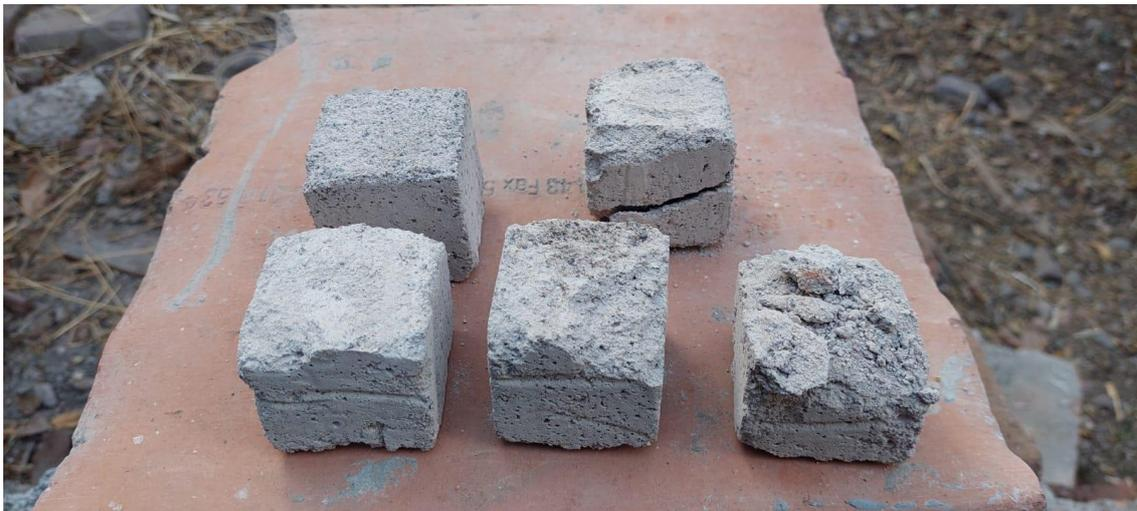
Figura N° 19: Pruebas para la determinación de % de mucilago de nopal
