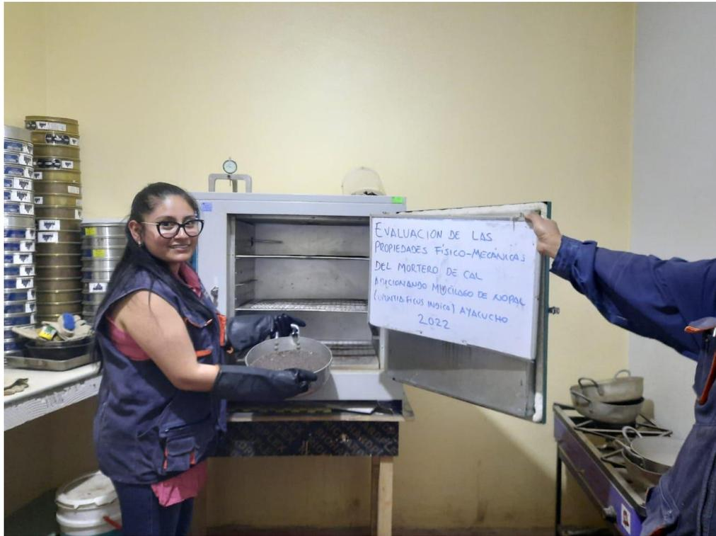
Figura N° 11: agregado fino llevado al horno
