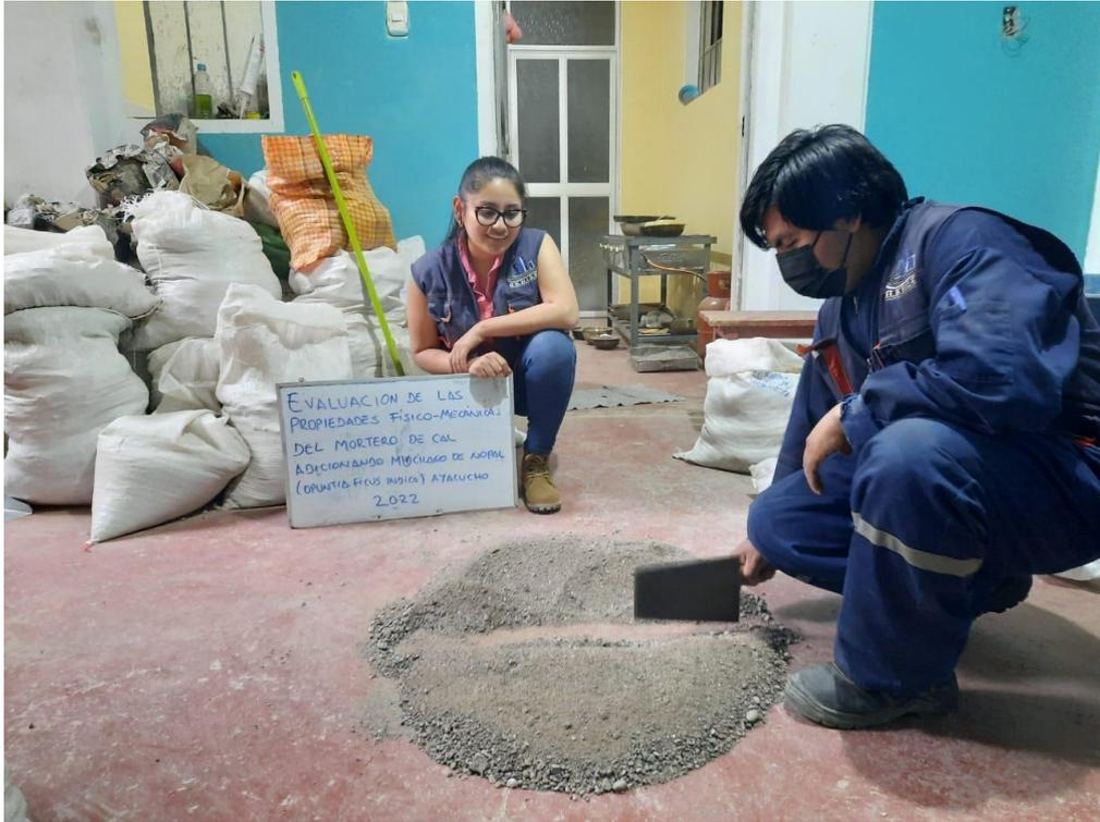
Figura N° 07: Cuarteo del agregado fino para la realización del ensayo de granulometría
