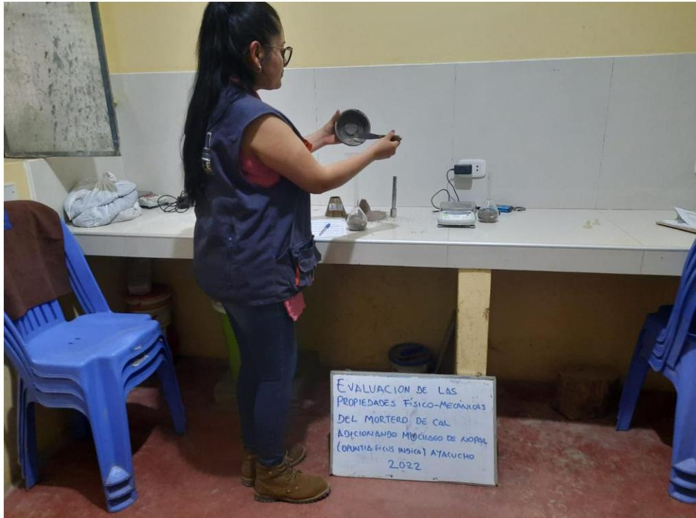
Figura N° 09: Gravedad específica del agregado fino
