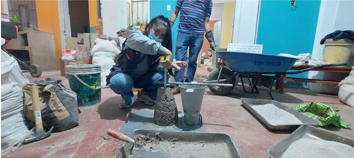
Figura N° 18: Medición del asentamiento del mortero patrón y con adiciones de mucilago de nopal
