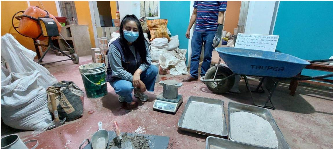
Figura N° 16: Medición del peso unitario del mortero patrón y con adiciones de mucilago de nopal
