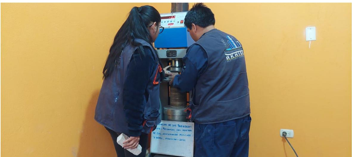
Figura N° 23: Ensayo de resistencia a la flexión en especímenes
