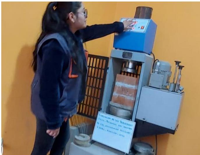
Figura N° 25: Ensayo de resistencia a la compresión en pilas
