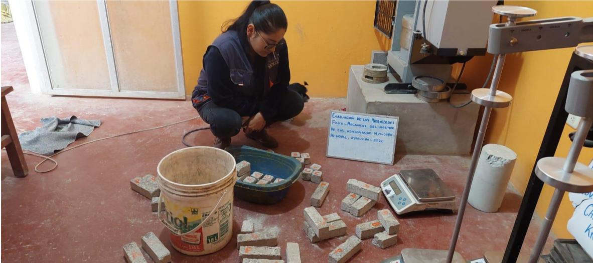
Figura N° 21: Ensayo de resistencia a la compresión
