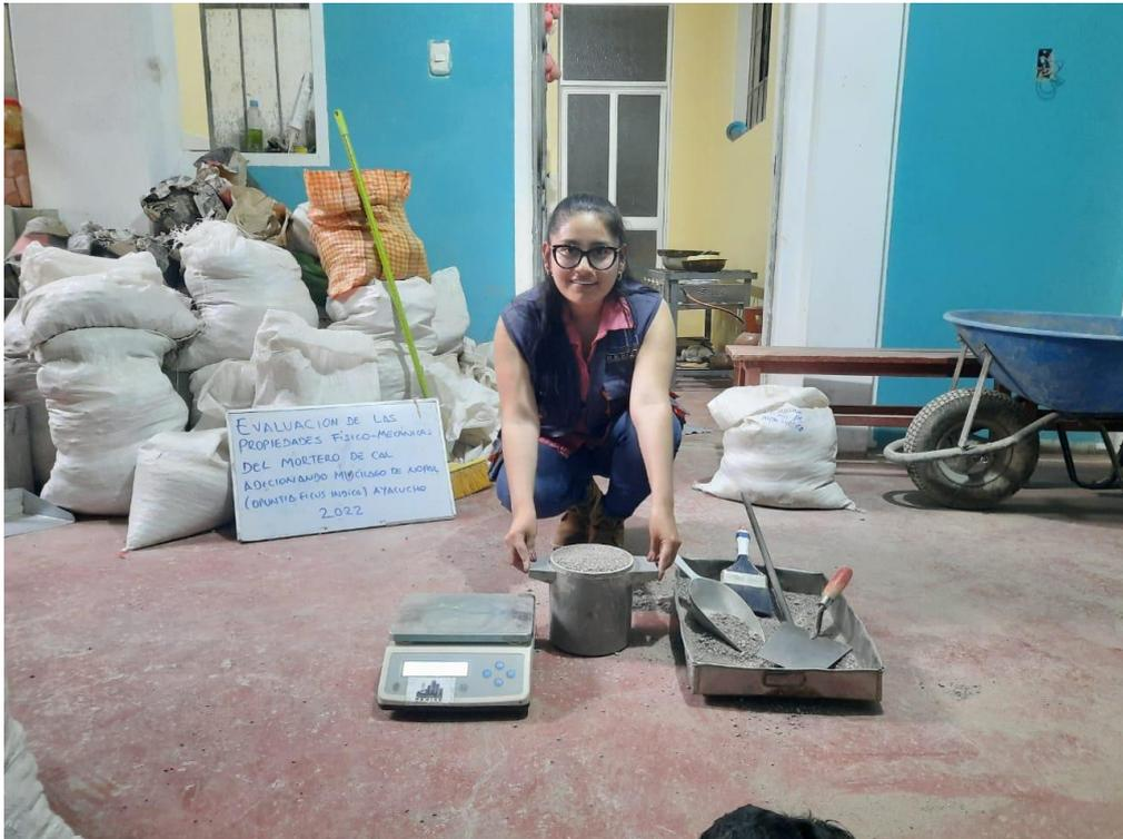
Figura N° 08: Peso unitario del agregado fino
