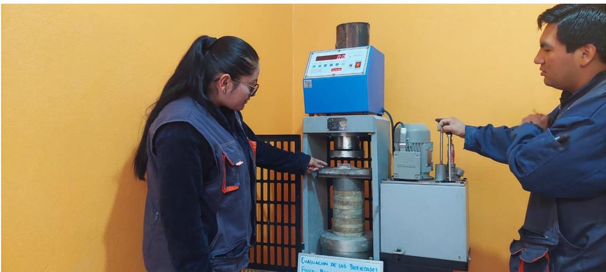
Figura N° 22: Ensayo de resistencia a la compresión en primas
