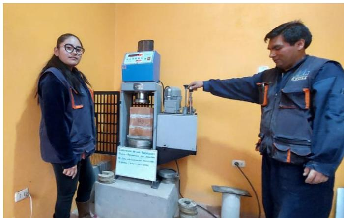
Figura N° 26: Ensayo de resistencia a la compresión en pilas
