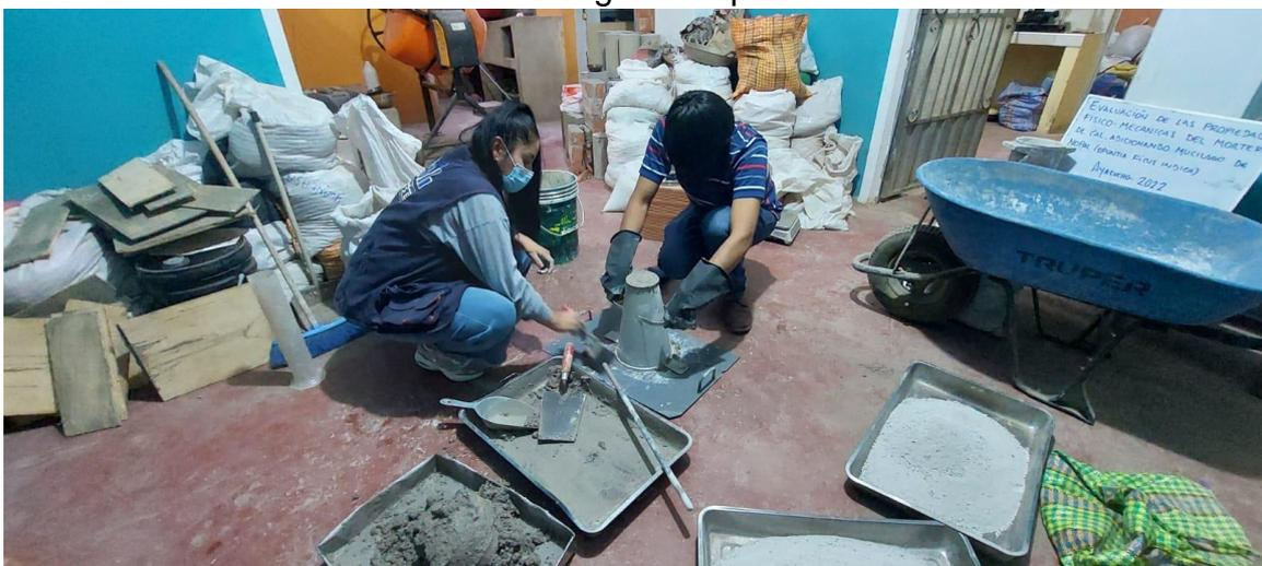
Figura N° 17: Medición del asentamiento del mortero patrón y con adiciones de mucilago de nopal
