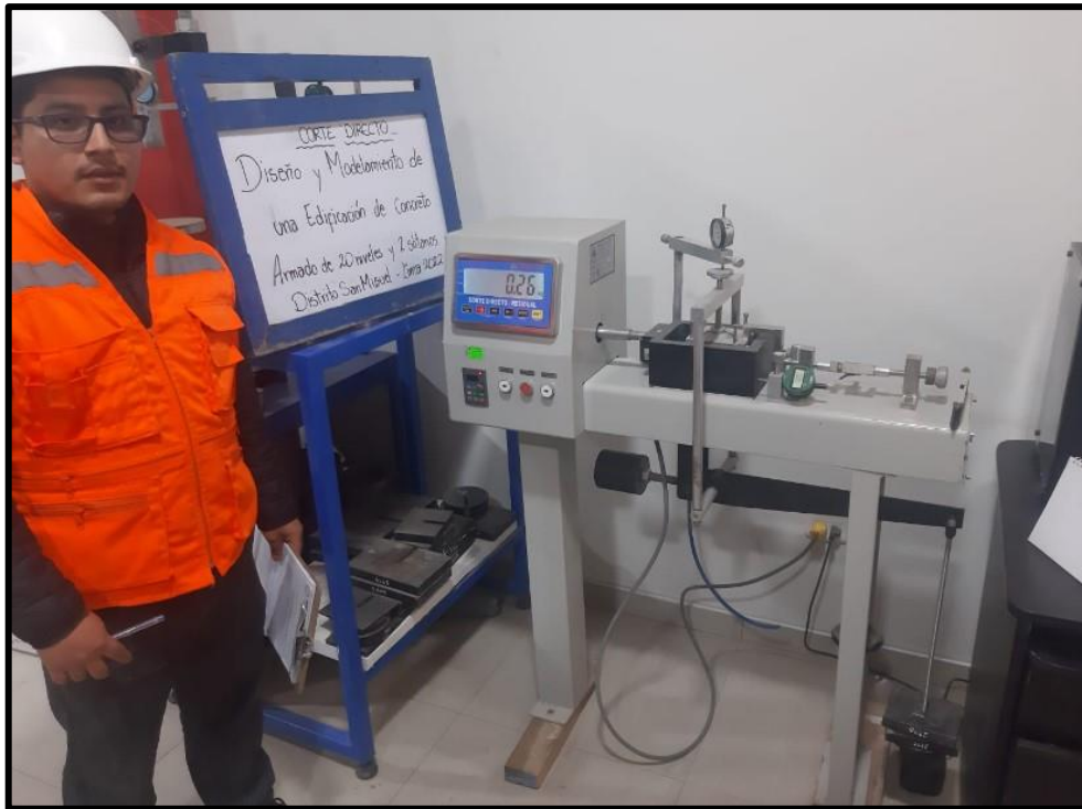
Fotografía N° 09: Ensayo de corte directo
