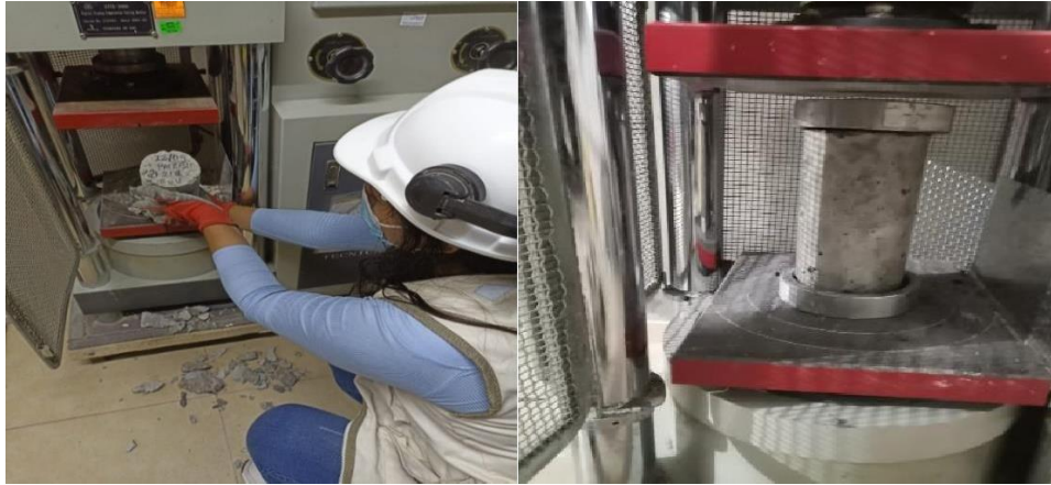
Figura 9. Realización de ensayo de resistencia a compresión.
