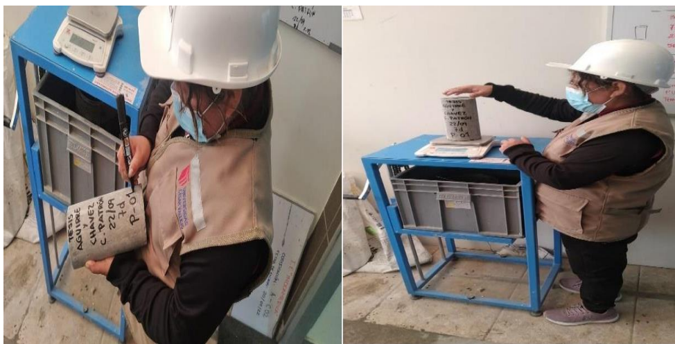
Figura 8. Identificación y pesado de las muestras cilíndricas
