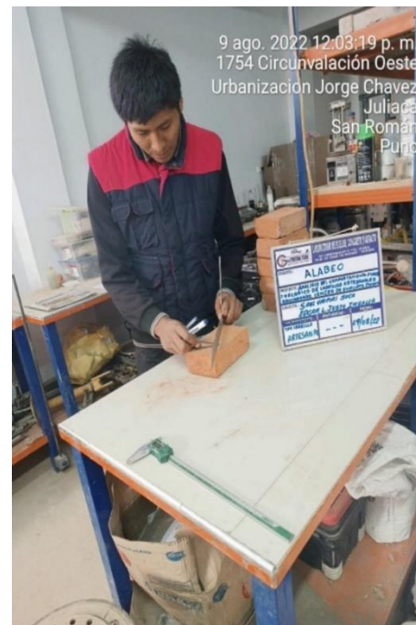
FIGURA N° 47,48 y 49 Realizamos la prueba de alabeo para establecer la convexidad y la concavidad de los especímenes con la añadidura de ceniza de eucalipto.
