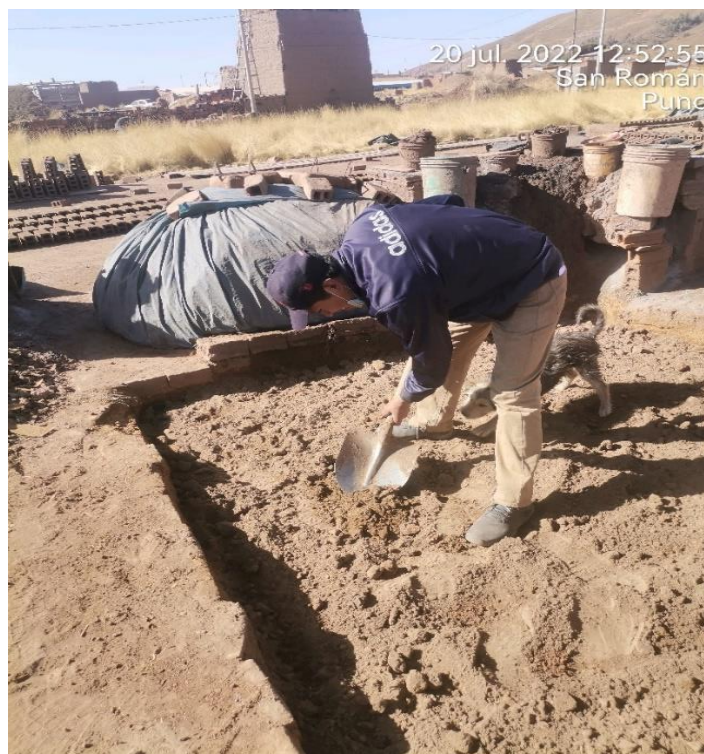
FIGURA N° 13 Realizando el mezclado de los materiales este proceso se realiza durante 2 a 3 horas dependiendo de la cantidad de ladrillos a realizar.
