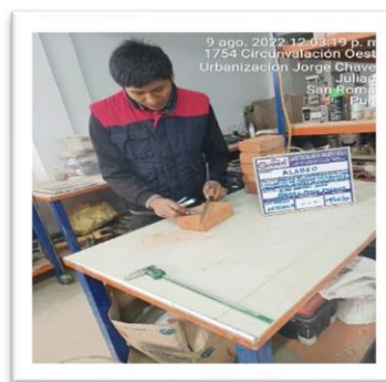
Figura 10 Ensayo de Alabeo, Fuente: Propia,2022.
