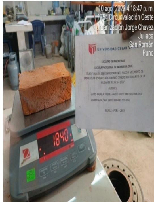
FIGURA N° 45 y 46 realizando el colocado de los ladrillos en el horno de laboratorio para posteriormente pesar las unidades de ladrillos.
