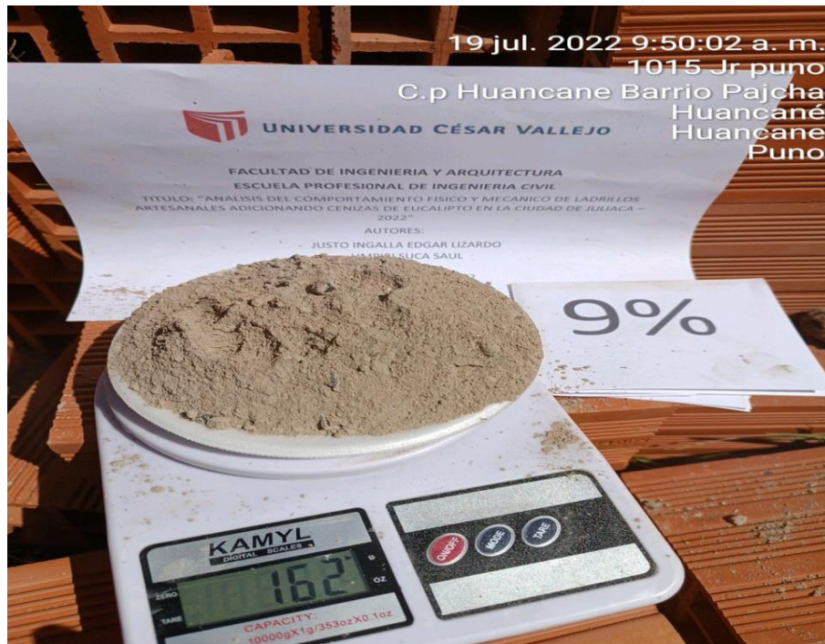
FIGURA N° 20 El porcentaje de ceniza de eucalipto en recipientes con sus respectivos pesos.
