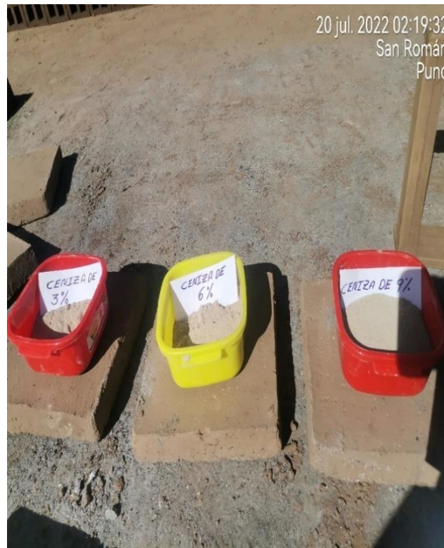
FIGURA N° 20 El porcentaje de ceniza de eucalipto en recipientes con sus respectivos pesos.
