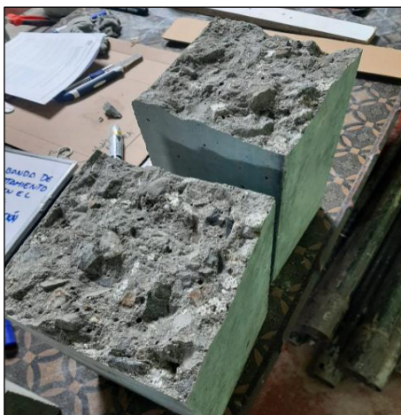
Imagen 5: Prueba de resistencia a la tracción y compresión.
