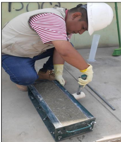
Imagen 3: Prueba del Slump y elaboración de viguetas
