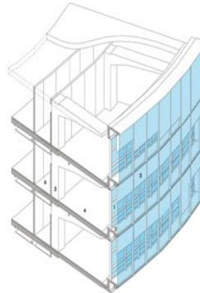
La piel de los pabellones de salones esta constituido por vidrio templado el cual tiene una alta resistencia a cambios de temperatura brindando seguridad para superficies exteriores. Esa estructura es independiente a la estructura del edificio solamente unida con anclajes a las losas.
