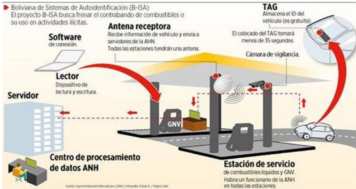
Figura: Tecnología RFID para el control de abastecimiento de combustible
