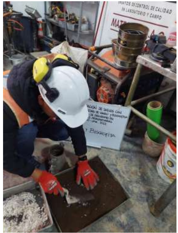
Ensayo de Proctor Modificado
