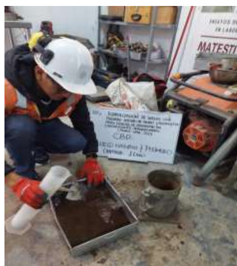
Figura 31: Ensayo de CBR (polímero)
