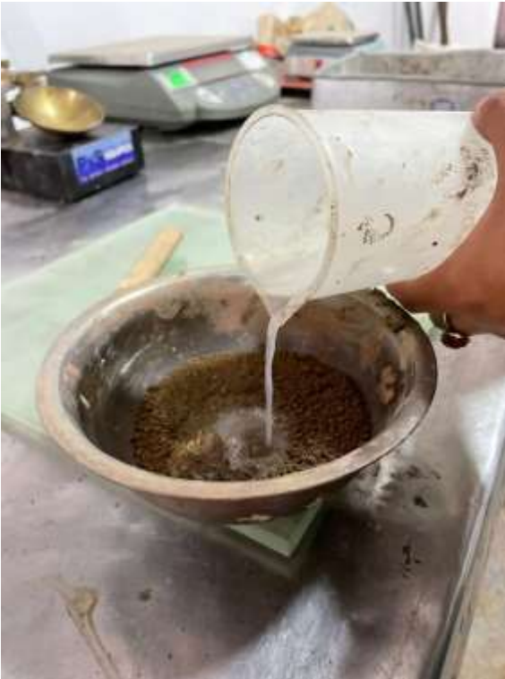
Ensayo de límites de Atterberg
