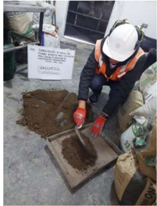
Ensayo de cuarteo
