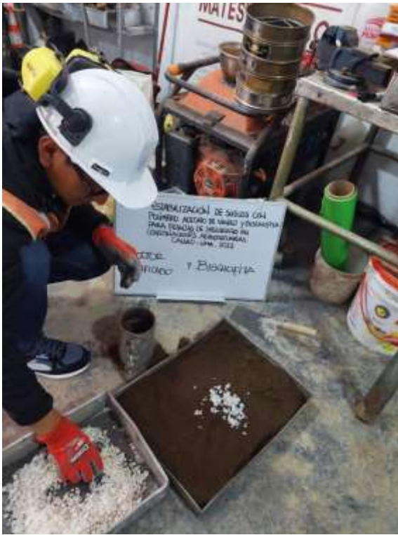
Ensayo de Proctor Modificado
