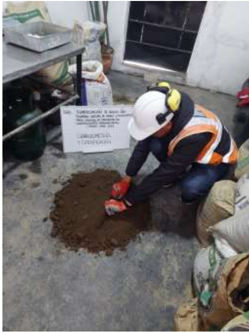
Ensayo de cuarteo
