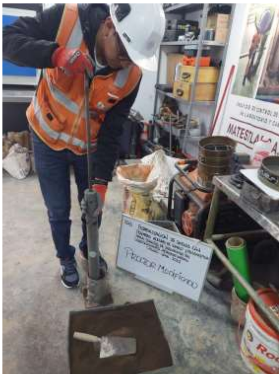
Ensayo de Proctor Modificado
