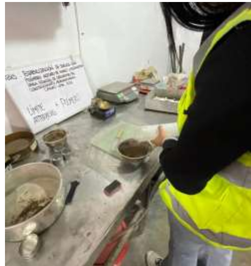
Figura 17: Ensayo de Límites de Atterberg (polímero acetato de vinil) Fuente: Elaboración propia.
