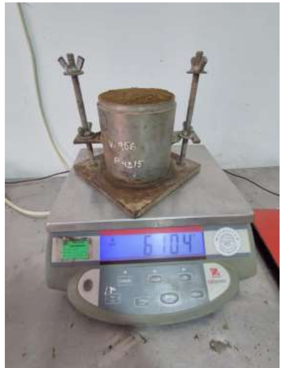
Ensayo de Proctor Modificado
