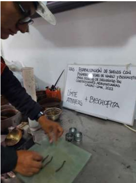
Ensayo de límites de Atterberg
