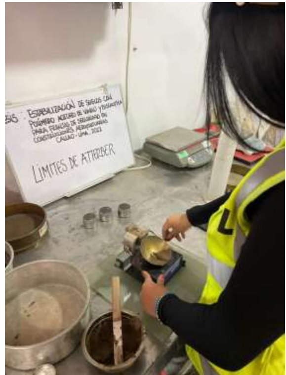
Ensayo de límites de Atterberg
