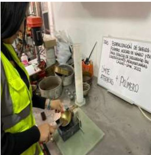
Figura 16: Ensayo de Límites de Atterberg (polímero acetato de vinil) Fuente: Elaboración propia.
