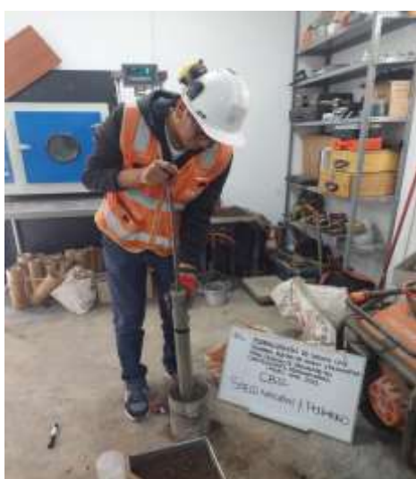
Figura 30: Ensayo de CBR (polímero)
