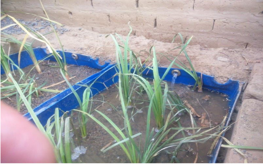
FIGURA N°23 Se observa el agua residual ingresando a el biofiltro con eneas para su debido tratamiento.
