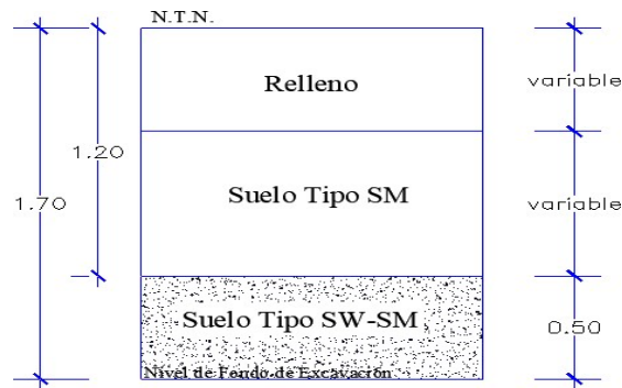
Figura 2 Detalle de Calicata
