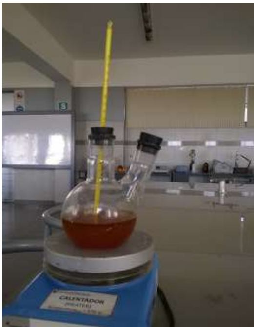
Figura 9 : Montaje Del Reactor A Utilizar
