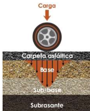
Figura 2: Distribución de cargas en pavimentos flexibles
