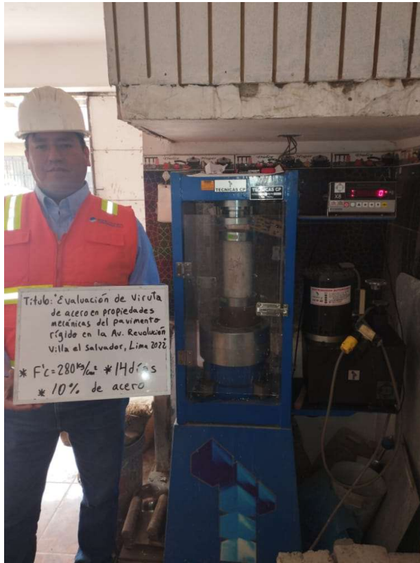
Foto 19: Ensayo de compresión a 14 días, patrón + 10%
