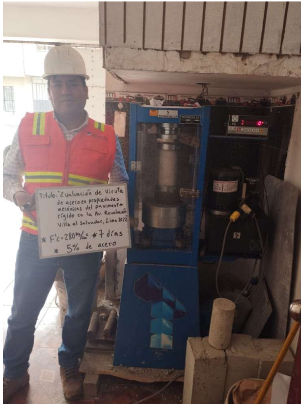
Foto 15: Ensayo de compresión, patrón + 5%, 7d.
