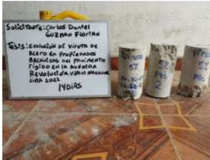
Figura 22: Probetas ensayadas, patrón + 5%, 14 días
