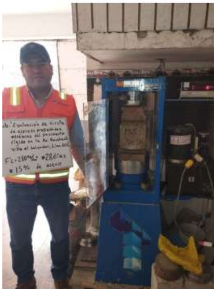
Figura 31: Ensayo de compresión, patrón + 15%, 28 días
