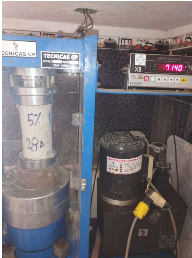
Foto 27: Muestra lista para ensayo a compresión.
