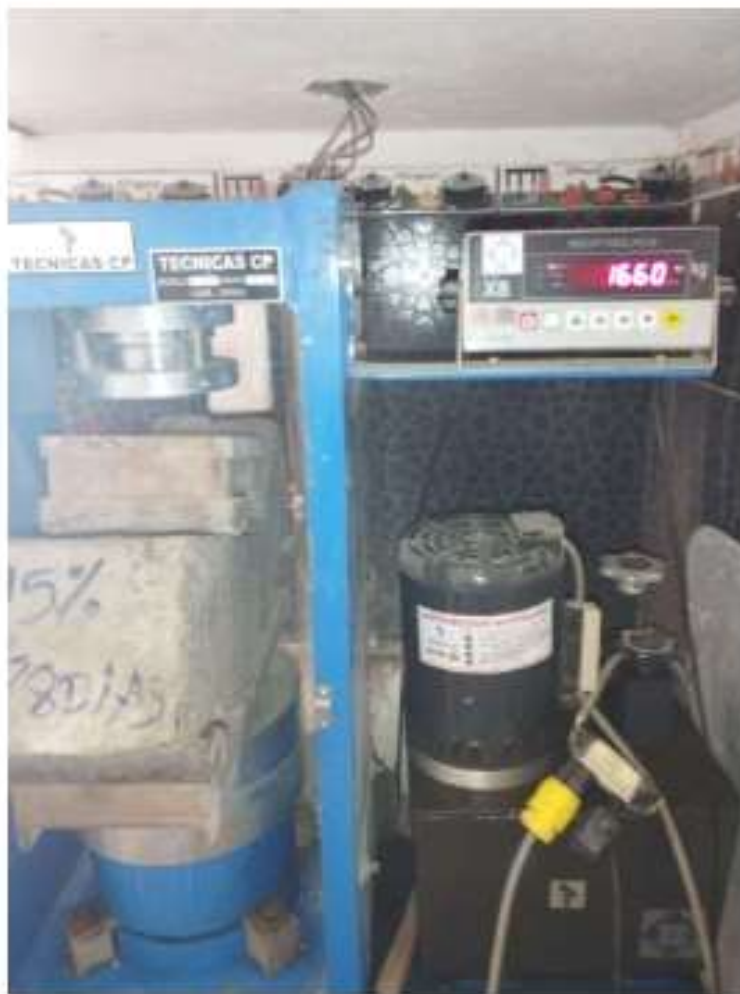
Figura 34: Viga ensayada a flexión, patrón + 15%
