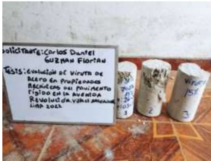
Figura 30: Probetas ensayadas, patrón + 15%, 7 días
