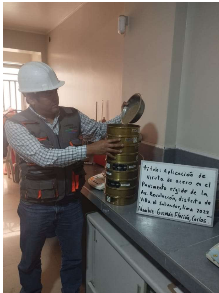
Foto 06: Ensayo de granulometría para agregado fino.
