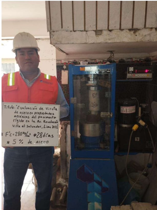
Foto 21: Ensayo de compresión a 14 días, patrón + 15%
