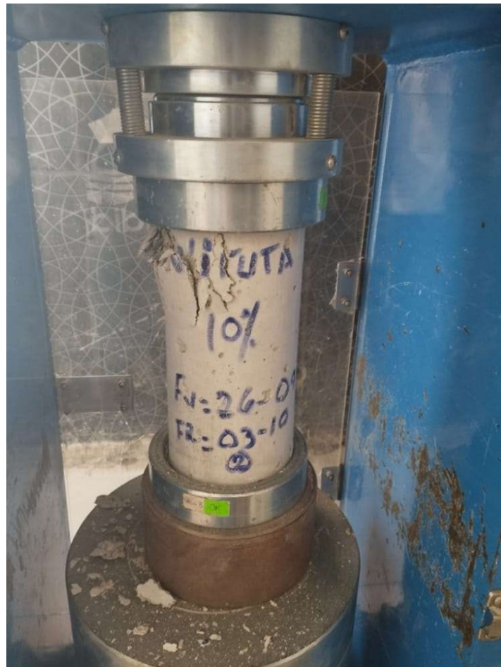
Foto 08: Probeta en ensayo de compresión, patrón + 10%.
