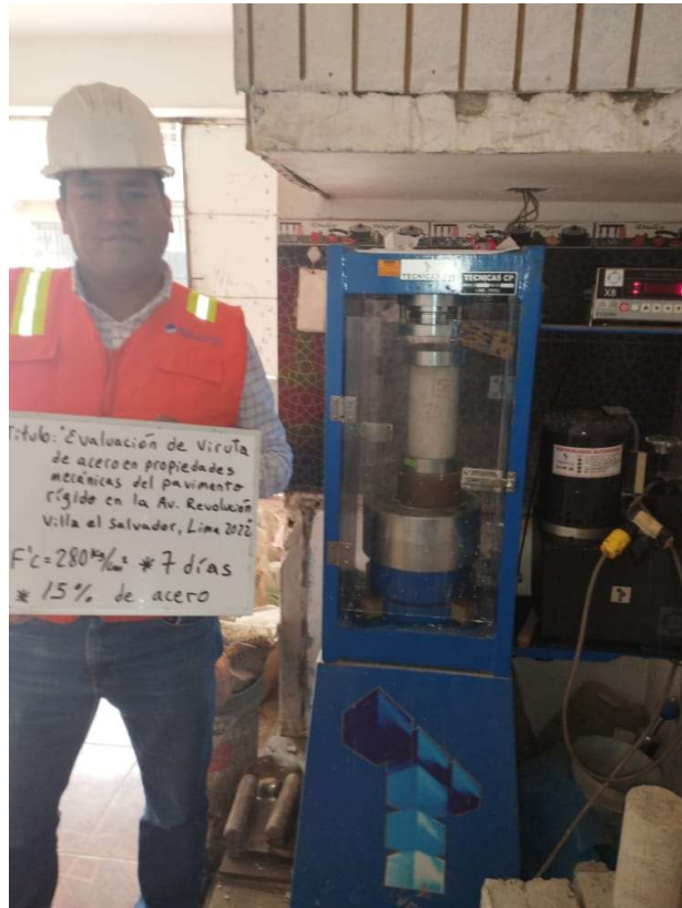
Foto 17: Ensayo de compresión a 7 días, patrón + 15%
