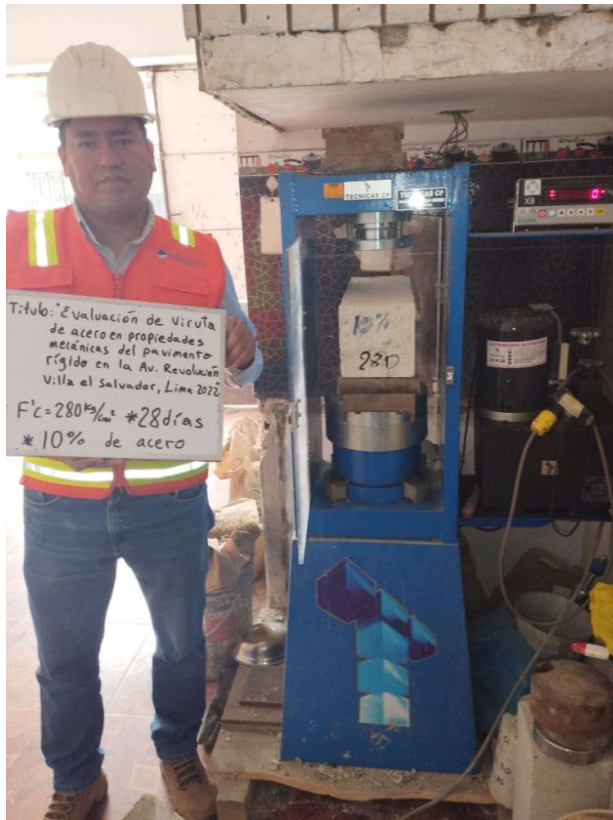
Foto 24: Ensayo de flexión a 28 días, patrón + 10%
