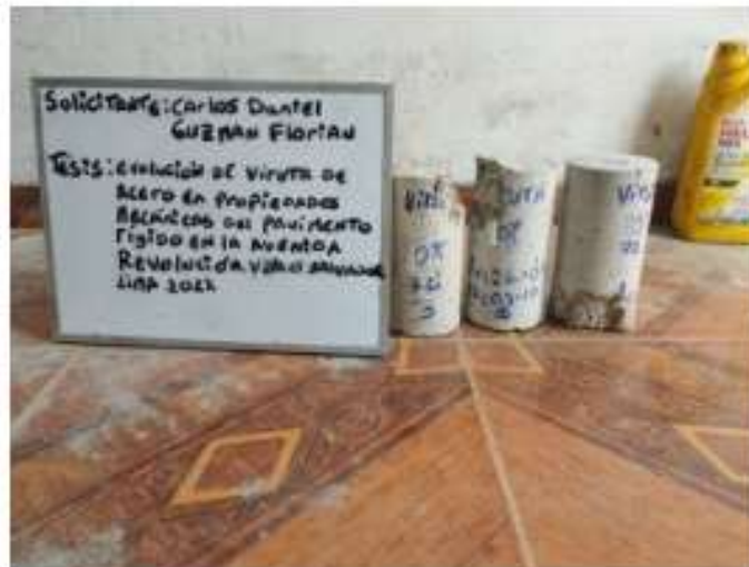
Figura 19: Probetas ensayadas, patrón + 0%, 7 días
