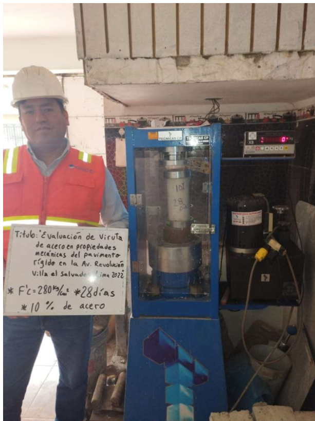
Foto 22: Ensayo de compresión a 28 días, patrón + 10%
