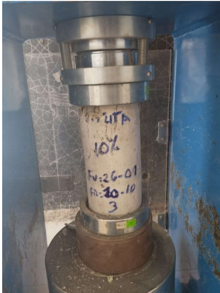
Foto 11: Probeta en ensayo de compresión, patrón + 10%.
