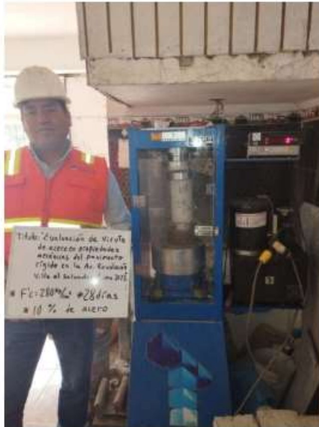
Figura 26: Ensayo de compresión, patrón + 10%, 28 días
