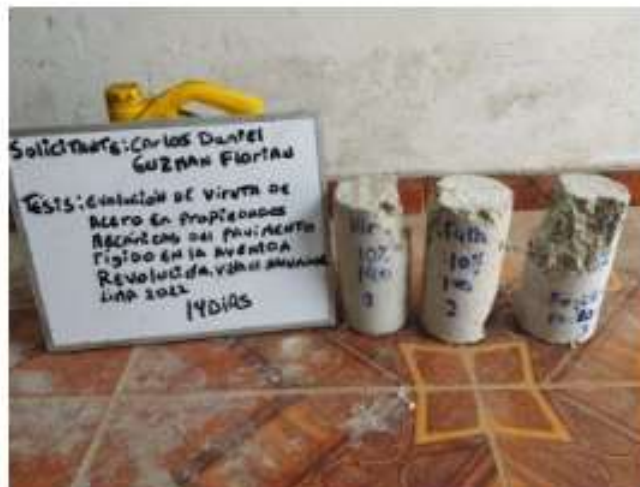
Figura 27: Probetas ensayadas, patrón + 10%, 14 días
