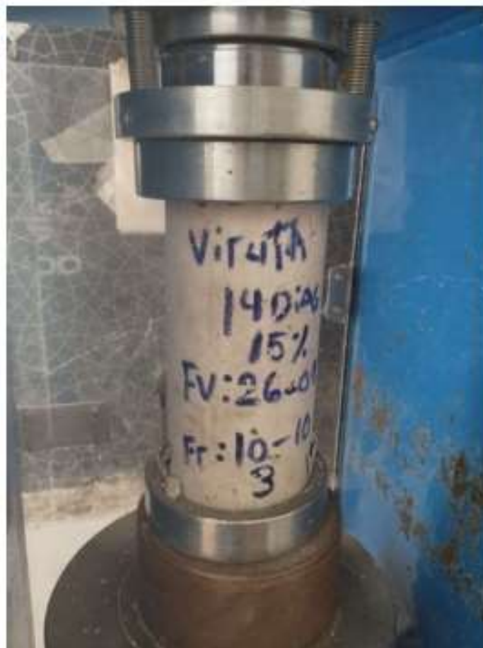
Figura 29: Probetas de ensayo, patrón + 15%, 14 días
