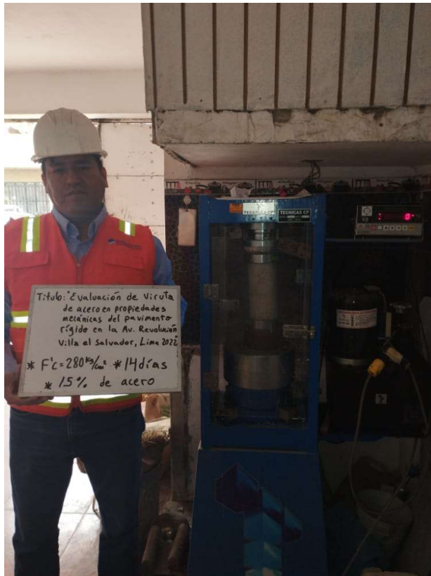
Foto 20: Ensayo de compresión a 14 días, patrón + 15%
