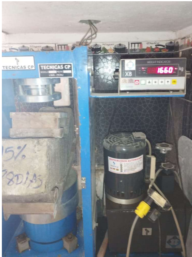
Foto 28: Muestra lista para ensayo a flexión.
