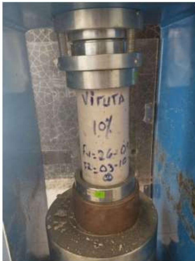
Figura 25: Probetas en ensayo, patrón + 10%, 7 días
