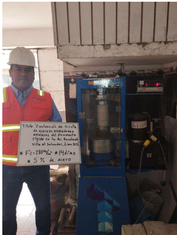
Foto 18: Ensayo de compresión a 14 días, patrón + 5%.
