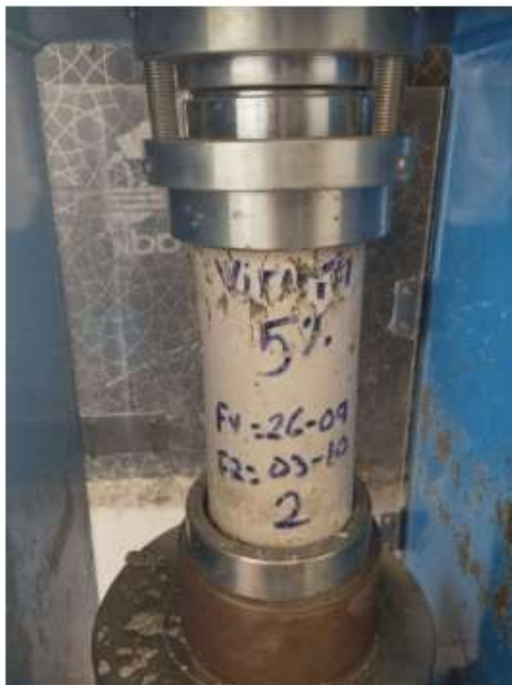
Figura 23: Probetas en ensayo, patrón + 5%, 7 días
