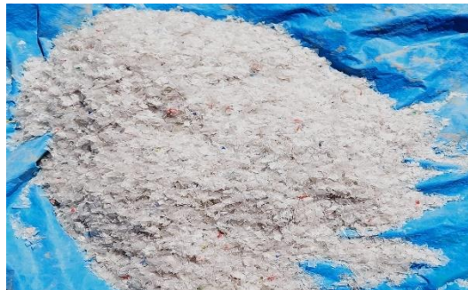
Figura 5. Polietileno tereftalato picado manualmente
