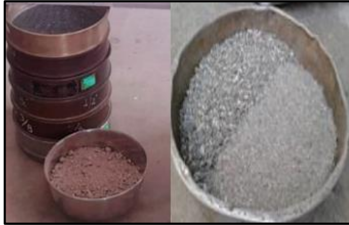
Figura N°10: Material más fino que pasa por el tamiz N°200 del agregado grueso
