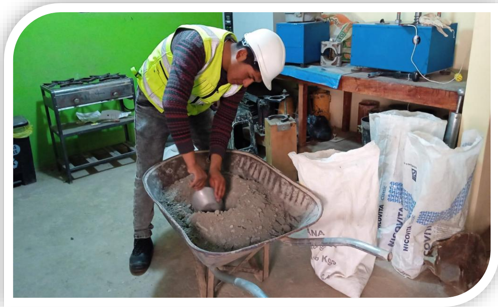
FOTO N° 5: preparación de la mezcla patrón
