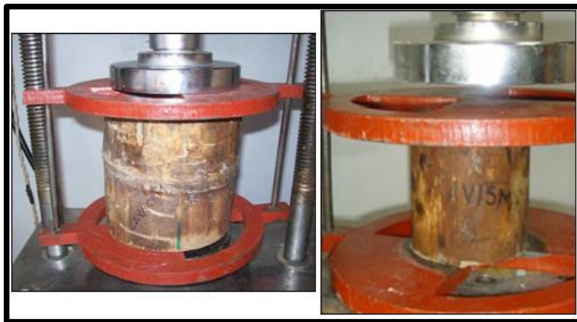
Figura 34. Ensayo de la resistencia al corte con nudo y sin nudo.
