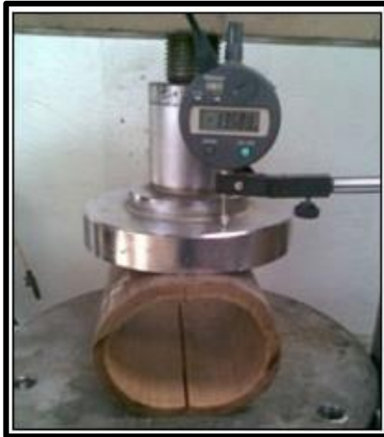
Figura 31. Ensayo a la compresión perpendicular a la fibra.
