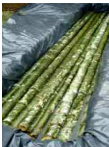
Figura 5. Curado por inmersión ácido bórico, bórax y dicromato de sodio
