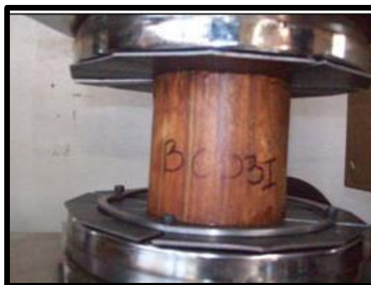
Figura 30. Ensayo a la compresión paralela a la fibra.
