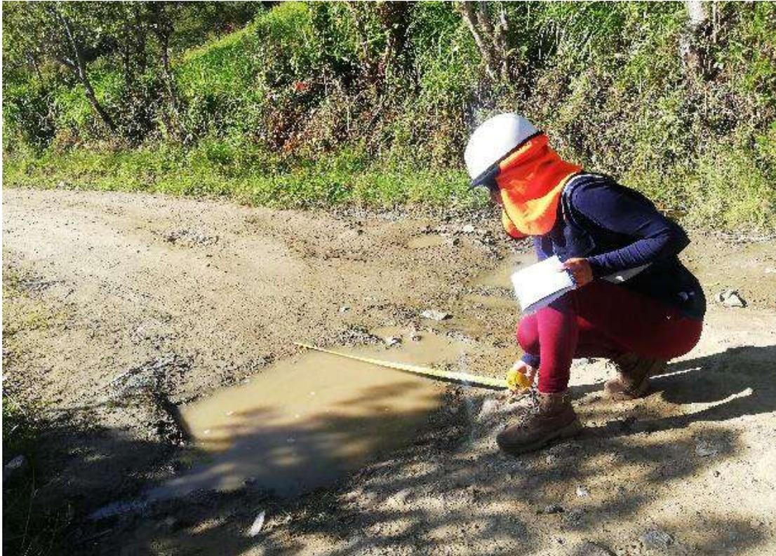
**Figura 19. Daño 4: Encalaminado - Nivel de gravedad 1**
