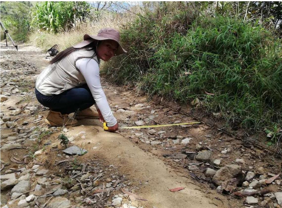
**Figura 14.** Daño 2: Erosión - Nivel de gravedad 1
