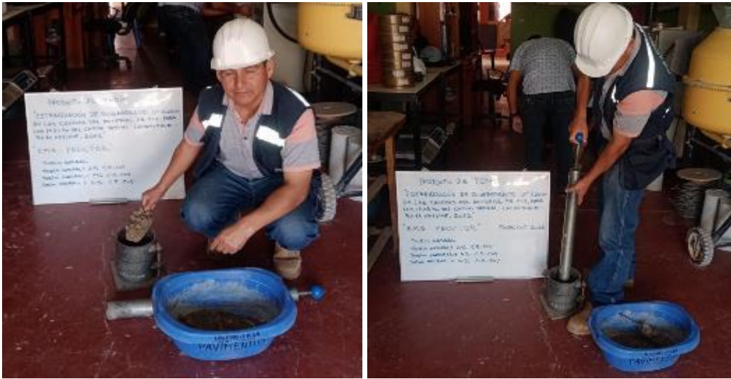
Figura 14: Desarrollo de Ensayo Proctor
