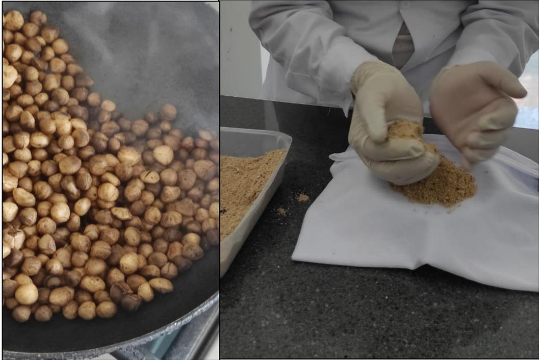
**Imagen N°5:** Secado para extracción de la humedad de la semilla, y proceso de molido con mortero para obtener el polvo del coagulante de Moringa Oleifera
