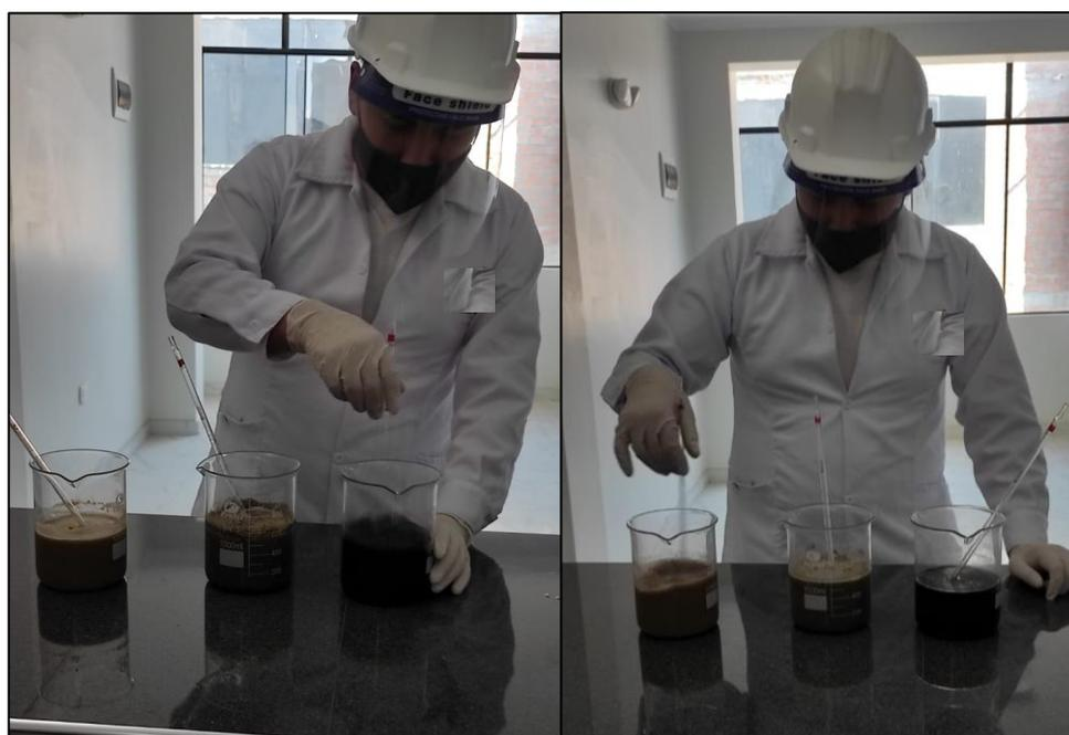
**Imagen N°8:** Vertido de los diferentes tipos de dosis (200 gr) en el lixiviado de 500 mL cada uno, para ser homegenizado a 50 RPM, durante 20 minutos, con el tiempo de sedimentacion de 1 hora.
