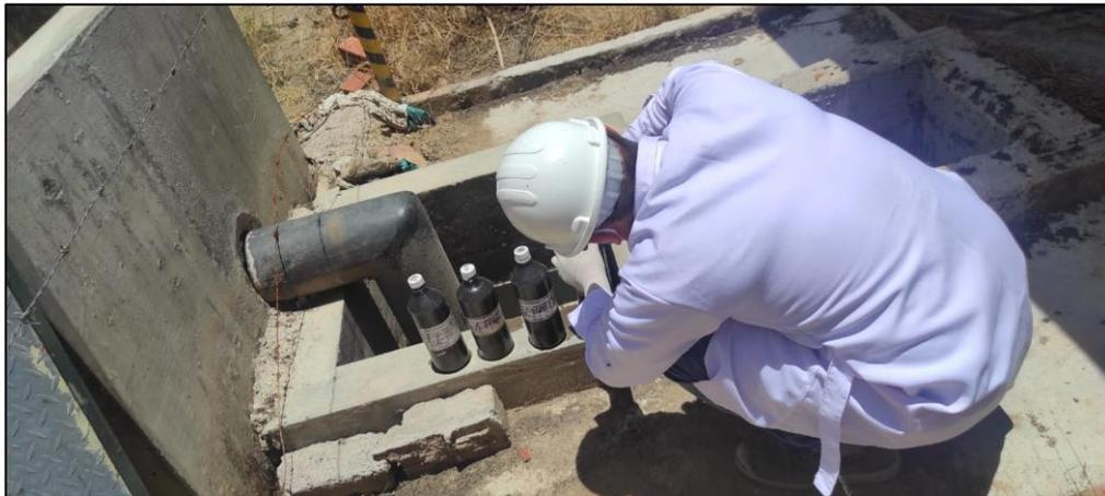
**Imagen N°3:** Toma de muestras del lixiviado, rotulación y resguardo en cooler
