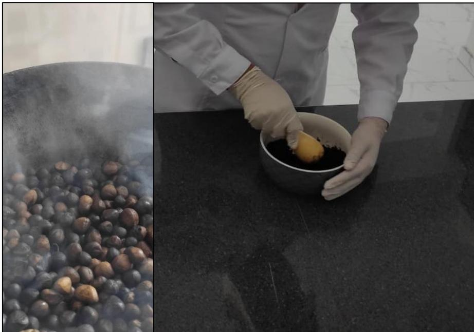
**Imagen N°6:** carbonización de la semilla temperaturas mayores de 100°C, y proceso de molido con mortero para obtener polvo del carbon, lavado con agua destilada para eliminar rastros no deseados, para finalizar ser combinado con limon, para su secado y conversión a carbon activado
