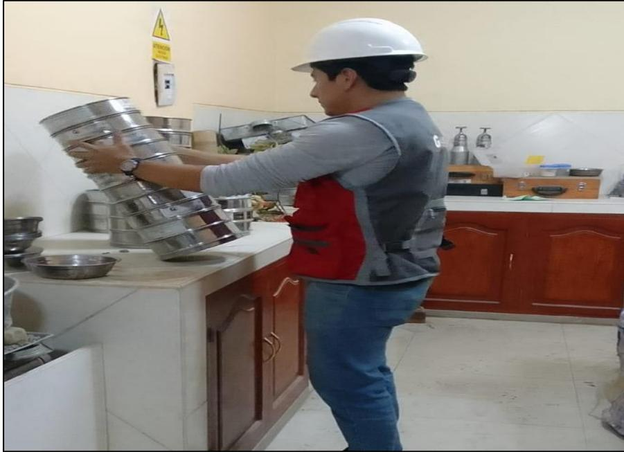
**Figura 27.** Análisis granulométrico por tamizado del agregado grueso.
