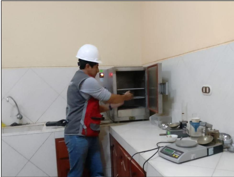
**Figura 29.** Ensayo de contenido de humedad, puesta en horno.
