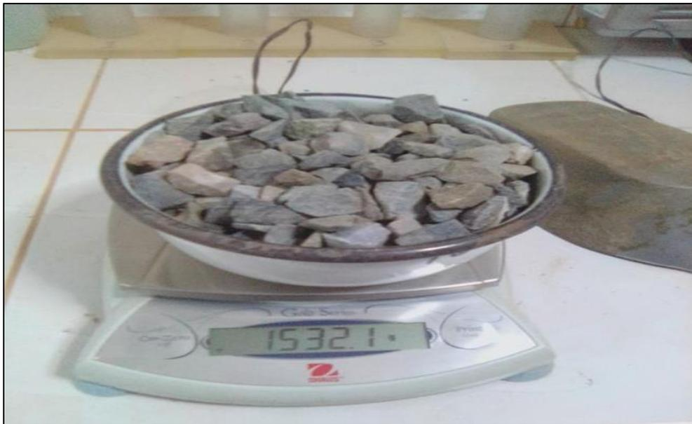
**Figura 36.** Peso de la muestra húmeda del agregado grueso.
