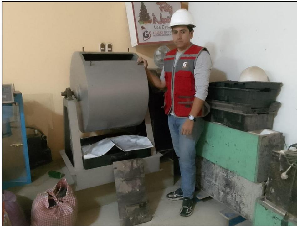
**Figura 40.** Ensayo de abrasión de ángeles
