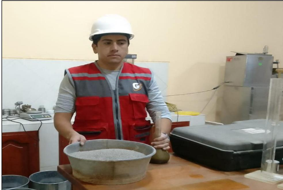
**Figura 35.** Ensayo de peso específico y absorción del agregado fino.
