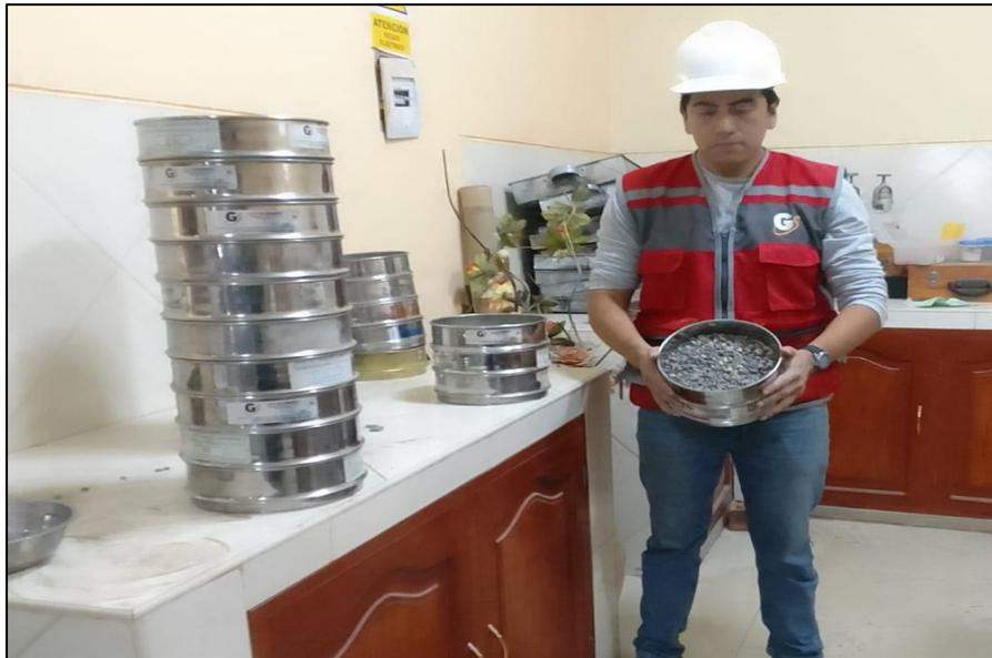
**Figura 28.** Análisis granulométrico por tamizado del agregado fino.
