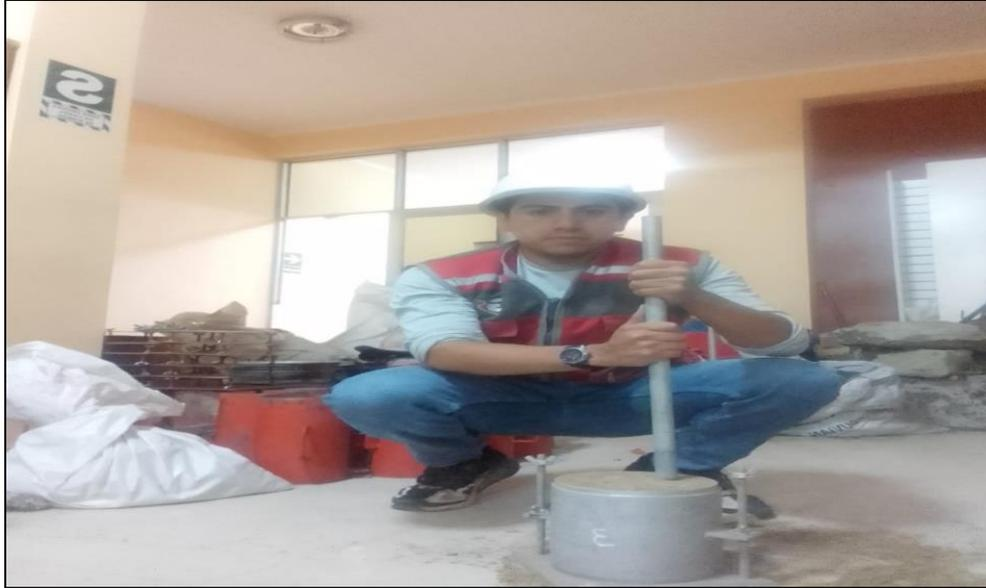
**Figura 33.** Peso unitario compactado del agregado fino
