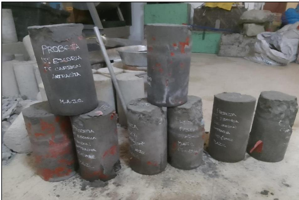
**Figura 50.** Probetas fracturas a los 28 días.
