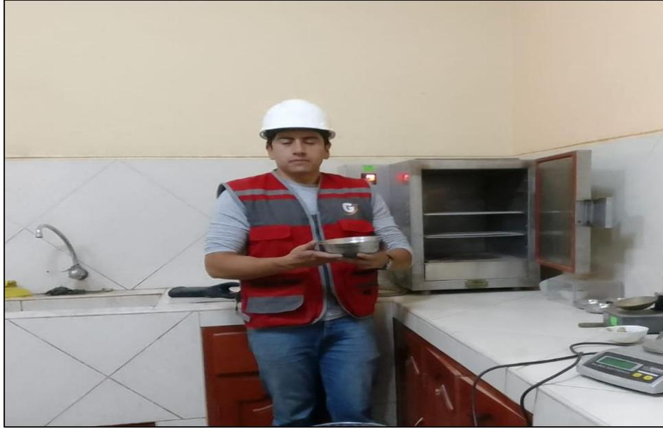
**Figura 37.** Ensayo de peso específico y absorción del agregado grueso.
