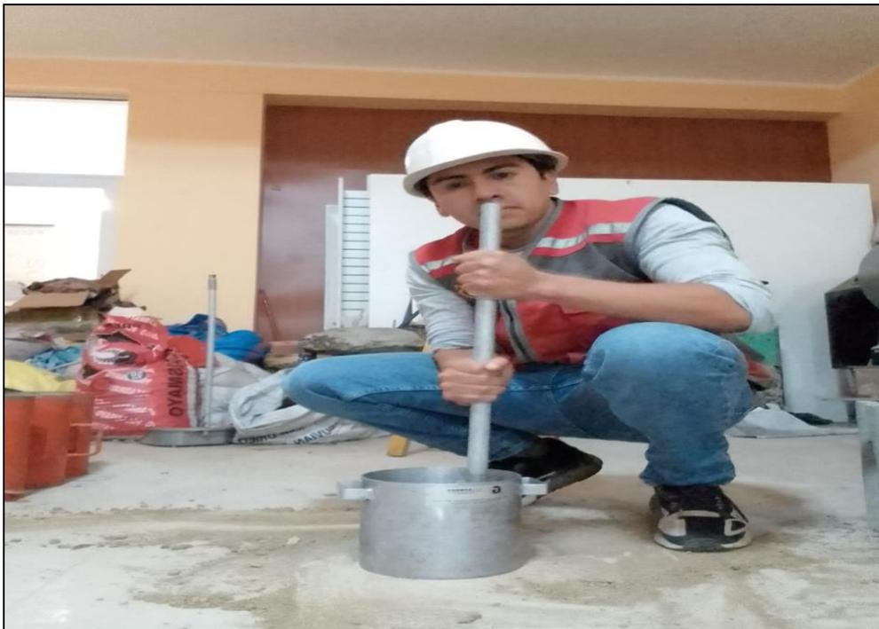
**Figura 32.** Peso unitario compactado del agregado grueso.
