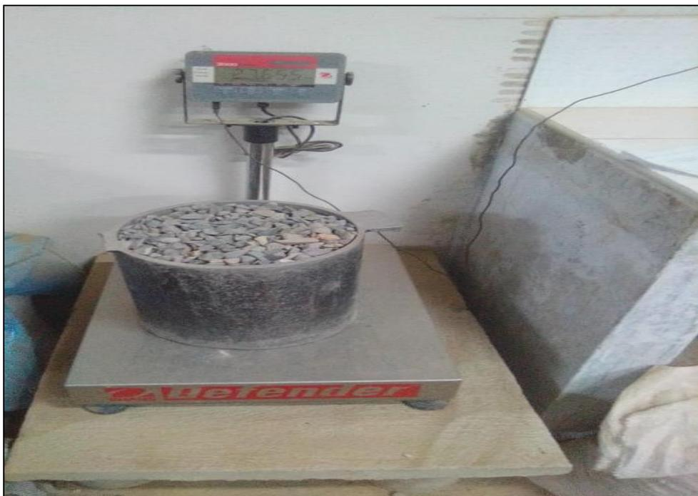
**Figura 30.** Peso unitario suelto del agregado grueso en el recipiente.
