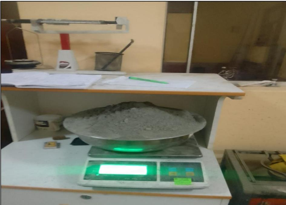
**Figura 44.** Cemento (kg) para concreto, probetas patrón.
