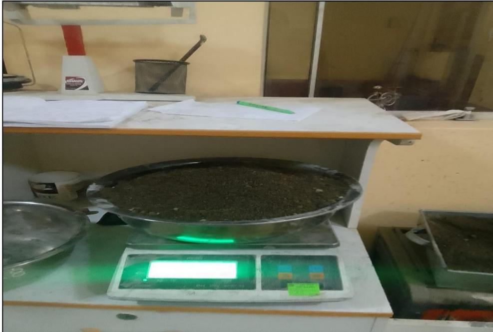
**Figura 45.** Agregado fino (kg) para concreto, probetas patrón.
