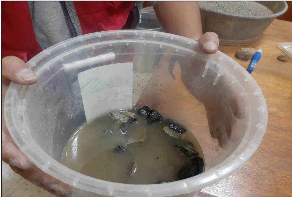
**Figura 38.** Ensayo de resistencia a sulfatos.
