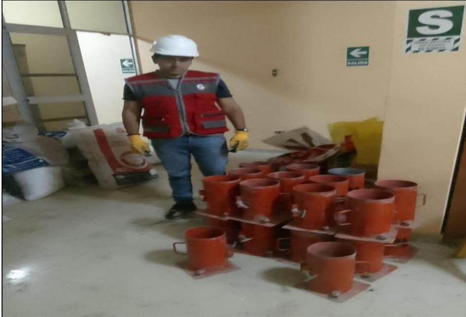
**Figura 43.** Probetas metálicas de 30 cm alto x 15cm de diámetro.
