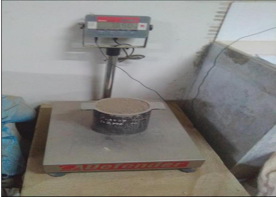
**Figura 31.** Peso unitario suelto del agregado fino en el recipiente.
