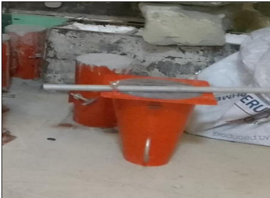
**Figura 42.** Ensayo de trabajabilidad.
