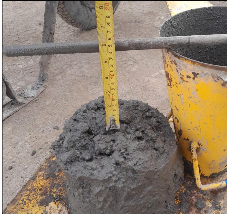
Figura 18. Prueba de Slump
