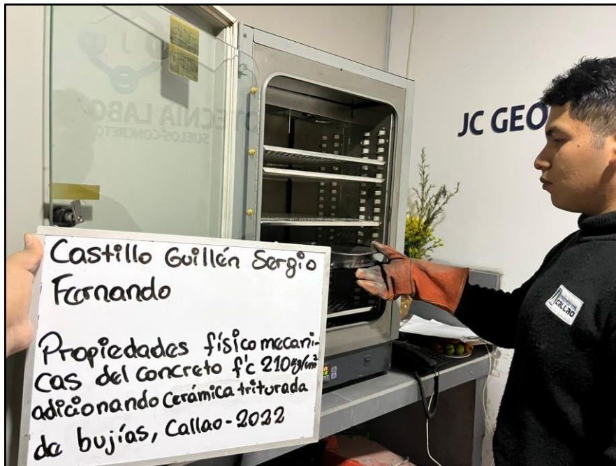
Figura 40. Insertando el agregado al horno
