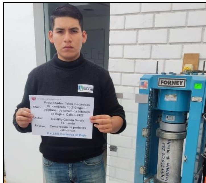
Figura 72. Ensayo de resistencia a compresión a los 28 días de la muestra P+2.5% cerámica de bujía
