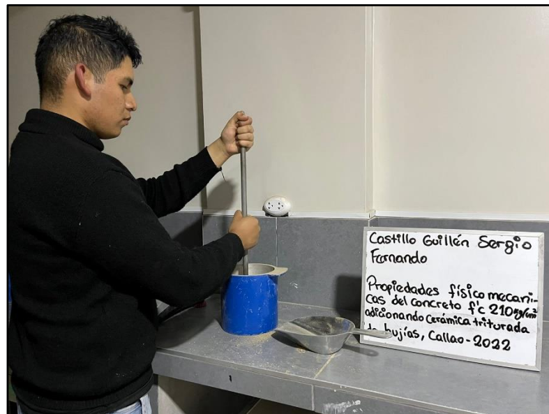
Figura 51. Varillando el agregado fino
