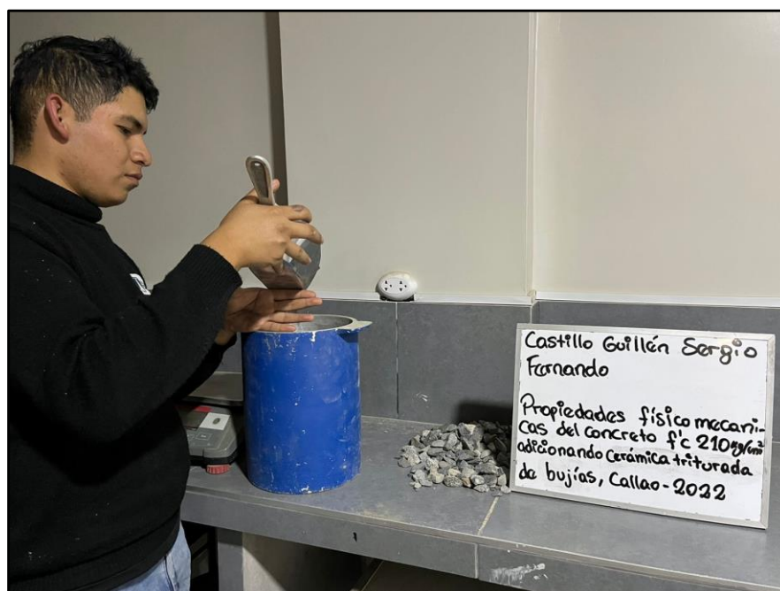
Figura 52. Introduciendo el agregado grueso al cilindro calibrado
