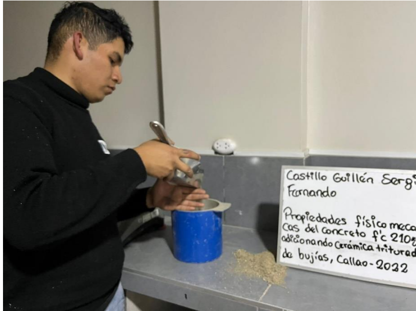
Figura 14. Ensayo de peso unitario del agregado fino
