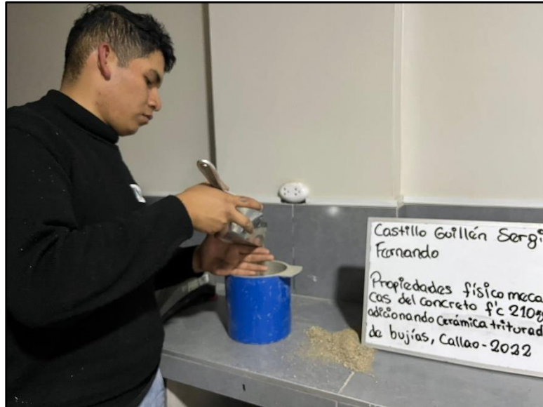
Figura 50. Introduciendo el agregado fino al cilindro calibrado
