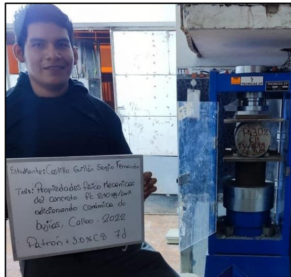
Figura 66. Ensayo de probeta P+3% de CB a los 7 días de madurez
