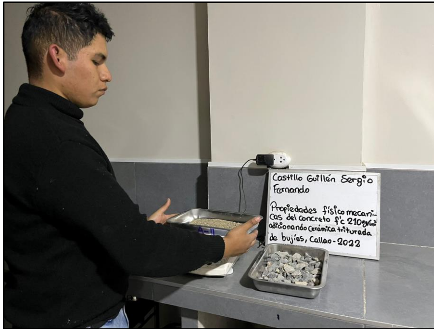
Figura 45. Pesando el agregado fino
