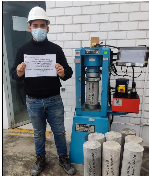
Figura 64. Ensayo de resistencia a compresión a los 7 días de la muestra patrón
