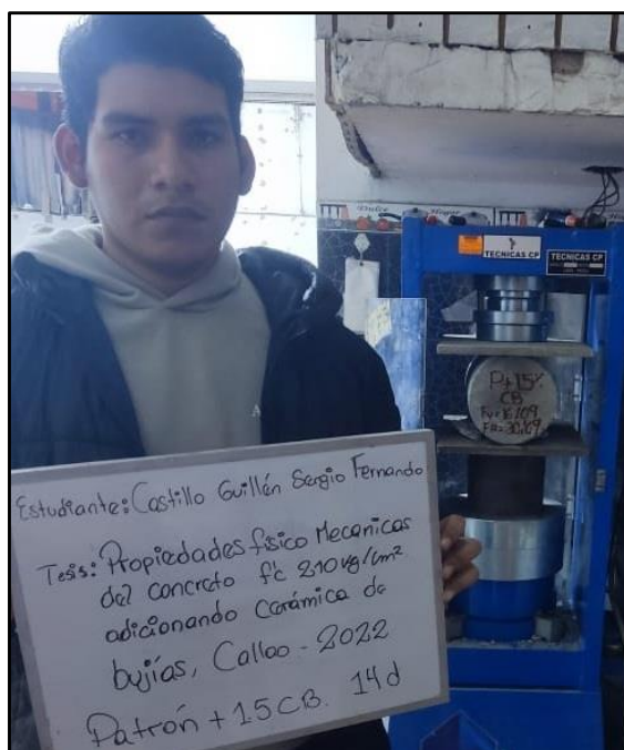
Figura 70. Ensayo de resistencia a tracción de P+1.5%C.B. a los 14 días
