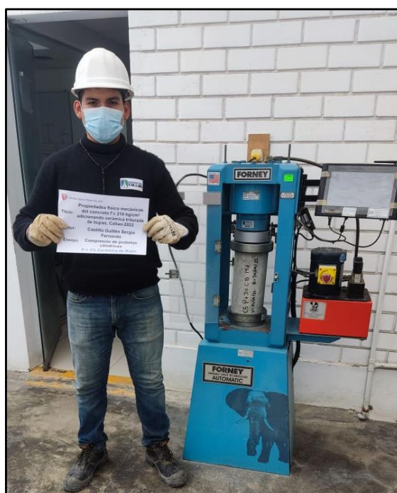
Figura 68. Ensayo de resistencia a compresión a los 14 días de la muestra P+3% cerámica de bujía
