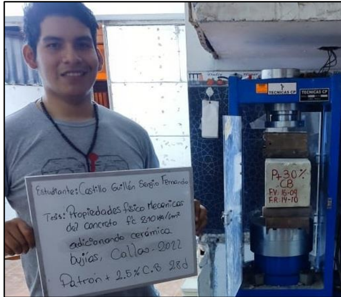
Figura 75. Ensayo de resistencia a flexión a los 28 días de curado de P+2.5% C.B.
