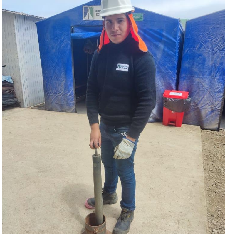
Figura 33. Trituración de la cerámica de bujía con equipo Proctor modificado
