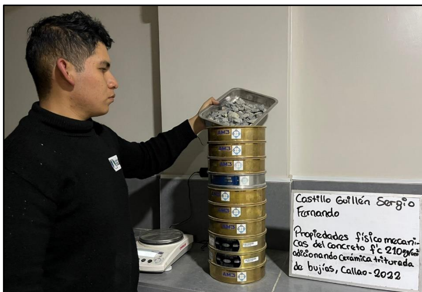
Figura 41. Realizando granulometría del agregado grueso
