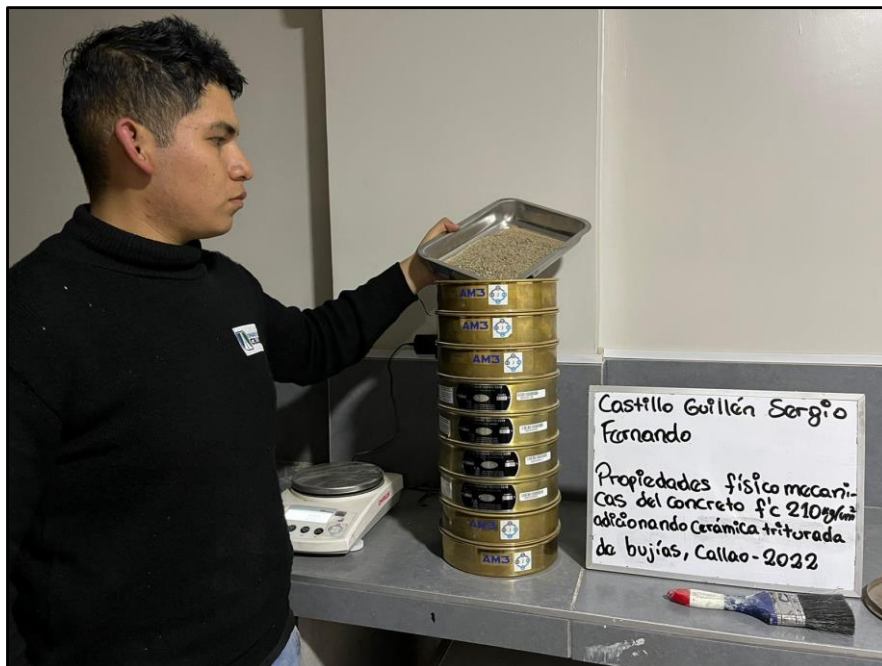
Figura 46. Realizando la granulometría del agregado fino
