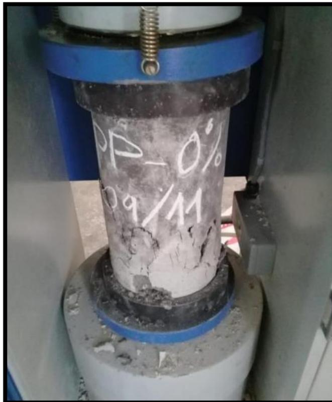
**Rotura de probeta patrón con 0% de agregado reciclado con una falla de tipo 1**
