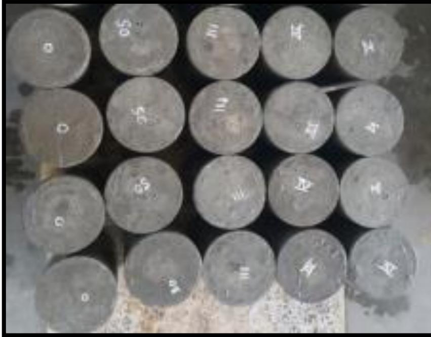
**Probetas antes de la rotura**
