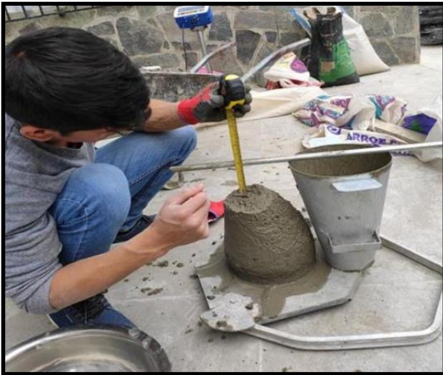
Ensayo de Slump
