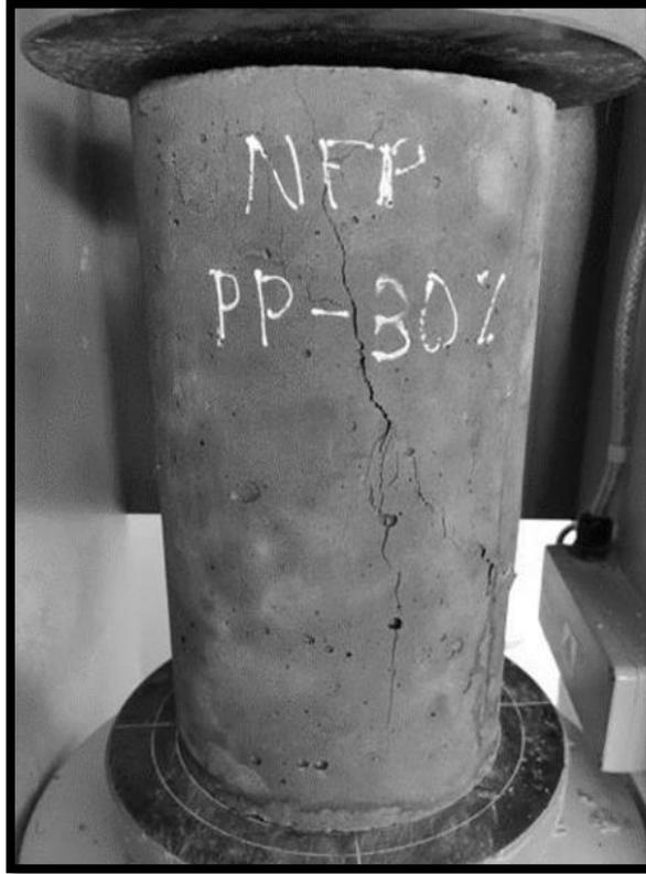
Rotura de probeta patrón con 30% de agregado reciclado con una falla de tipo 1
