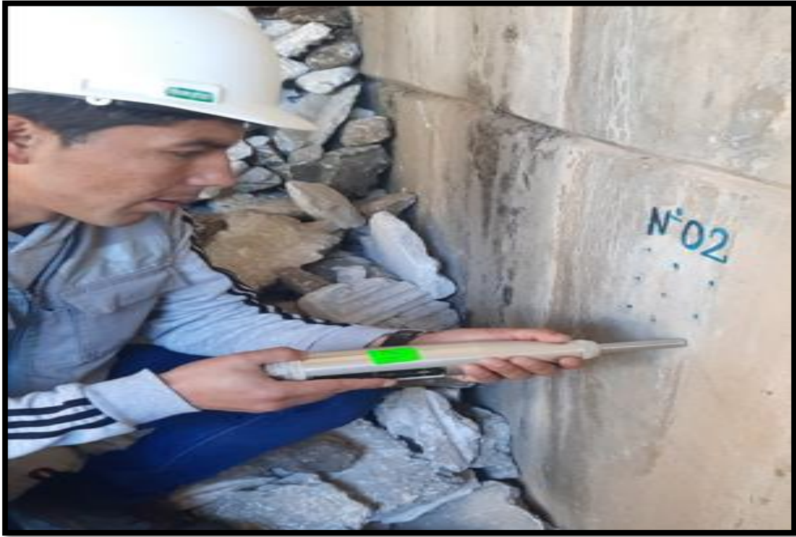
Fotografía 05: ensayo del esclerómetro.
