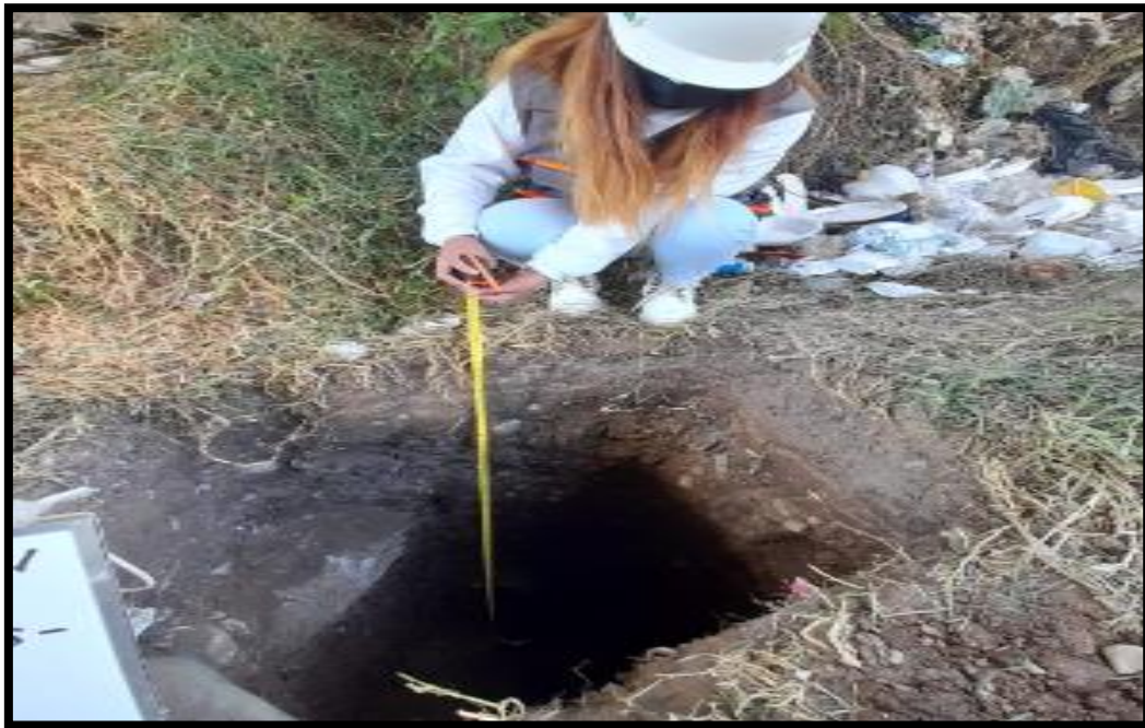
Fotografía 03: Vista de extracción de muestra 02 para el ensayo de suelos.
