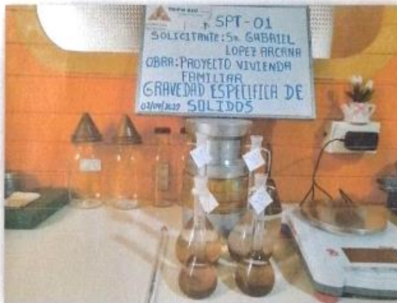
FOTO 06: Ensayo de gravedad específica. ASTM D-854 - NTP 339.131
