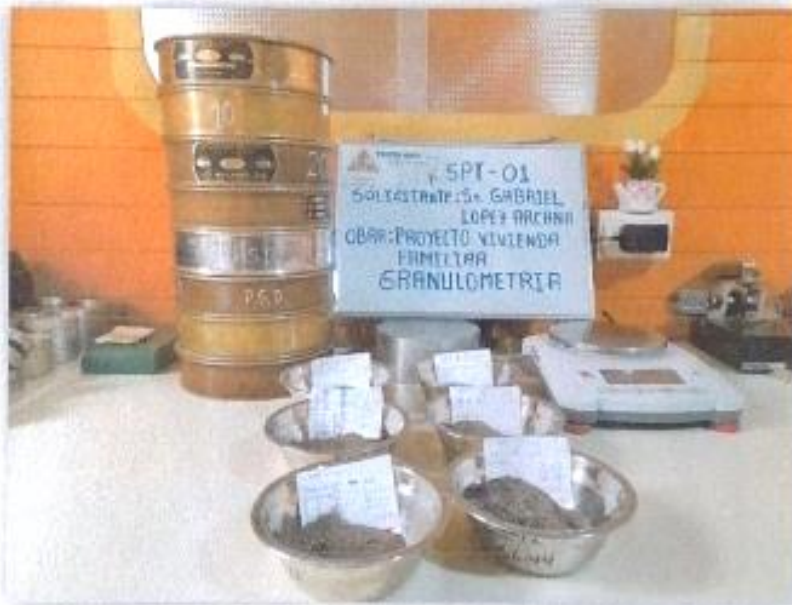
FOTO 04: Ensayo de granulometría. ASTM D422
