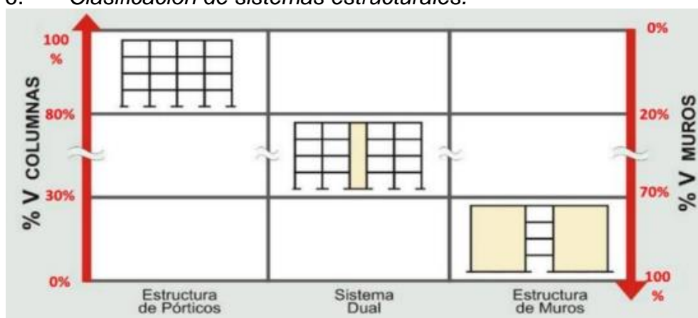
Figura 6. Clasificación de sistemas estructurales.
