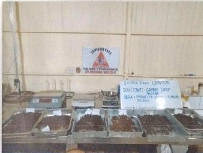
FOTO 03: Secado de muestra para límites de consistencia.
