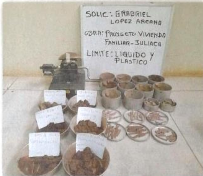
FOTO 05: Ensayo de límites de consistencia. ASTM D-424 D-4318
