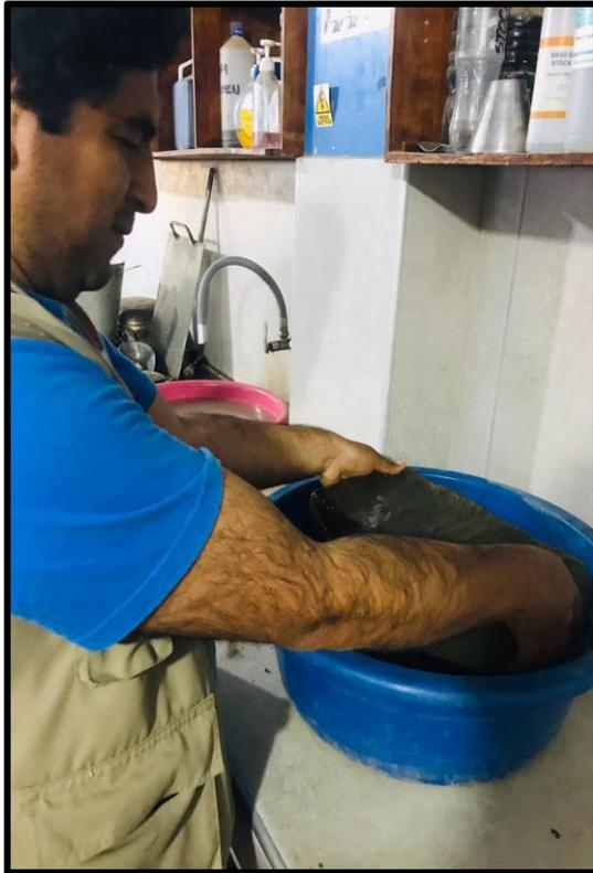
Fotografía: Realizando el ensayo de absorción
