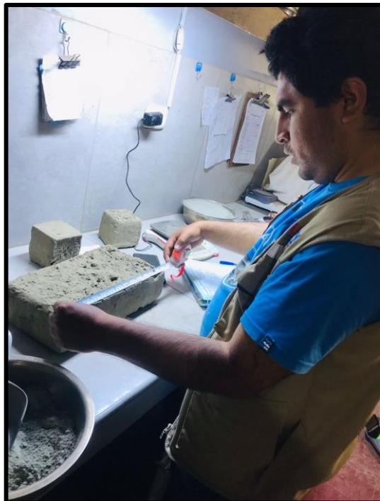
Fotografía: Realizando el ensayo de variación dimensional
