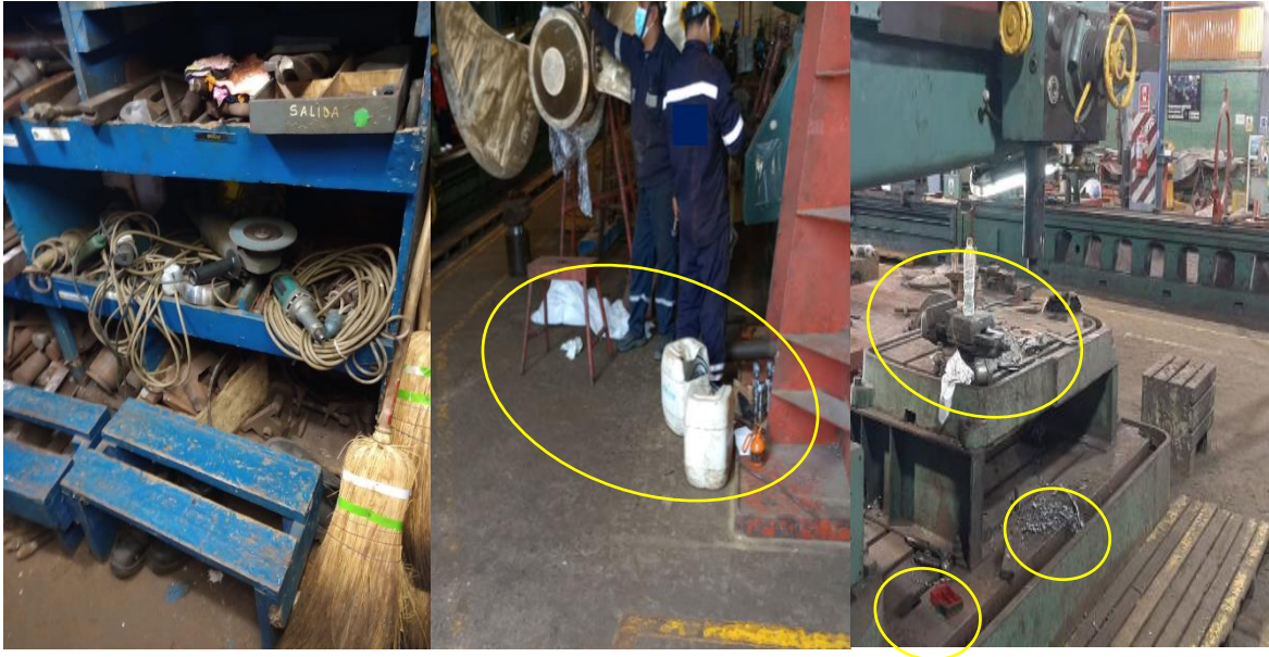
Figura 4. Deficiente orden y limpieza en el área de mantenimiento
