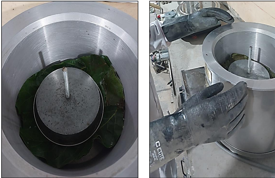
Figura 12: Termo formado de los platos y compactado con disco espaciador.
