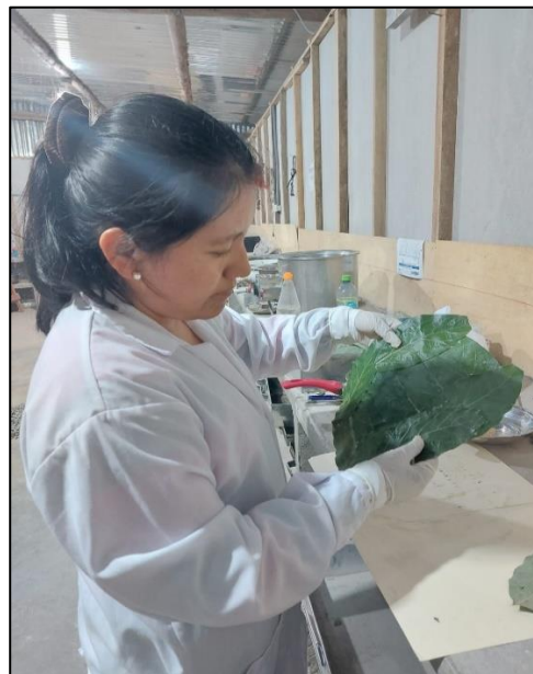
Figura 11: Aplicación del pegamento a las hojas.
