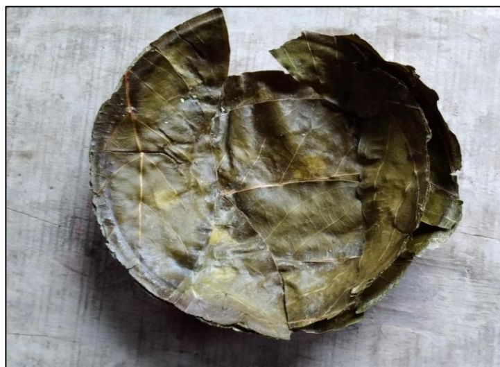
Figura 20: PT-1 degradación de los platos a la intemperie.
