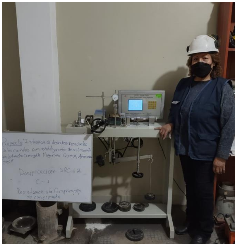
Foto 12 Ensayo de resistencia a la compresión no confinada con 6% de DRC de la muestra N°1
