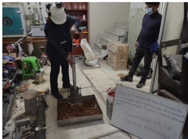
Foto 8 Proctor modificado con 3% DRC
