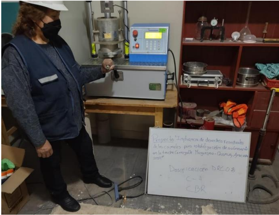
Foto 11 Ensayo de CBR con 0% de DRC de la muestra N°4
