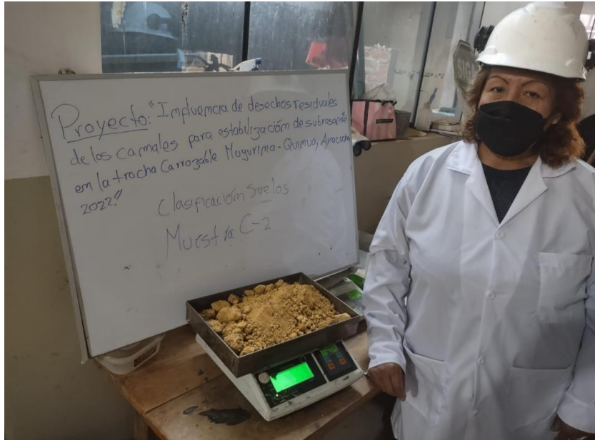
Foto 5 Peso de la muestra N°2 para clasificación de suelos
