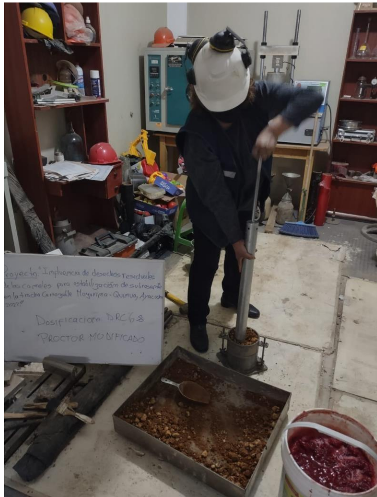
Foto 7 Proctor modificado con 6% DRC
