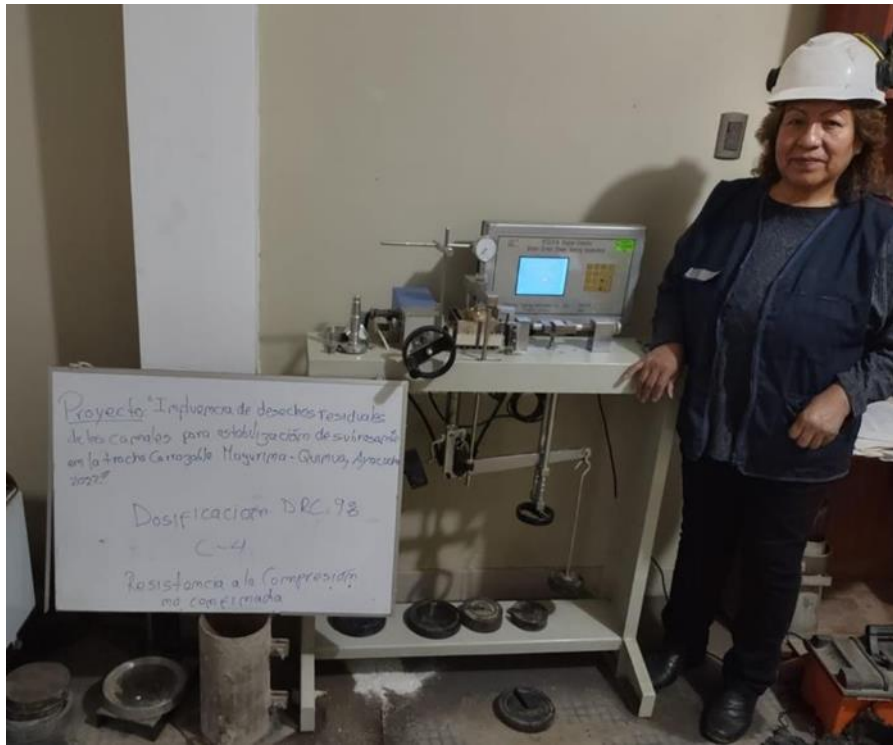
Foto 13 Ensayo de resistencia a la compresión no confinada con 9% de DRC de la muestra N°4
