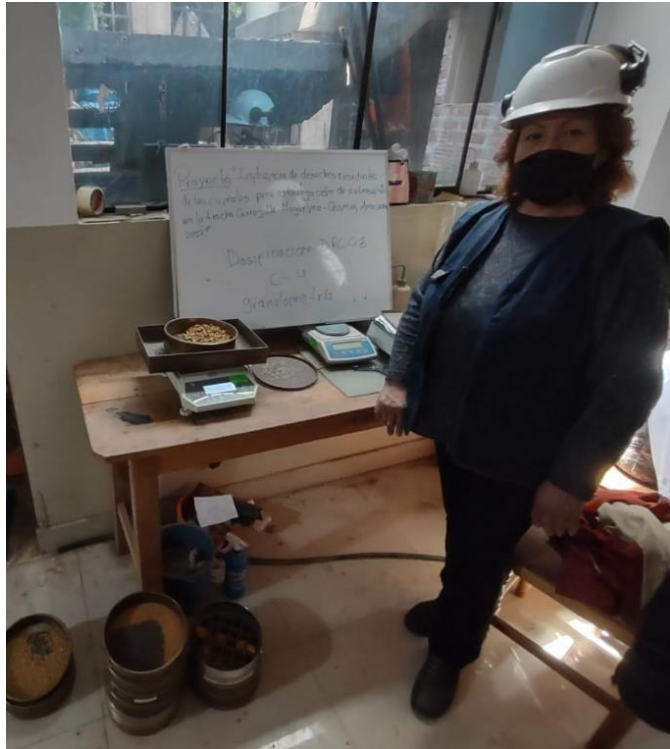
Foto 3 Peso de los tamices de la granulometría muestra N°4
