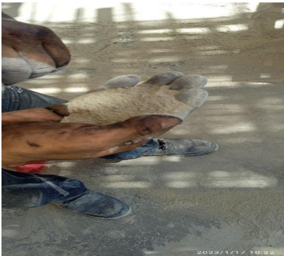
FIGURA 11: OBTENCIÓN DE LA DIATOMITA A GRANULACIÓN DE 4 MM
