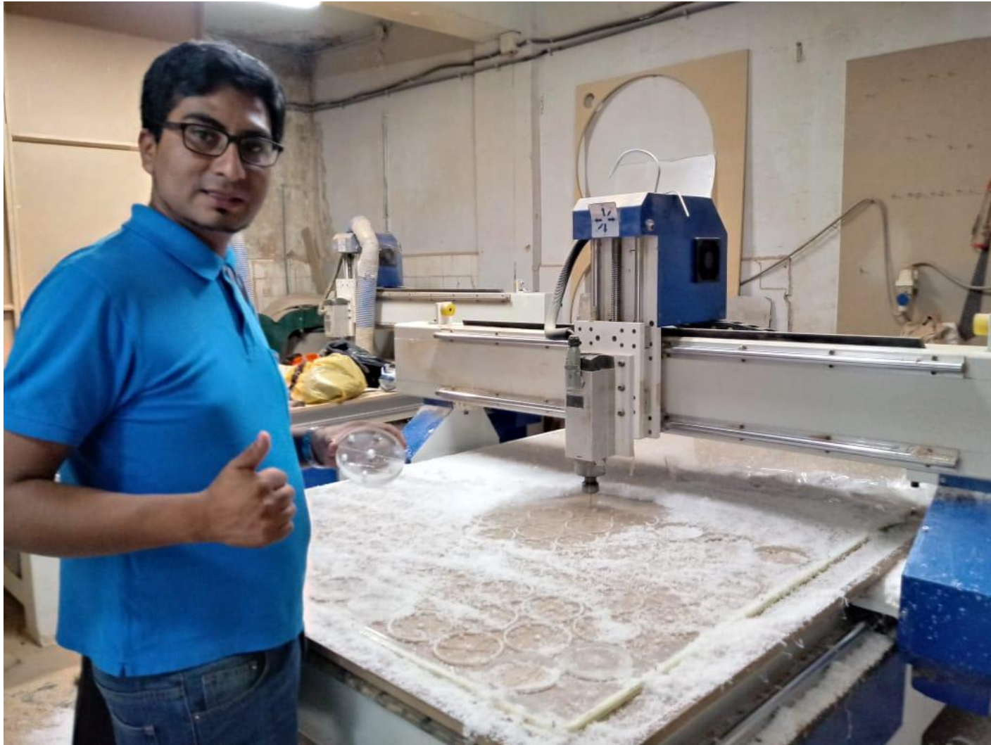
Anexo 19: Evidencia visual. Corte de placas de acrílico
