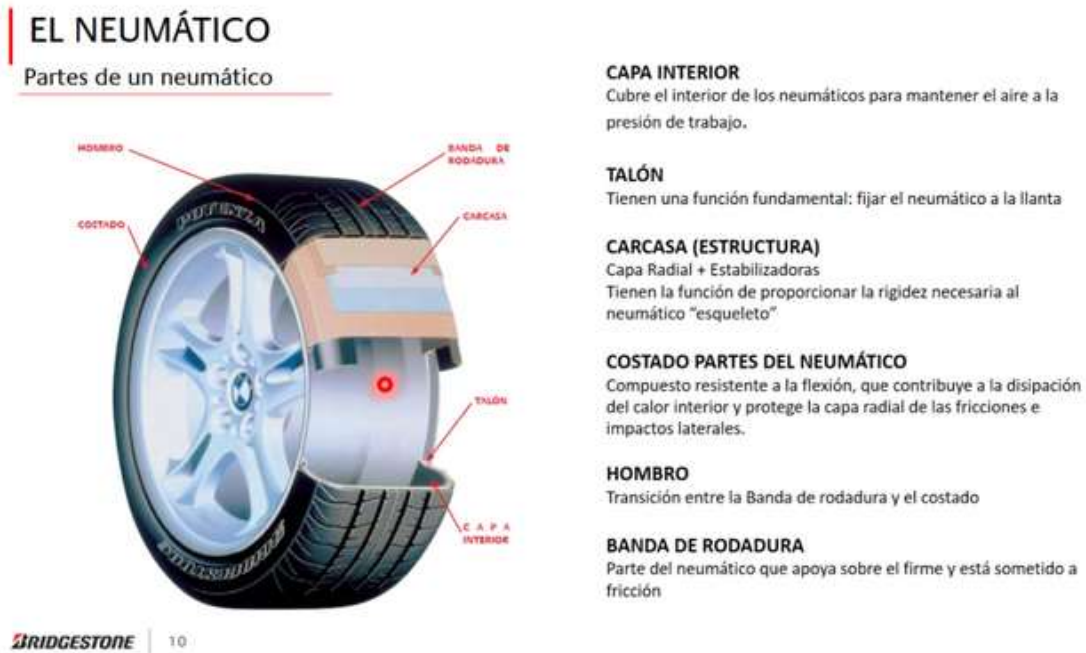
Figura 2: Partes del neumático (números agregados por el investigador)
