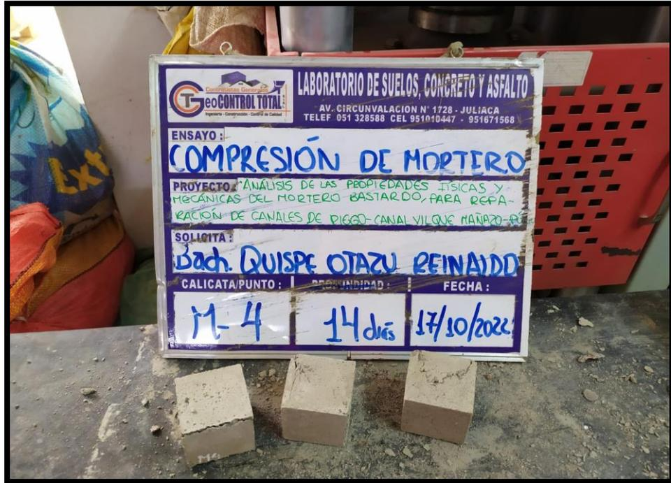
Fotografía N°23 Resistencia a la compresión a los 14 días
