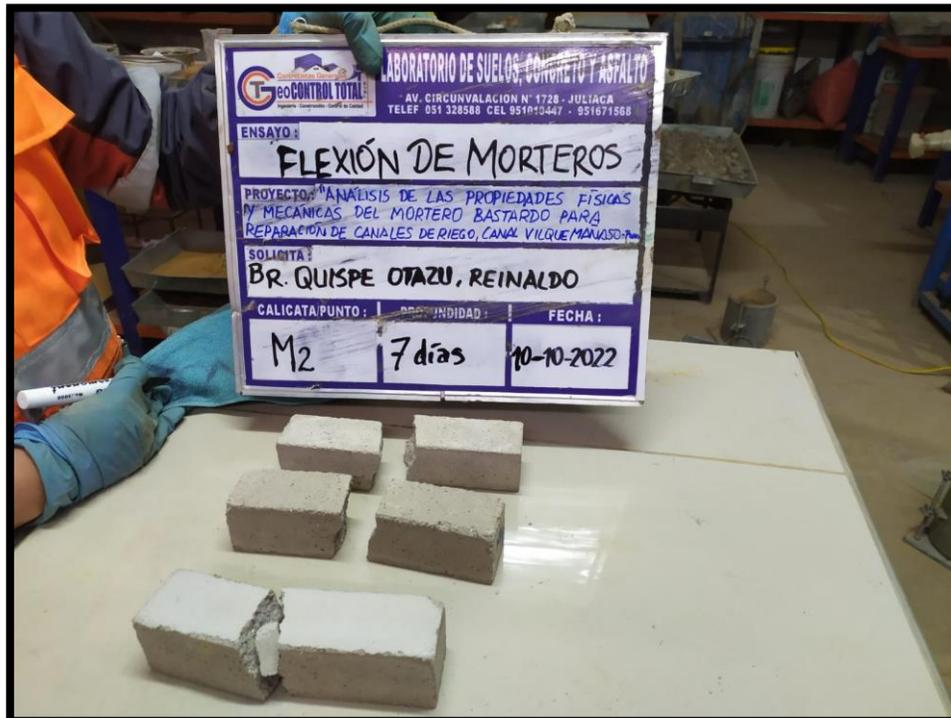
Fotografía N°32 Muestra una vez realizado el ensayo de resistencia a la flexión
