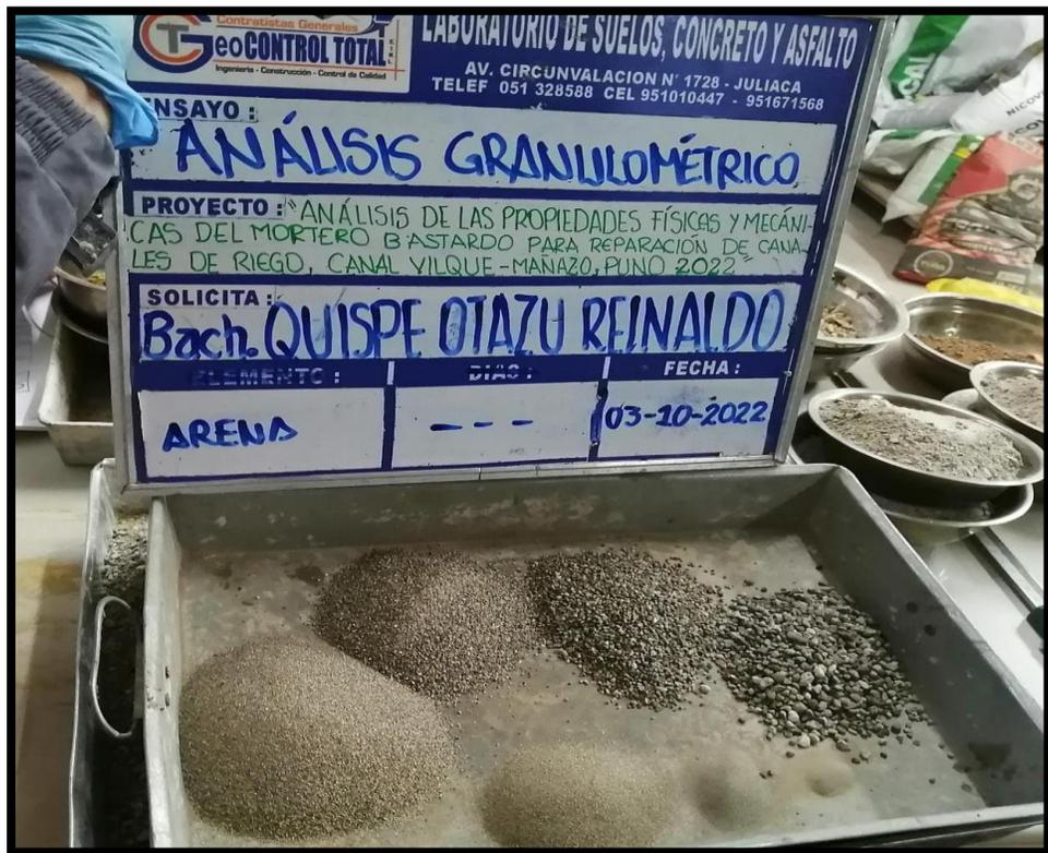
Fotografía N°8 Ensayo de granulometría del agregado fino
