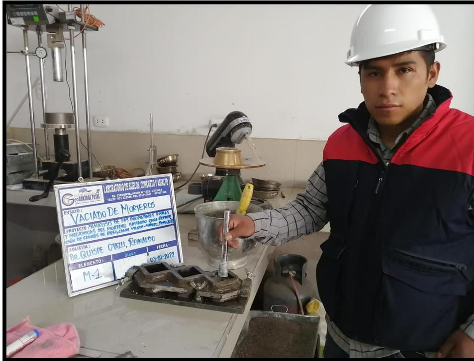
Fotografía N°19 Vaciado de moldes para el ensayo de resistencia a la compresión
