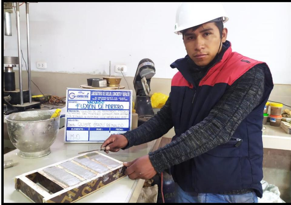
Fotografía N°29 Vaciado de muestras para el ensayo de resistencia a la flexión
