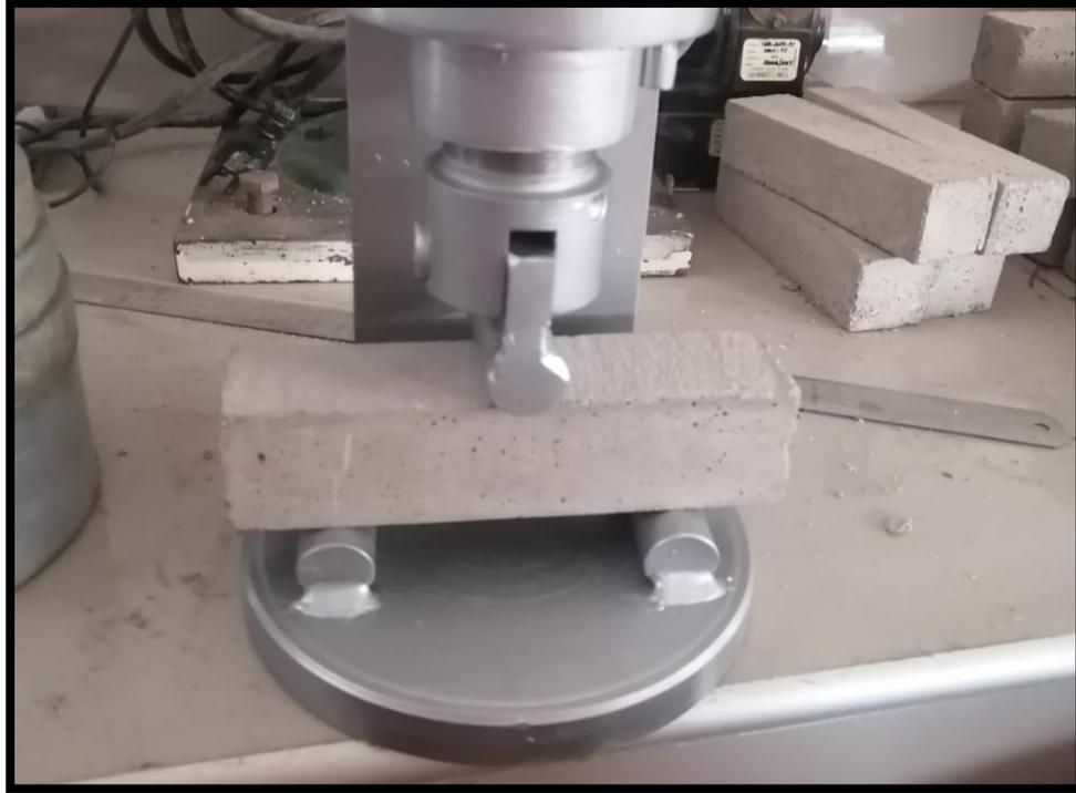
Fotografía N°37 Muestra puesta para el ensayo de la resistencia a la flexión
