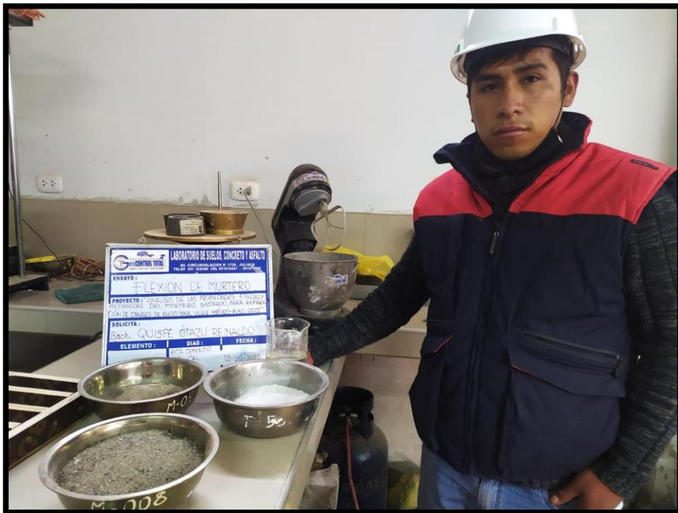
Fotografía N°28 Dosificación para el vaciado para las muestras del ensayo de resistencia a la flexión
