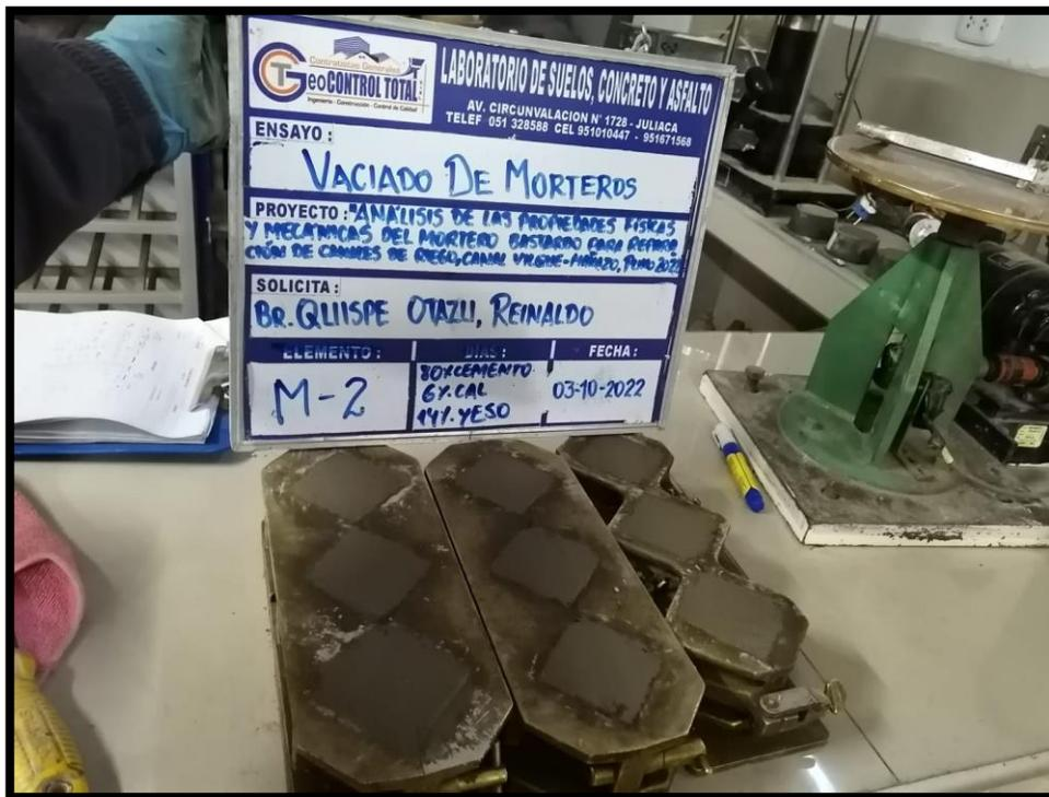
Fotografía N°20 Moldes vaciados para el ensayo de resistencia a la compresión
