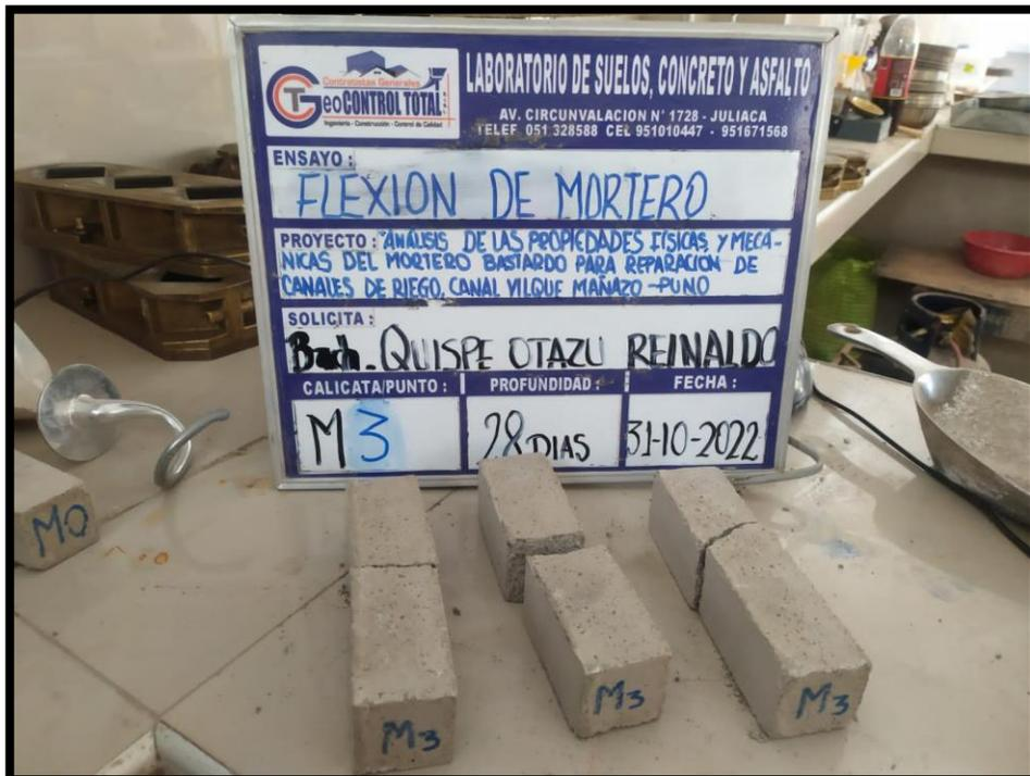
Fotografía N°36 Muestra una vez realizado el ensayo de resistencia a la flexión
