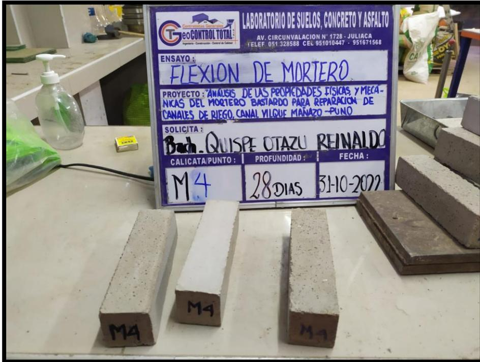
Fotografía N°35 Muestras para el ensayo a los 28 días
