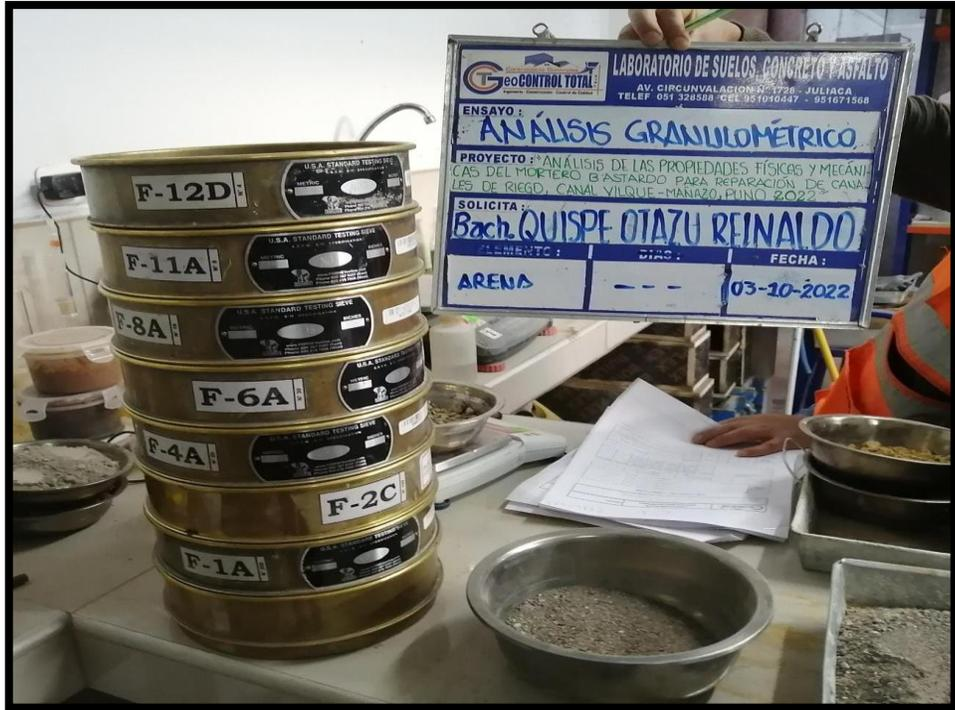
Fotografía N°7 Ensayo de granulometría del agregado fino
