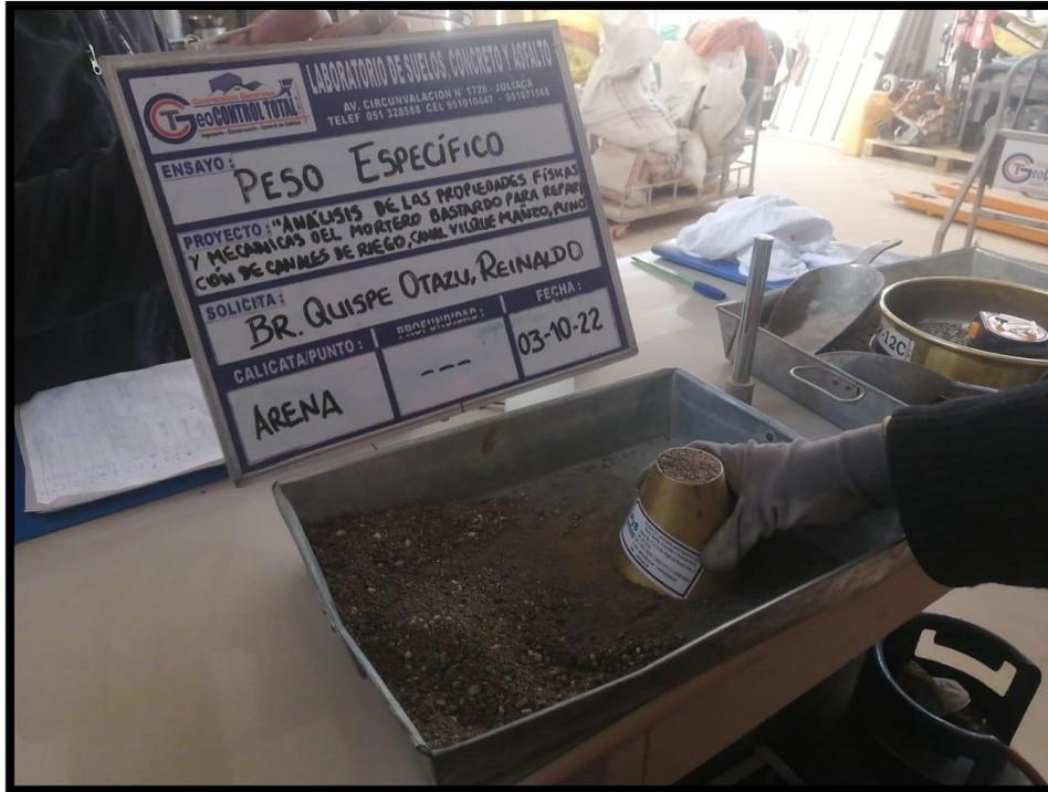
Fotografía N°3 Ensayo del peso específico del agregado fino
