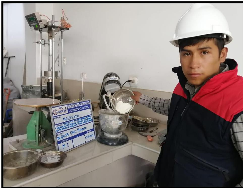
Fotografía N°10 Mezclado de los componentes del mortero bastardo
