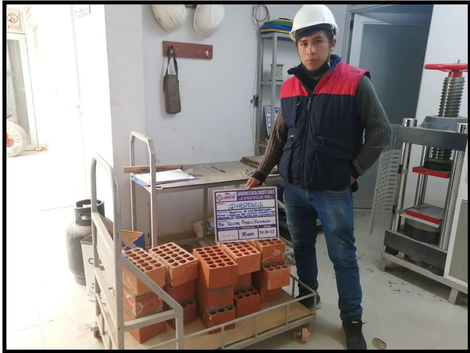
Fotografía N°15 Muestras para el ensayo de adherencia a los 28 días
