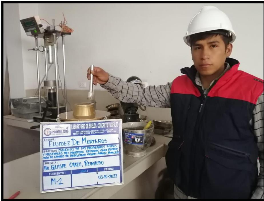
Fotografía N°11 Ensayo de fluidez del mortero bastardo
