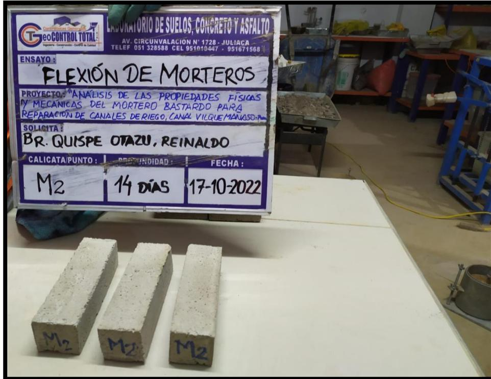
Fotografía N°33 Muestra para el ensayo a los 14 días
