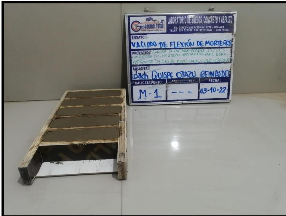
Fotografía N°30 Muestras vaciadas para el ensayo de resistencia a la flexión
