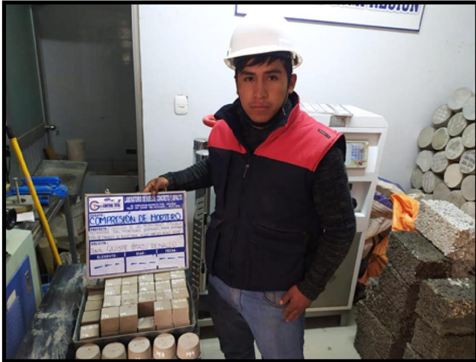
Fotografía N°21 Cubos de las diferentes muestras del mortero bastardo
