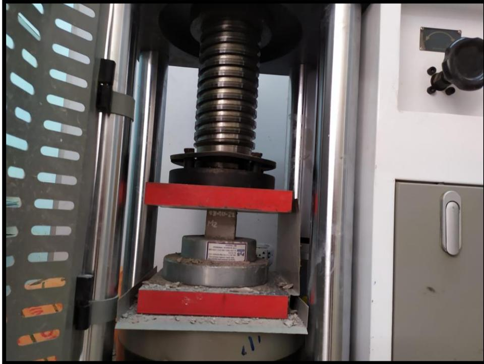
Fotografía N°27 Ensayo de la resistencia a la compresión del mortero bastardo
