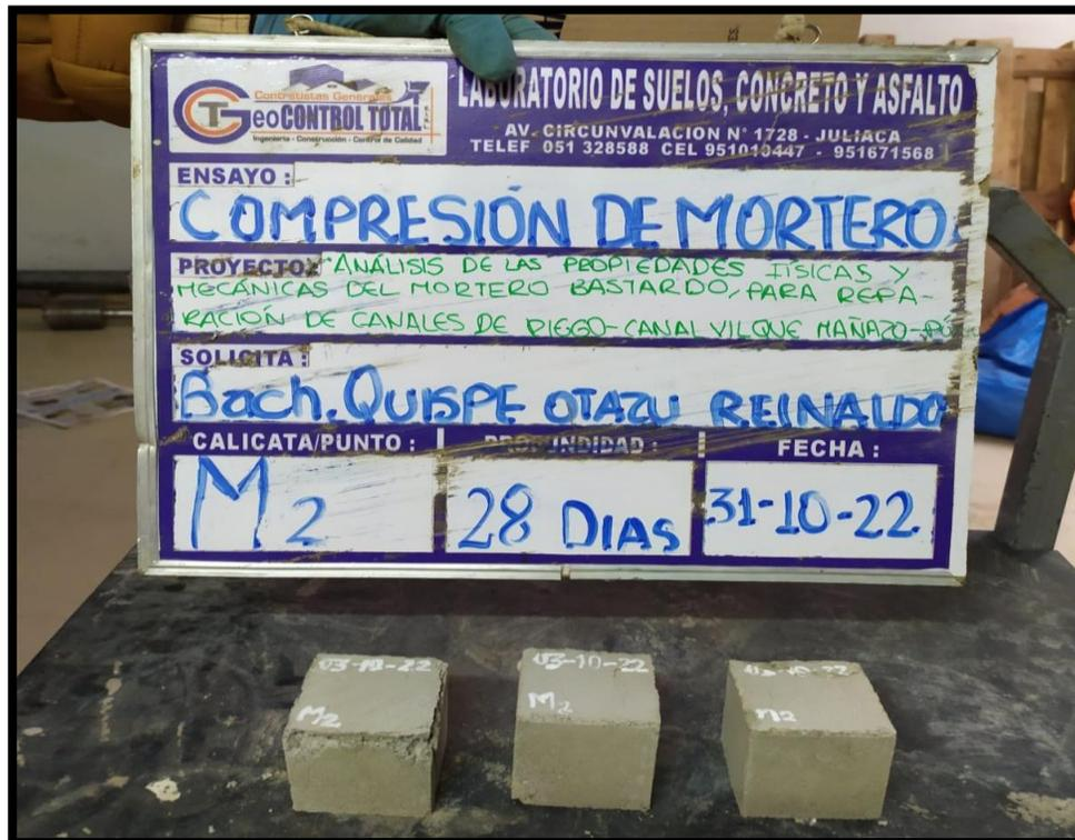
Fotografía N°24 Resistencia a la compresión a los 28 días
