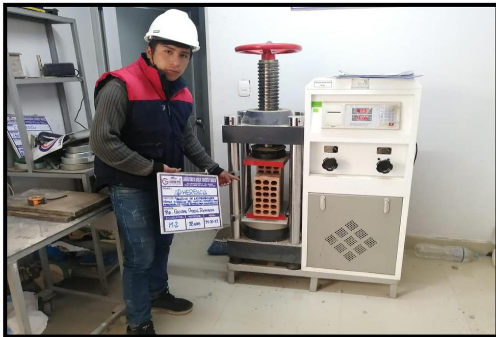
Fotografía N°16 Rotura para obtener el valor de adherencia del mortero bastardo
