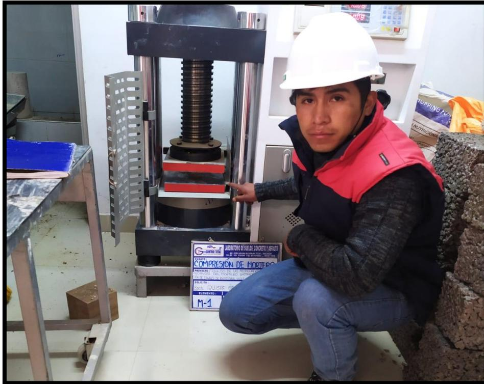
Fotografía N°25 Ensayo de la resistencia a la compresión del mortero bastardo
