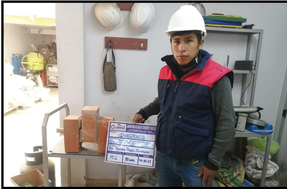
Fotografía N°17 Monde una vez ya alcanzo su última resistencia al ensayo de adherencia
