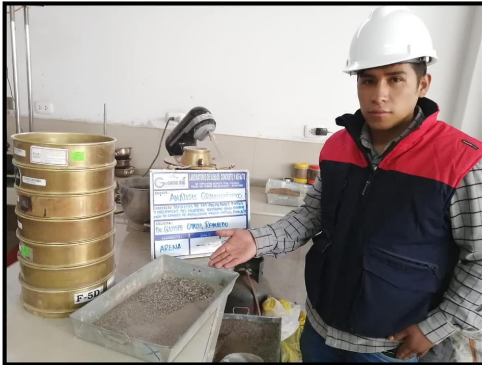
Fotografía N°6 Ensayo de granulometría del agregado fino
