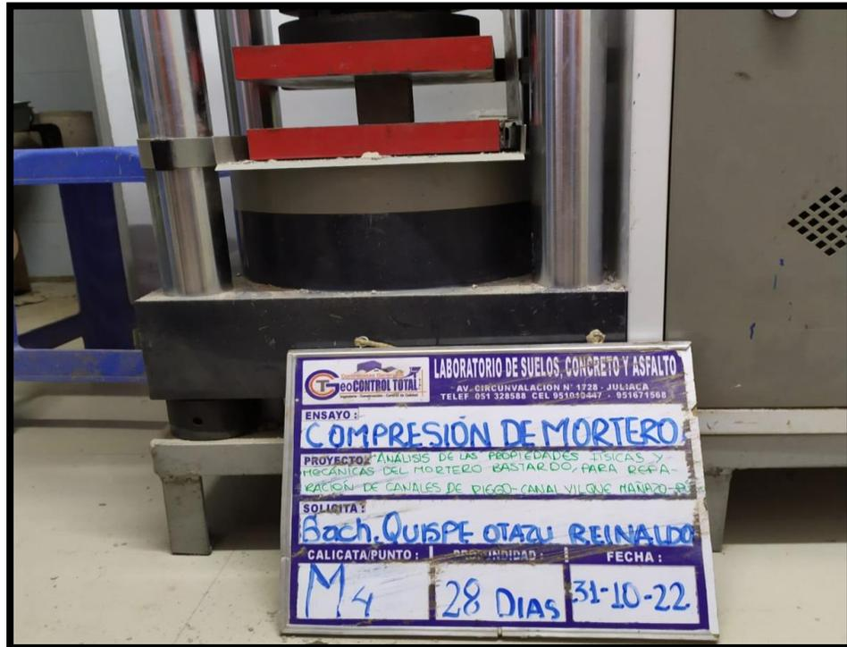
Fotografía N°26 Ensayo de la resistencia a la compresión del mortero bastardo
