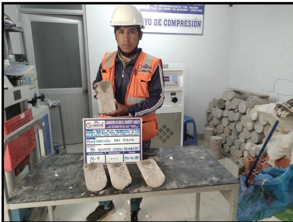
Fotografía N°14 Rotura de las briguetas para medir la penetración del agua
