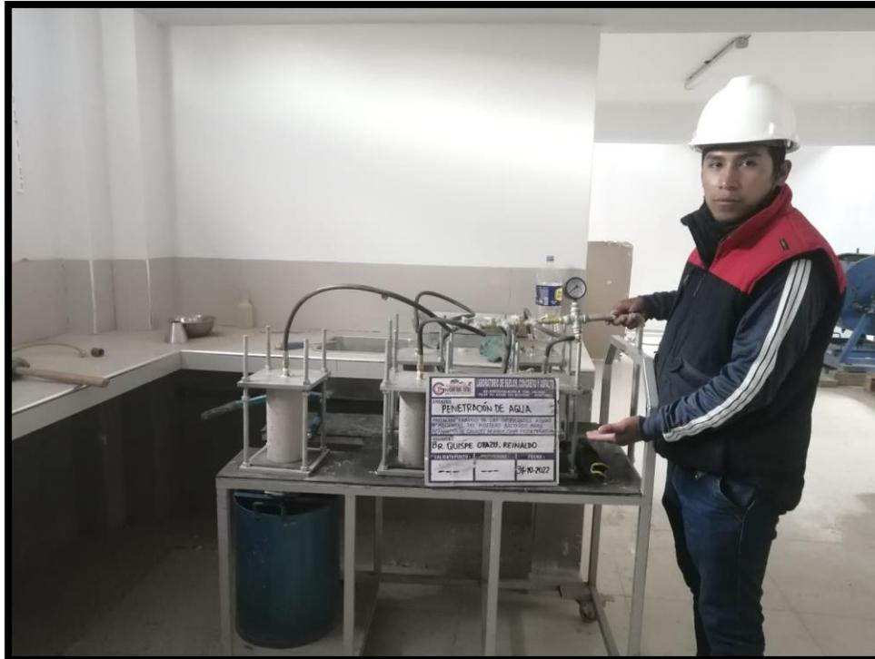
Fotografía N°13 Ensayo de penetración del agua a los 28 días
