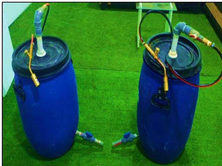
*Figura 10: Diseño de los biodigestores en la producción de biogás*
