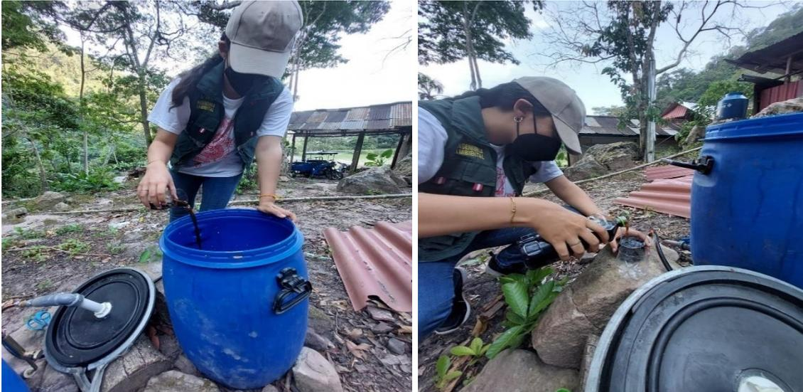
Figura 9: Aplicación de 200 ml de ME a los biodigestores
