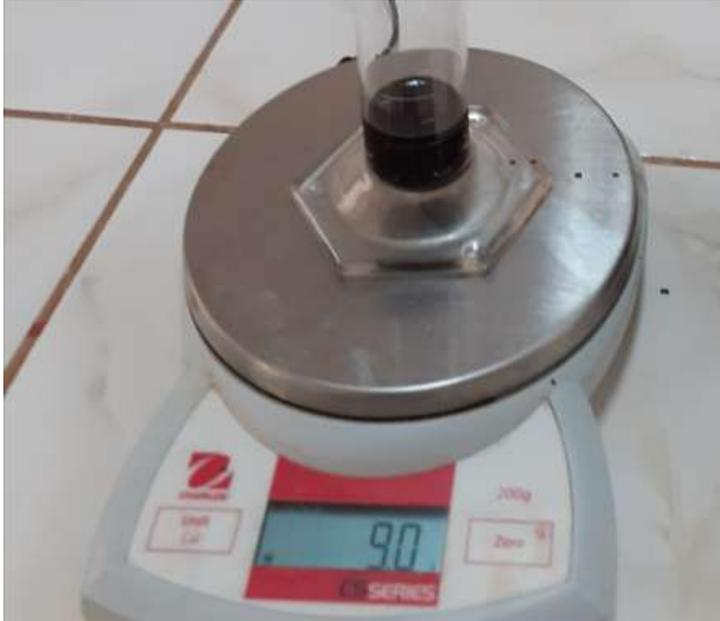
**Figura 13.** Determinación del gado API del petróleo.
