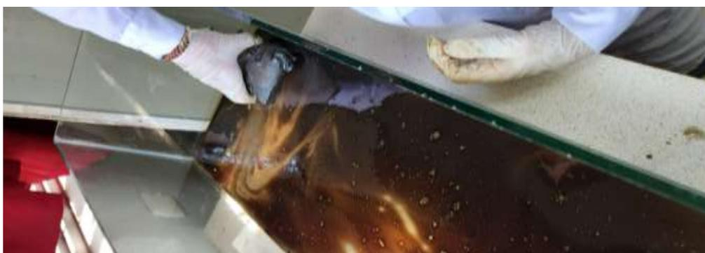
**Figura 21** Utilización del bio adsorbente en la simulación de derrames.
