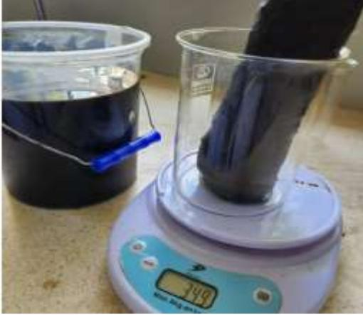
**Figura 18.** Pesado de adsorbente con el petróleo adsorbido.
