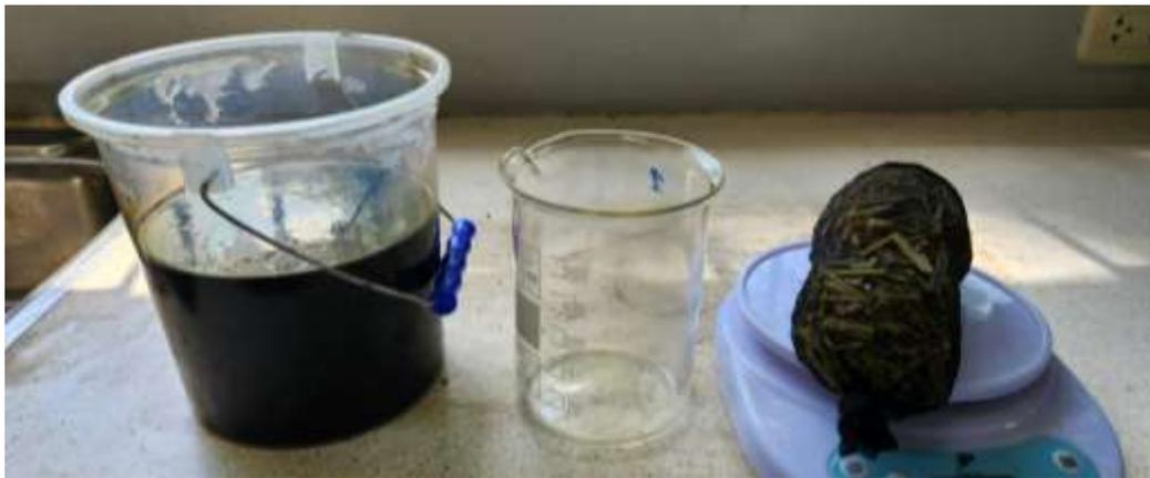
**Figura 14.** Recipientes para la prueba de saturación total.
