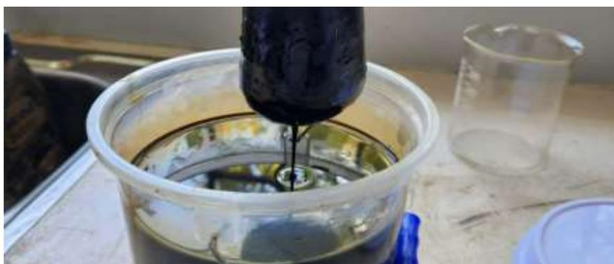
**Figura 17.** Escurrido por gravedad del petróleo del bio adsorbente.
