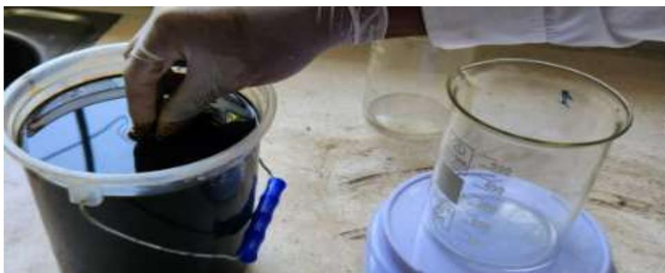
**Figura 16.** Sumergido de bio adsorbente en el petróleo
