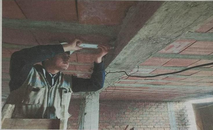
FOTO N°05: VISTA PANORAMICA DE ENSAYO DE ESCLEROMETRIA EN VIGA
