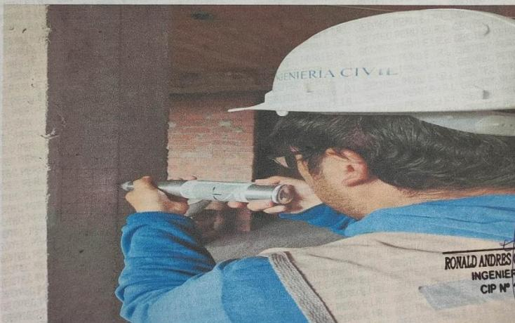
FOTO N°04: VISTA PANORAMICA DE ENSAYO DE ESCLEROMETRIA EN COLUMNA
