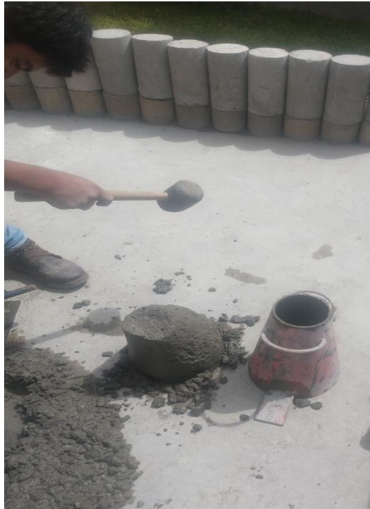
Fotografía. Ensayo de Slump
