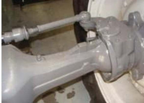
Figura 10. Eje delantero 4RM (Lateral)
