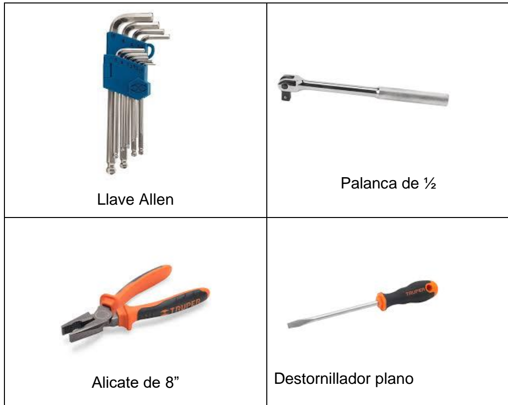
Figura 13. Herramientas usadas para mantenimiento
