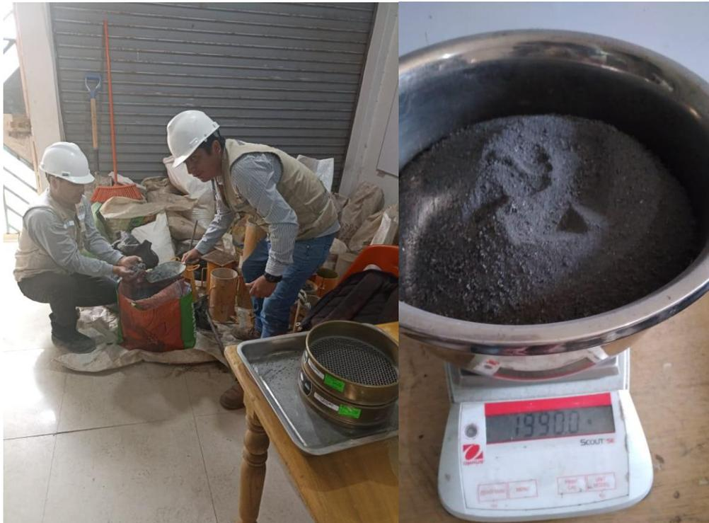
**Ensayo granulométrico de escoria de aluminio secundario**
