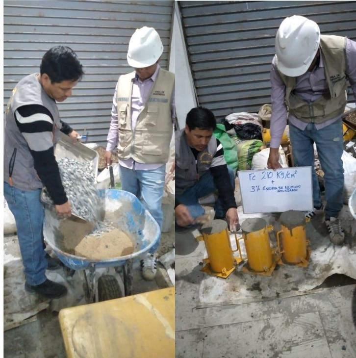
Elaboración de probetas y curado de probetas
