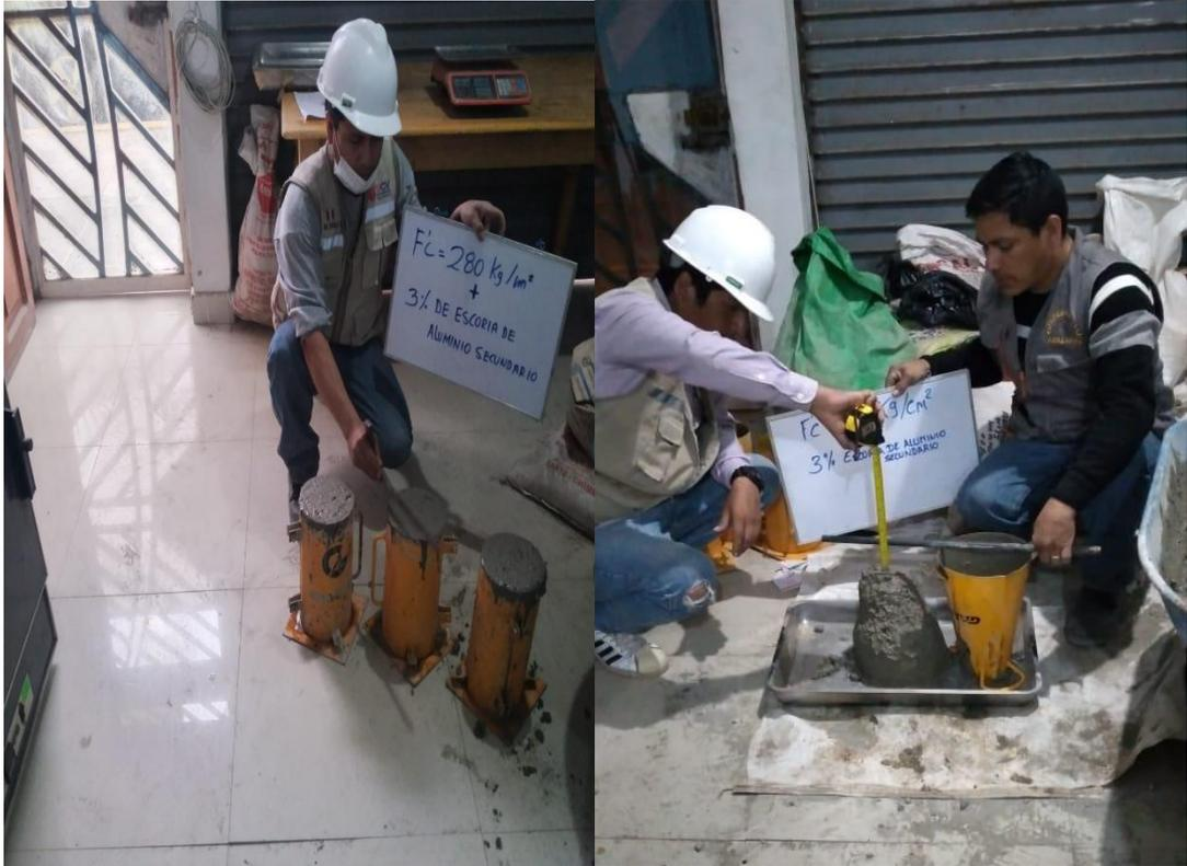
**Ensayo de asentamiento en concreto con escoria de aluminio secundario**
