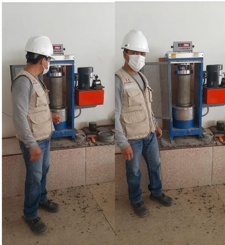
**Ensayo de resistencia a la compresión axial en concreto experimental con escoria de aluminio secundario**
