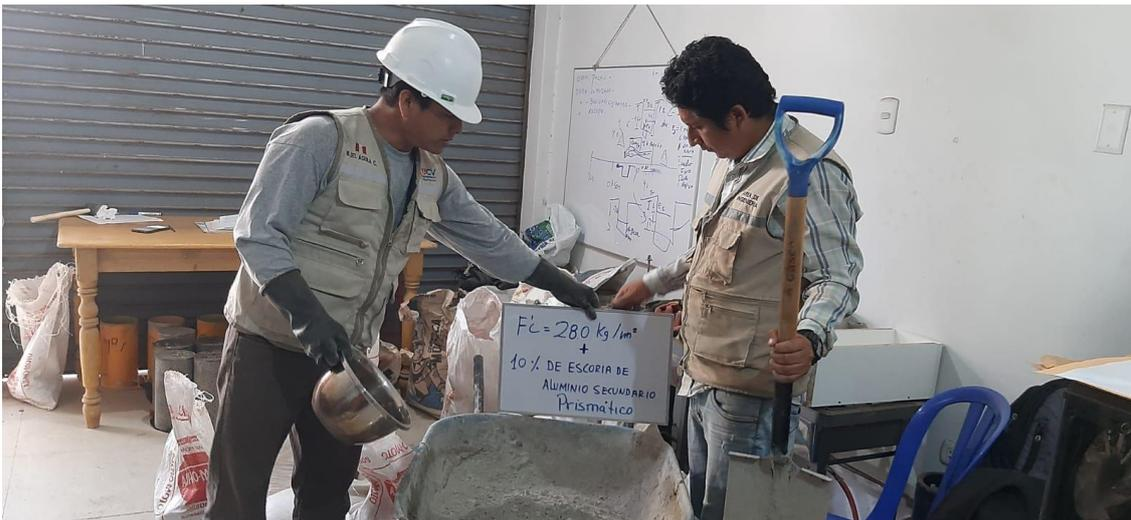
Figura 13. Preparación de viguetas prismáticas convencionales 280 y combinaciones de escoria de aluminio secundario
