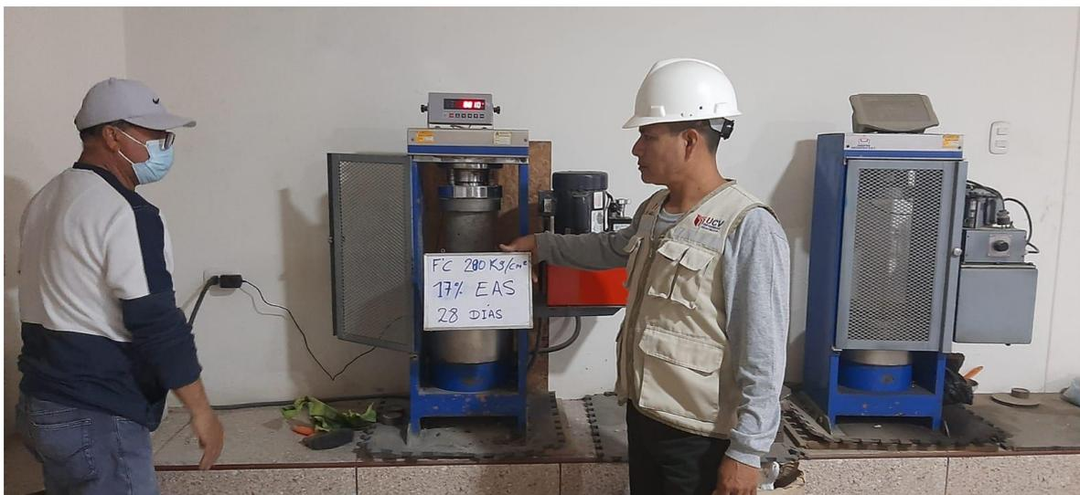
**Ensayo de resistencia a la flexión en concreto experimental con escoria de aluminio secundario**
