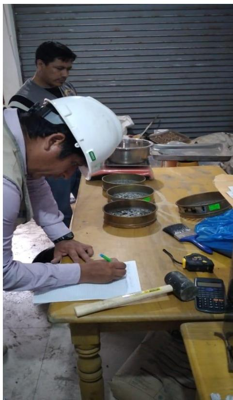
**Ensayo granulométrico de material pétreo**
