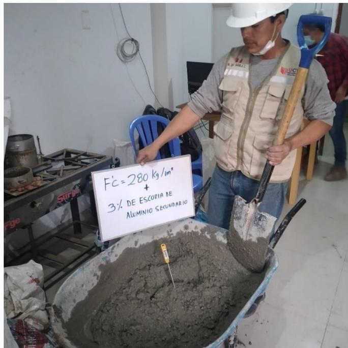
**Ensayo de temperatura en concreto con escoria de aluminio secundario**
