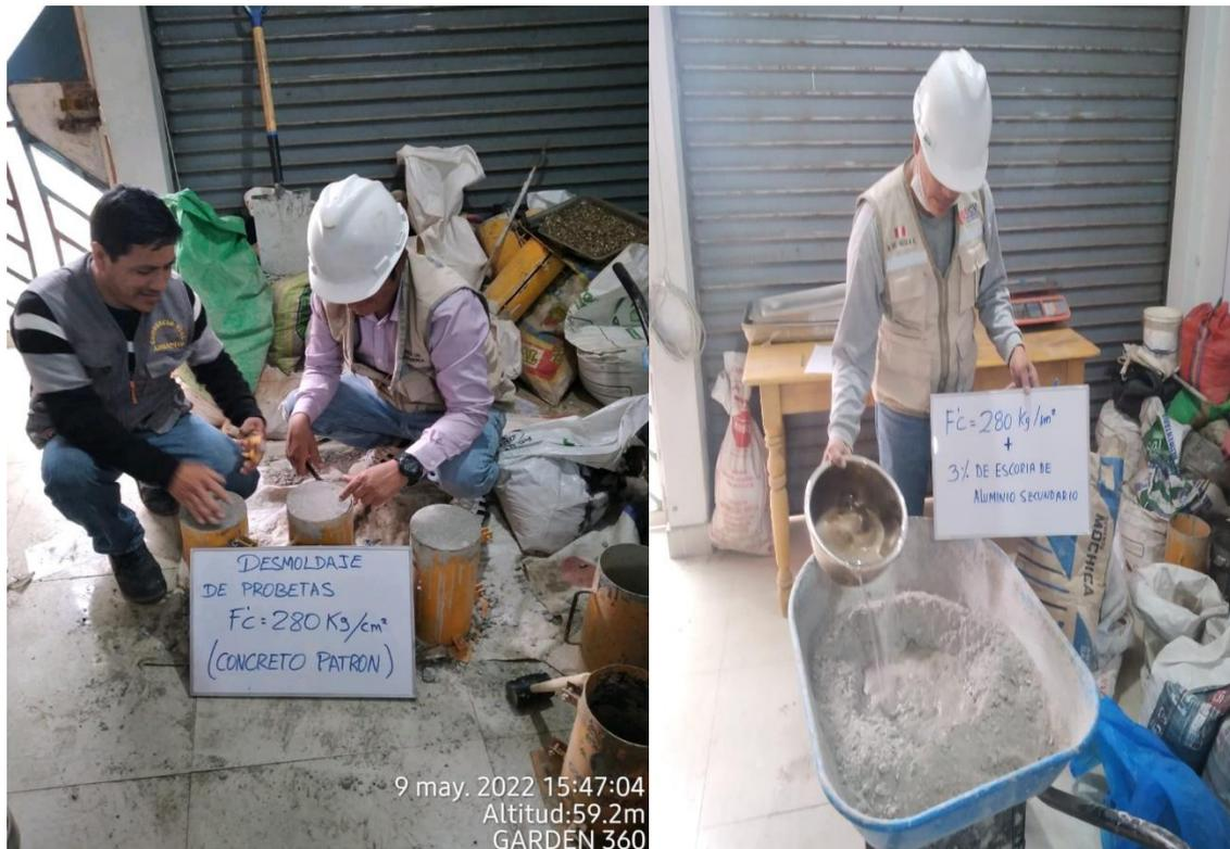
Elaboración de probetas y curado de probetas
