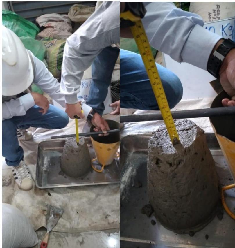
**Ensayo de asentamiento en concreto ordinario  $f'c$ : 210 Kg/cm<sup>2</sup>**
