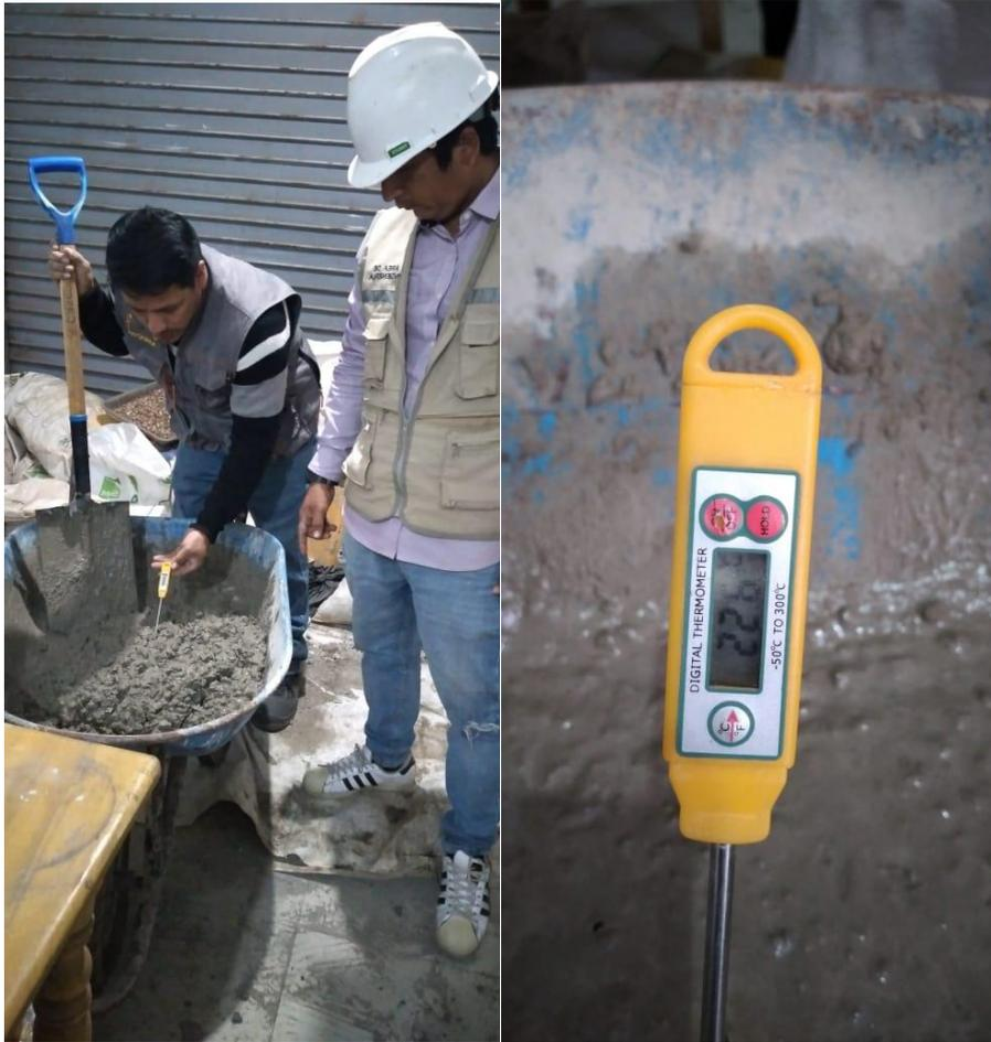
**Ensayo de temperatura en concreto ordinario**
