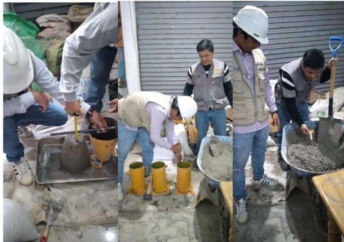
Figura 9. Ensayo de revenimiento del concreto ordinario y temperatura.
