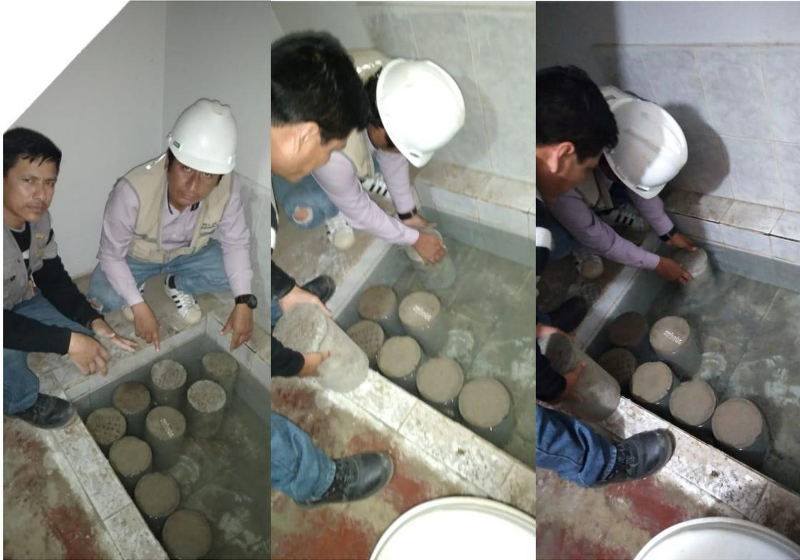
**Curado de probetas convencionales y con dosificaciones**
