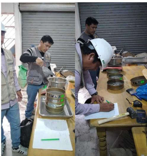
Figura 5. Peso de mallas correspondientes a los ensayos granulométricos de los agregados (fino y grueso).
