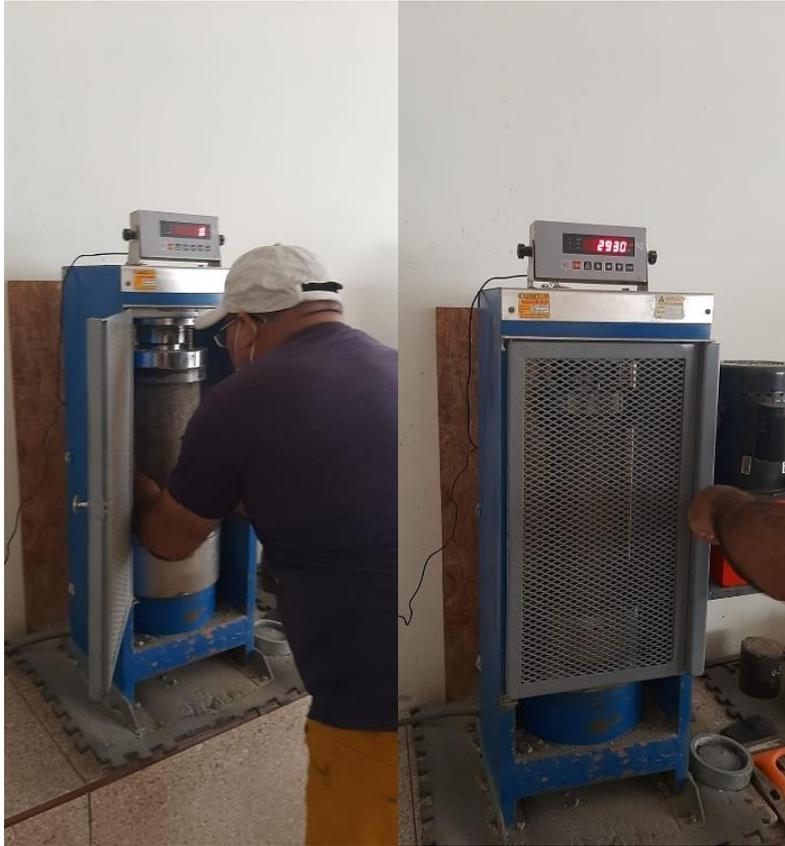
**Ensayo de resistencia a la compresión axial en concreto ordinario**
