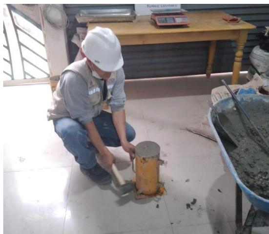
Figura 10. Ensayo de peso unitario en estado fresco en el concreto ordinario.
