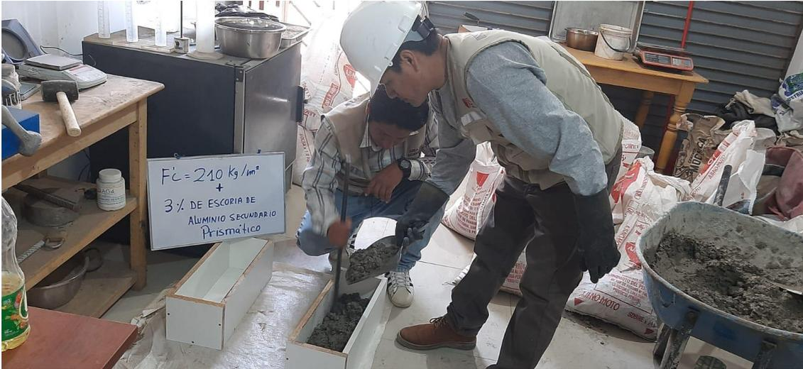
Figura 12. Preparación de viguetas prismáticas convencionales 210 y combinaciones de escoria de aluminio secundario
