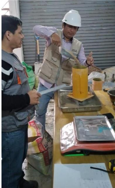
Figura 6. Peso unitario suelto y compactado para el agregado fino.
