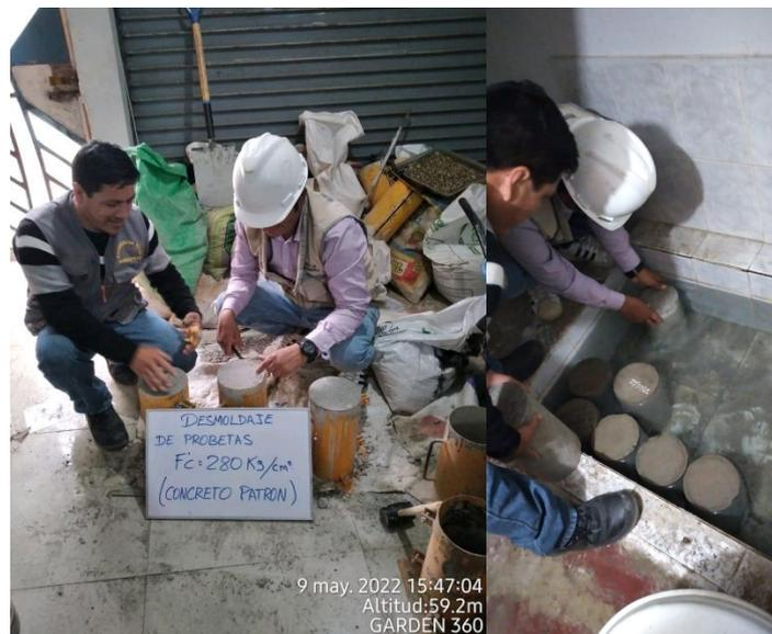
Figura 11. Día posterior del desencofrado y colocación de probetas de concreto ordinario en pozas de curación.
