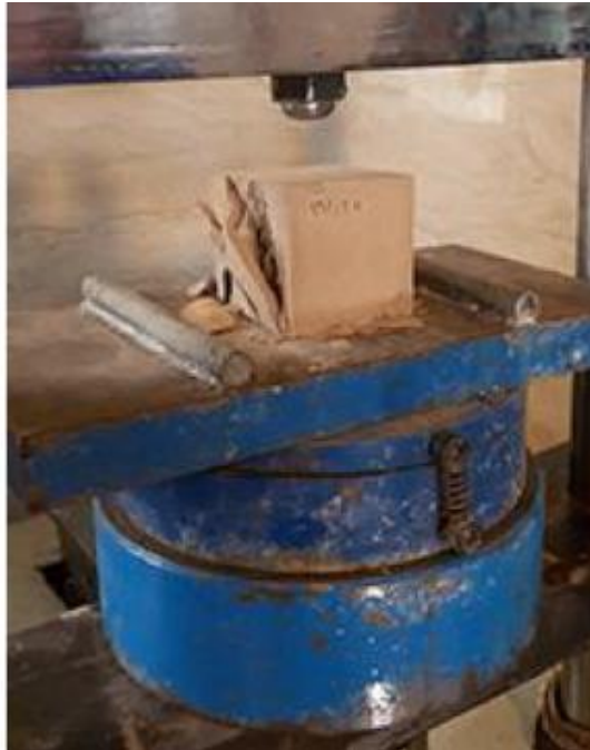
Figura 3. Aplicación de cargas en la prensa para la obtención de la resistencia. Obtenido de Dormohamadi y Rahimnia (2020, p. 10)
