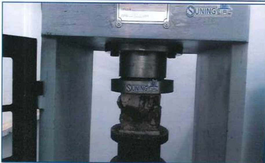
PROCESO: COMPRESIÓN DE ESPECIMEN DESCRIPCIÓN: Se procede a ensayar el espécimen de adobe y así calcular la resistencia última, se calcula conforme a la expresión siguiente: f_0 = 1.0MPa = 10.2 \text{ kgf/cm}^2
