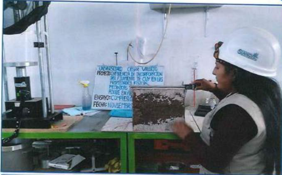
PROCESO: MEDIDAS DEL ESPECIMEN PRISMATICO A ENSAYAR DESCRIPCION: Se mide las caras a comprimir dos por cada cara (Base superior con base inferior y 4 medidas de altura una por cada cara, con una aproximación del 0.01mm.
