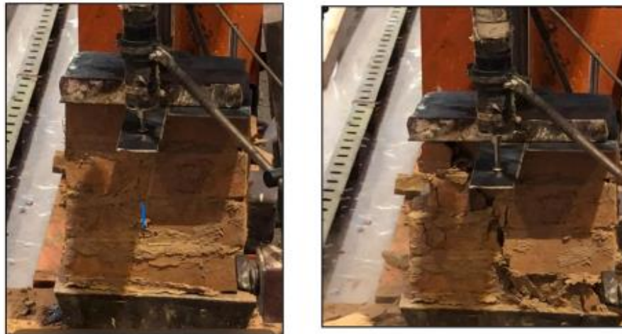
Figura 4. Aplicación de cargas a un prisma de albañilería. Obtenido de Khorasani y Kabir (2022, p. 8)
