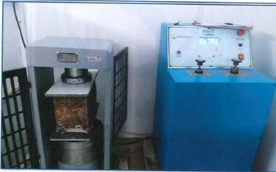
PROCESO: COMPRESIÓN DE ESPECIMEN DESCRIPCION: Se procede a ensayar el espécimen de adobe después del secado de 28 días, su resistencia ultima no debe ser menor a 0.6 MPa = 6.12 kaf/cm2
