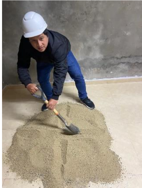
Figura 9. Cuarteado de material
