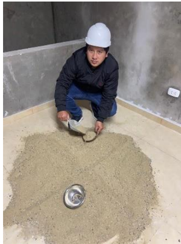
Figura 5. Toma de 2 muestras de partes opuestas
