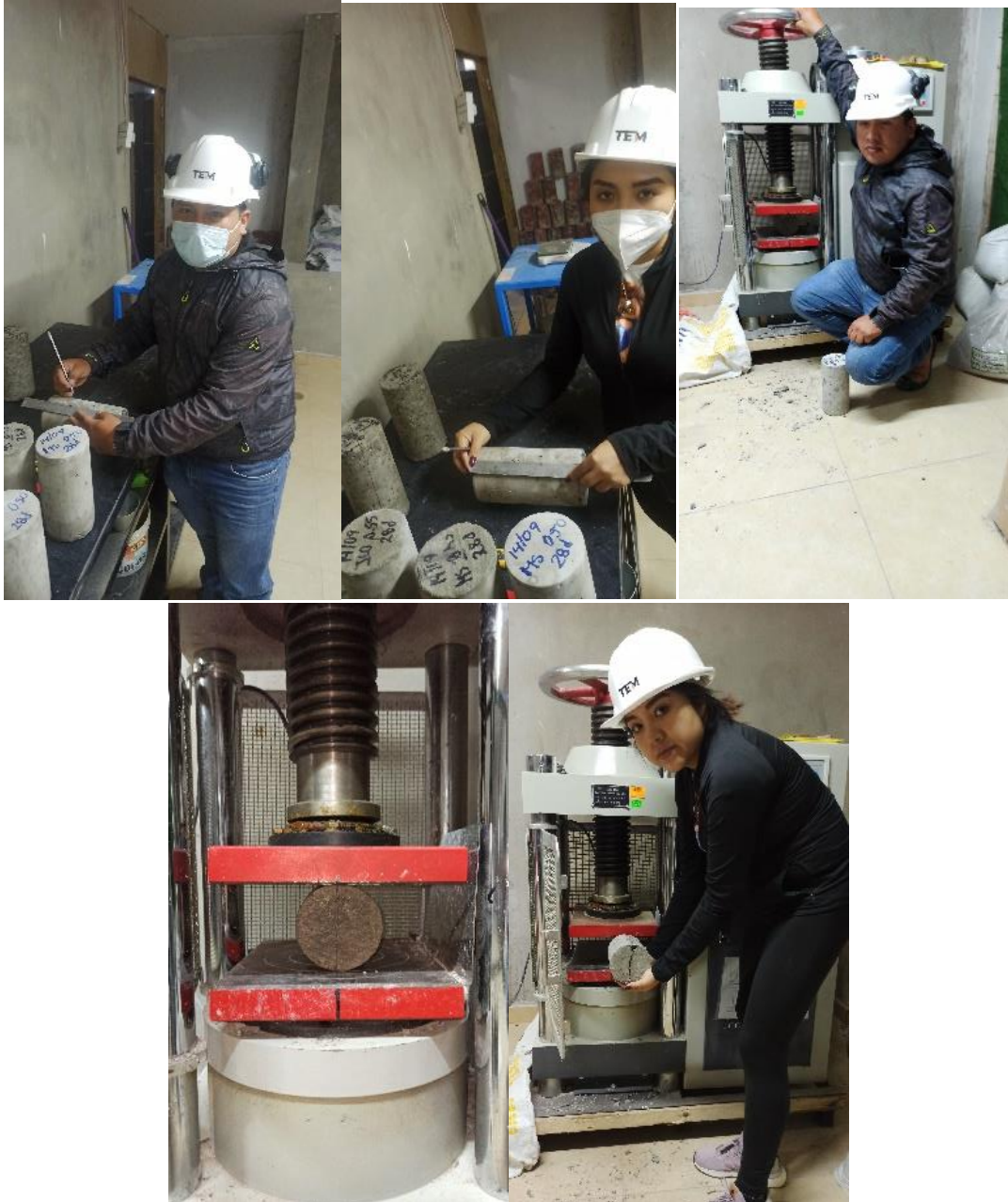
Figura 34. Ensayo resistencia a la Tracción.
