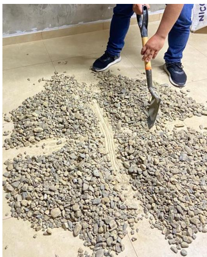
Figura 23. Cuarteo del material - Piedra
