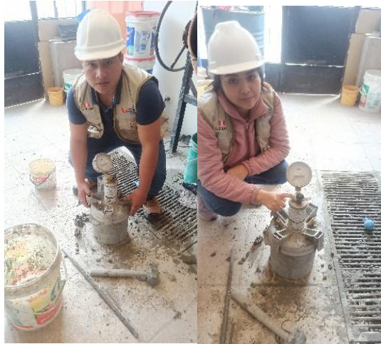
Figura 32. Ensayo contenido de aire
