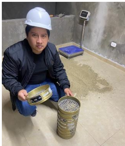
Figura 17. Identificación de tamaño máximo nominal
