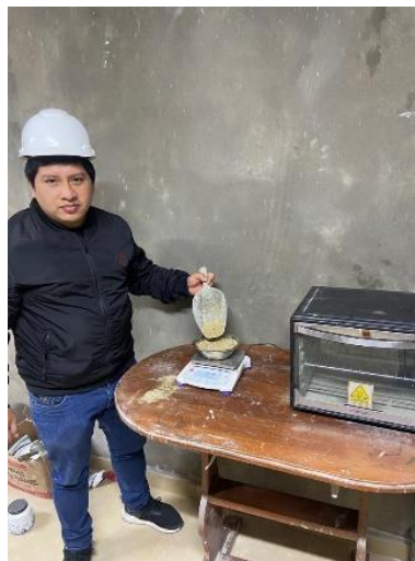
Figura 8. Pesado de material seco
