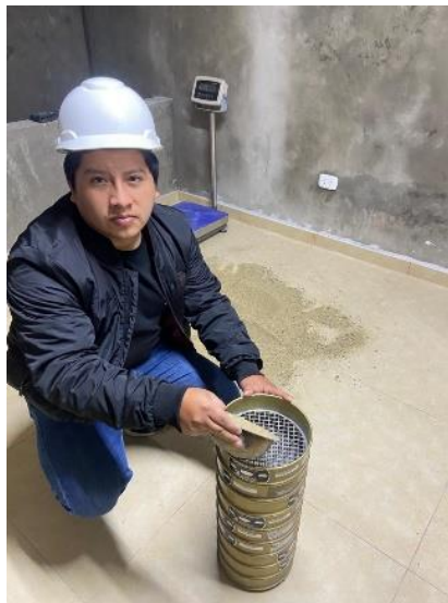
Figura 16. Tamizado de Arena (4,8,16,30,50,100,200)
