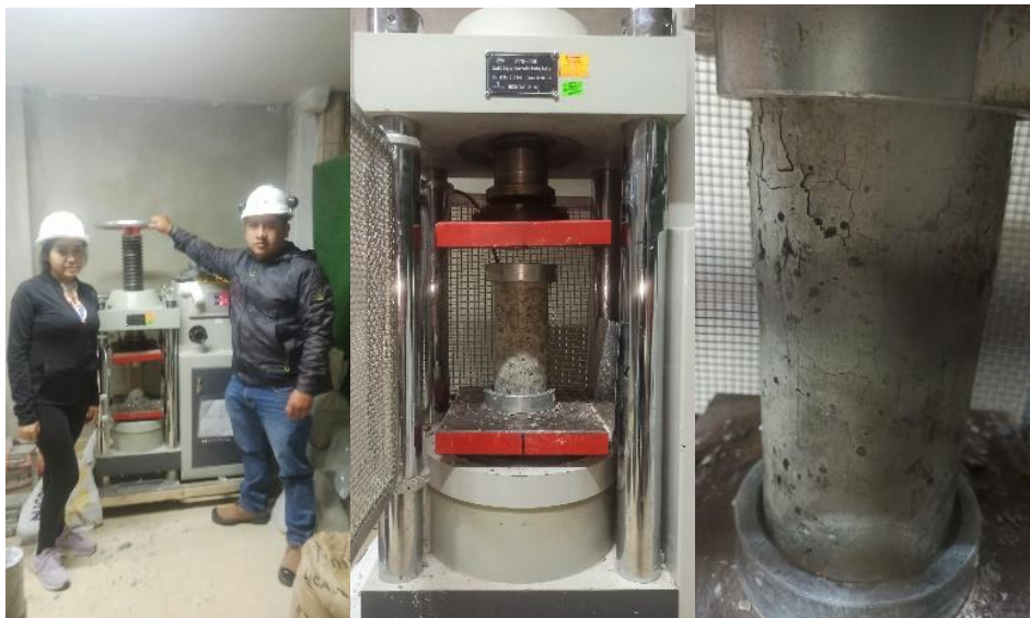
Figura 33. Ensayo resistencia a la compresión.
