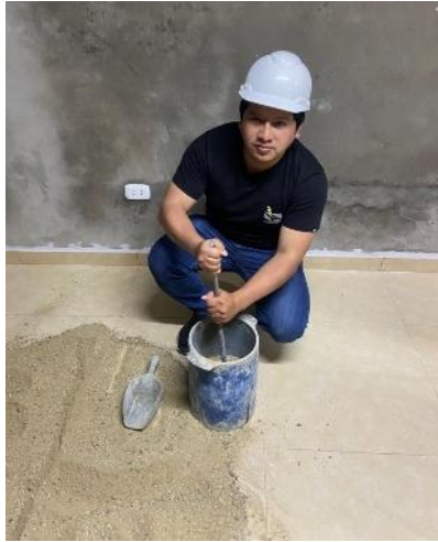
Figura 11. Varillado del material 25 veces por capa (3 capas)
