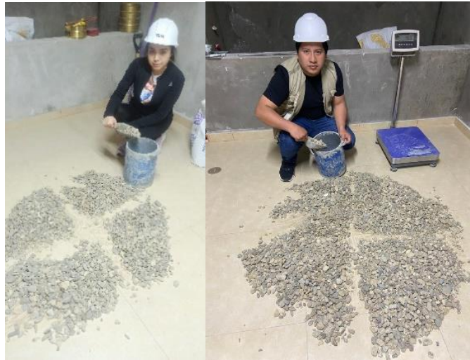
Figura 20. Toma de 2 muestras de partes opuestas
