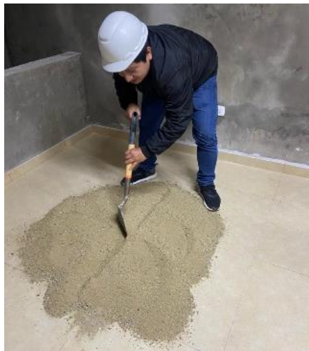
Figura 14. Cuarteo del Material - Arena
