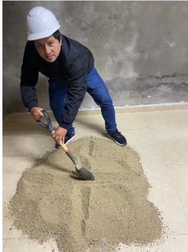
Figura 4. Método de cuarteo
