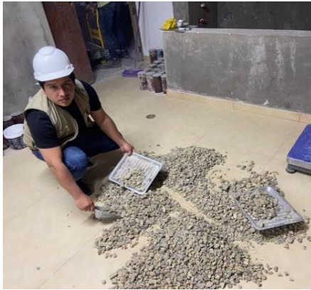
Figura 24. Toma de la muestra
