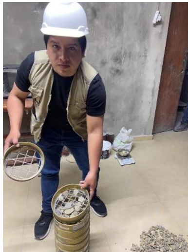
Figura 26. Identificación de tamaño máximo nominal
