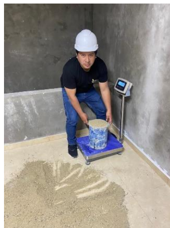
Figura 13. Pesado del material
