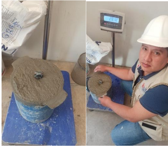
Figura 29. Ensayo de Temperatura
