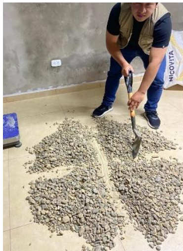
Figura 19. Método de cuarteo
