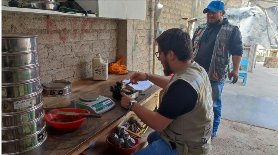
Figura 53: determinación Límites de consistencia
