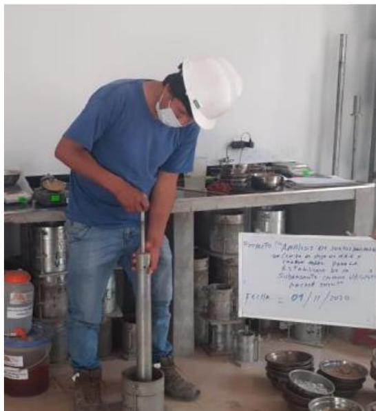
Figura 11. Equipo para determinar curva de compactación
