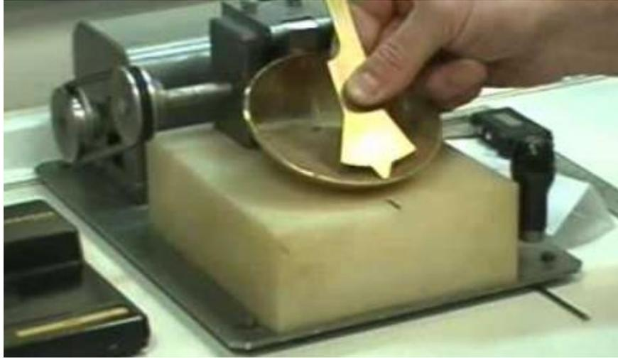
*Figura 9. Equipo para determinar el límite líquido del suelo.*
