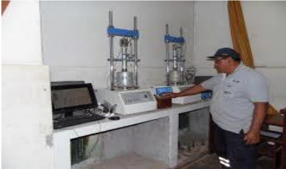
*Figura 13. Equipo para determinar el CBR.*
