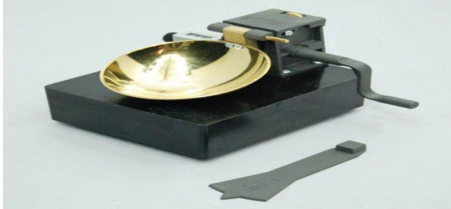
Figura 6. Equipo para determinar límite líquido de una muestra de suelo.
