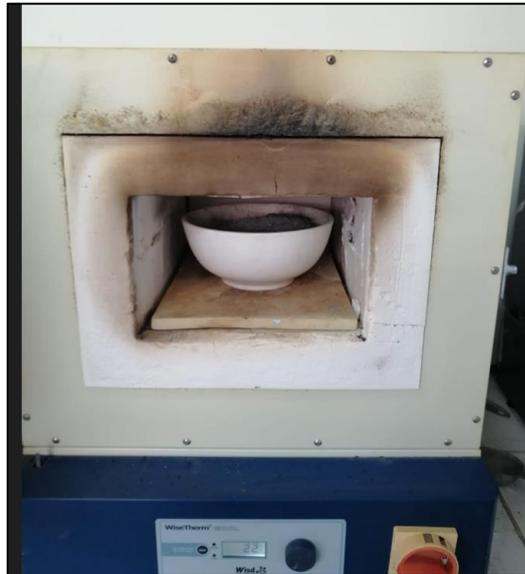
Figura 22: activación térmica de las cenizas de tallo de maíz
