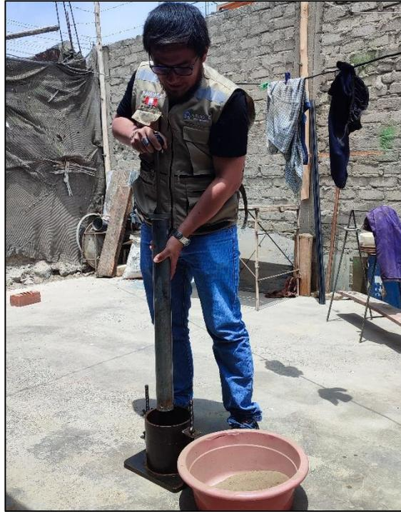
Figura 44: Proctor modificado para muestra natural
