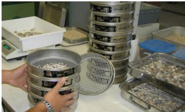
Figura 4. Equipo para realizar el análisis granulométrico de un suelo.
