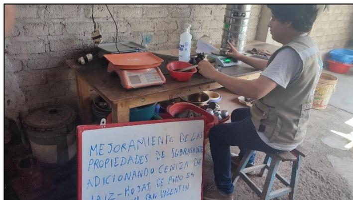
Figura 42: Determinación del límite líquido y plástico
