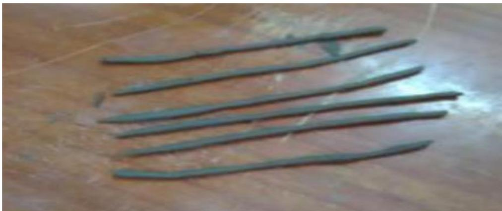
Figura 8. Muestra de suelo en estado plástico.
