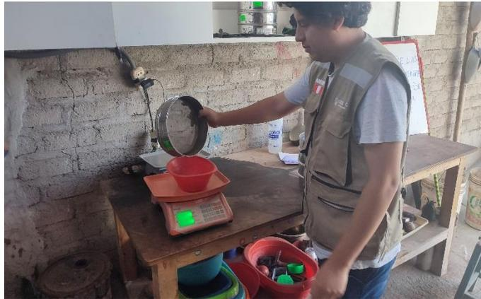
**Imagen 11:** Peso del resultante de la muestra por el tamiz
