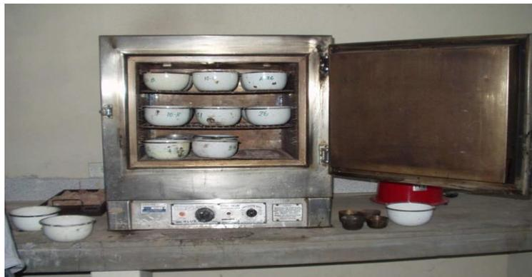
*Figura 12. Equipo para determinar el contenido de humedad*
