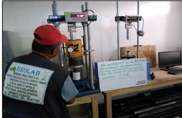
Figura 47: Ensayo de CBR de muestra natural
