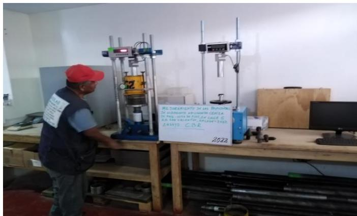
**Imagen 18:** Ensayos de CBR a las muestras con cenizas
