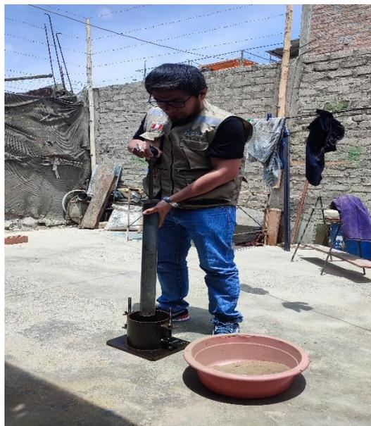
**Imagen 16:** Ensayos de proctor modificado
