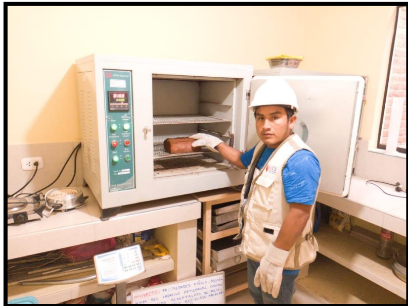
Fotografía 23: Absorción, evidencia colocación de la muestra sumergida en agua para el secado en el horno, el cual obtendremos la masa seca.
