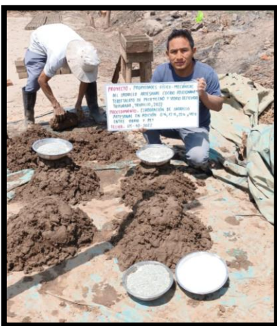
Fotografía 5: Arcilla más adición al 0%, 8%,13% y 19% de tereftalato de polietileno y vidrio reciclado triturado
