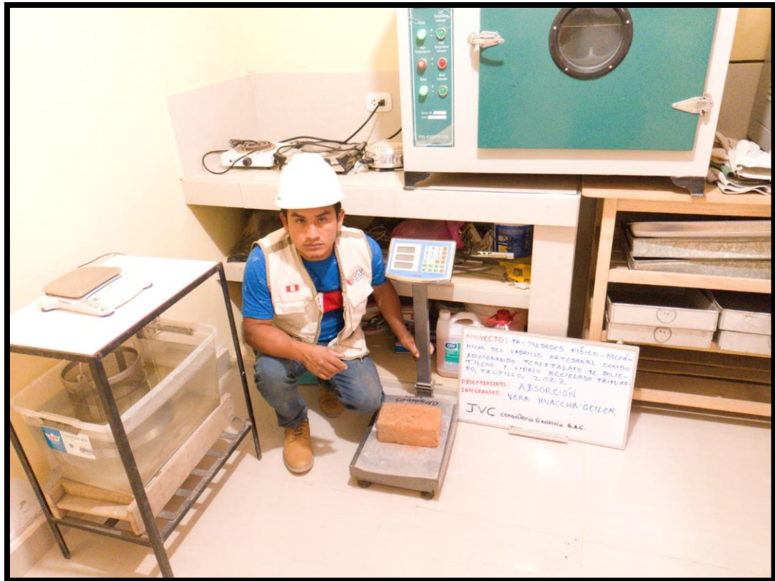
Fotografía 21: evidencia absorción de agua
