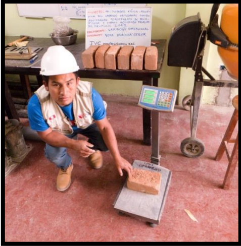
Fotografía 15: Evidencia peso del ladrillo
