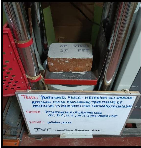
Fotografía 11: Ensayo Resistencia a la compresión con adición al 8%
