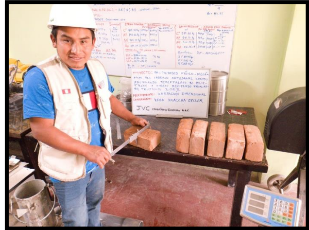
Fotografía 16: Variación dimensional, ancho del ladrillo artesanal.
