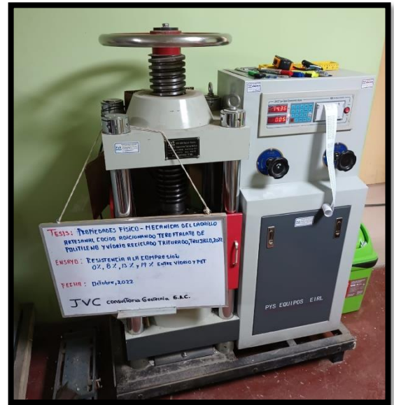
Fotografía 12: Ensayo Resistencia a la compresión con adición al 13%
