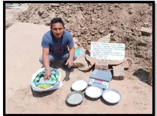
Fotografía 4: Peso de tereftalato de polietileno y vidrio reciclado triturado para las diferentes adiciones en gr (%)
