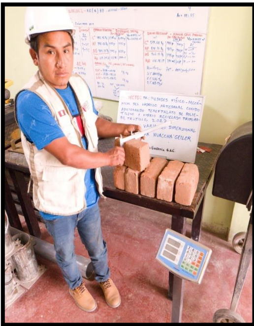
Fotografía 17: Variación dimensional, alto del ladrillo artesanal cocido.
