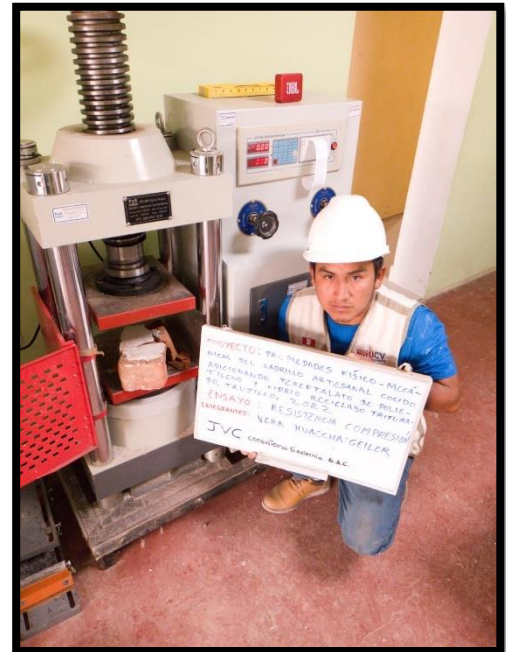
Fotografía 14: Evidencia rotura del ladrillo, resistencia a la compresión
