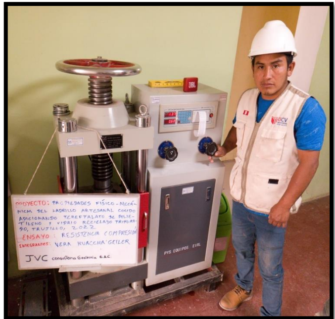
Fotografía 10: Ensayo resistencia a la Compresión, en prensa hidráulica dichos resultados arrojados en KN.
