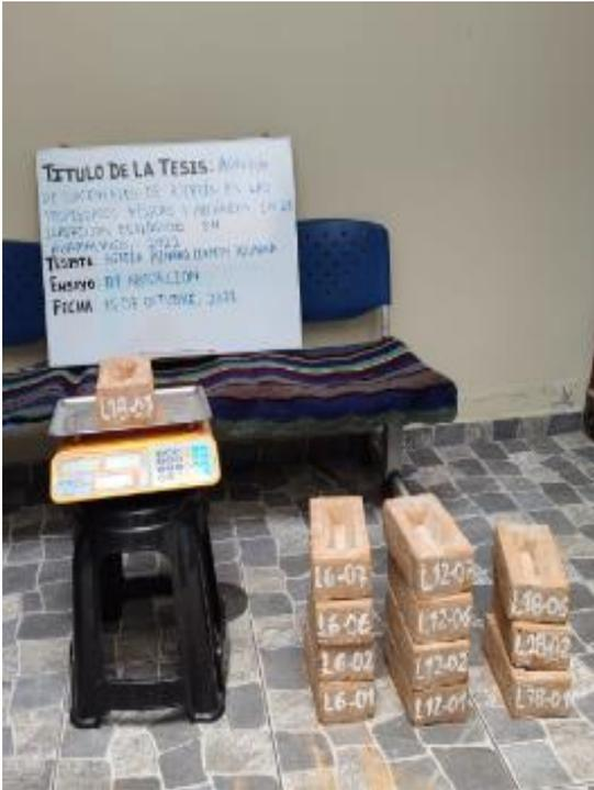
Ensayo de absorción de los ladrillos.
