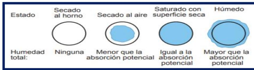
Figura 1. Condiciones de humedad de los agregados.
