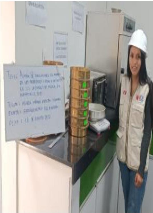
Ensayo de granulometría del aserrín .
