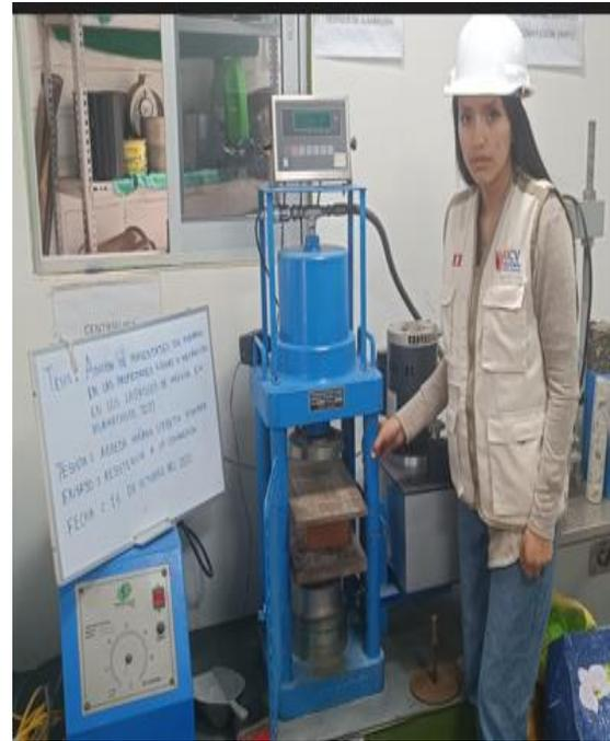
Ensayo de resistencia a la compresión.
