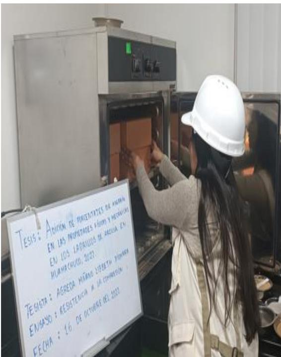
Secado de las muestras para el ensayo de resistencia a la compresión.
