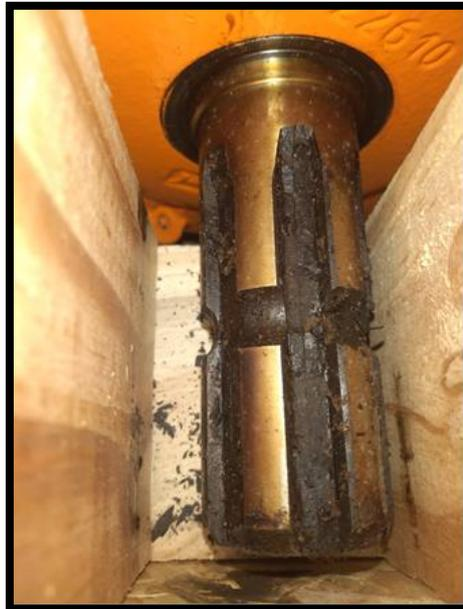
**Imagen 05.** *Cero Desgastes de Estrías en el Eje de Cigüeñal.*
