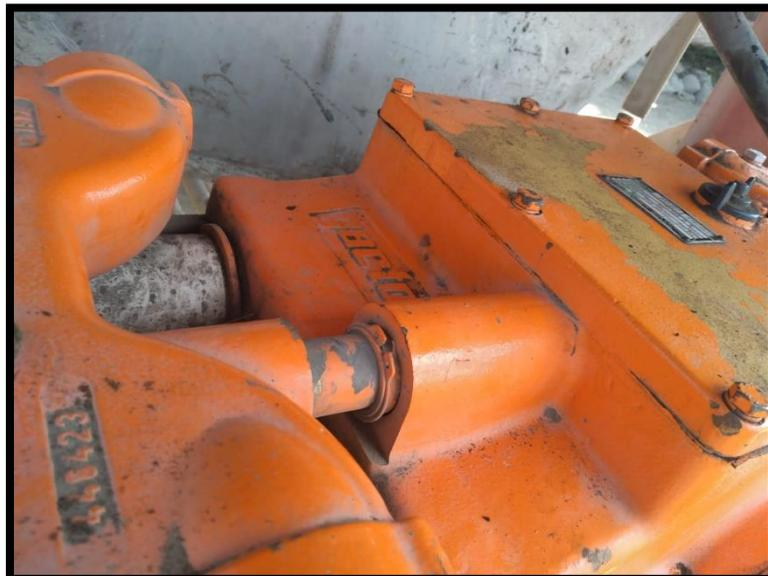
**Imagen 06.** *Bomba de desplazamiento Positivo*
