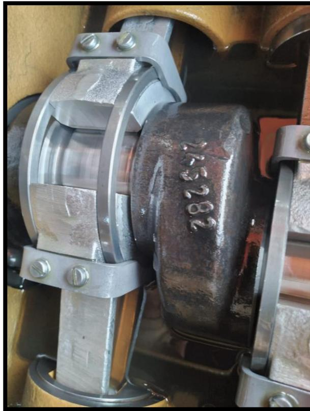
**Imagen 06.** *Cero desgastes de puños de cigüeñal - Cero desgastes en asiento de biela - Cilindros sin roturas y seguros sujetadores de bielas sin desgates.*
