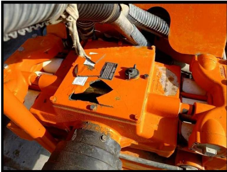
**Imagen 07.** *Rotura de Carcaza de Bomba de desplazamiento Positivo.*
