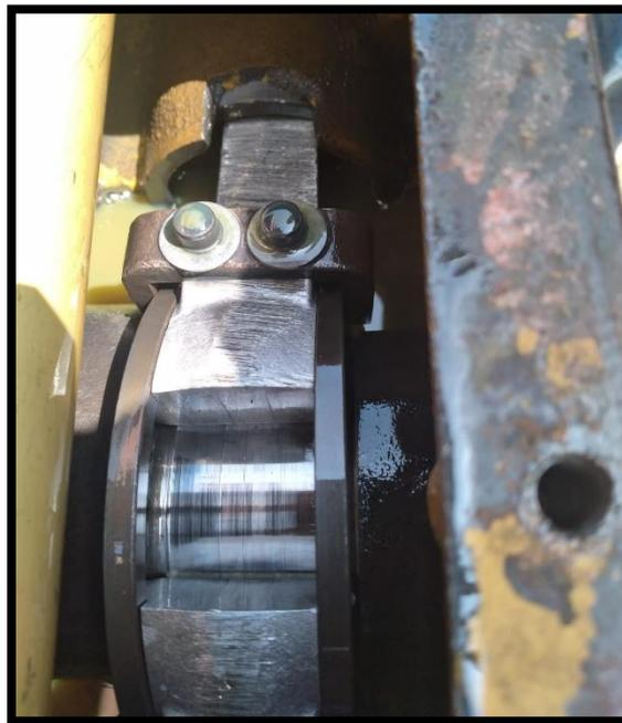
**Imagen 03.** *Roturas de cilindro guía del pistón de bomba producto de la rotura del aro sujetador de bielas - Ralladuras de los puños de cigüeñal (fricción entre puño de cigüeñal y asiento de biela) - Recalentamiento en toda la carcasa de la bomba - Fugas de aceite por el tapón de desfogue producto del recalentamiento.*
