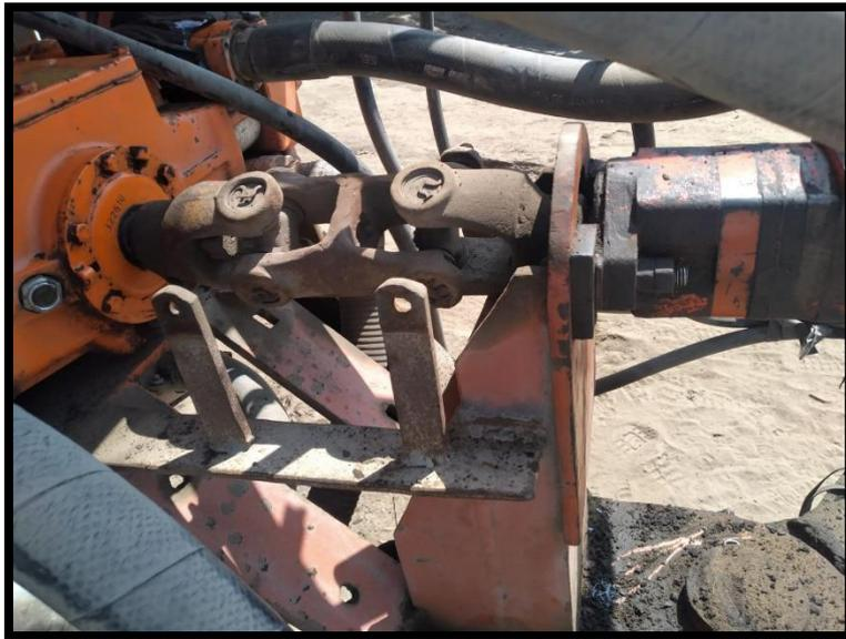
**Imagen 04.** *Bomba Accionada por Motor Hidráulico.*
