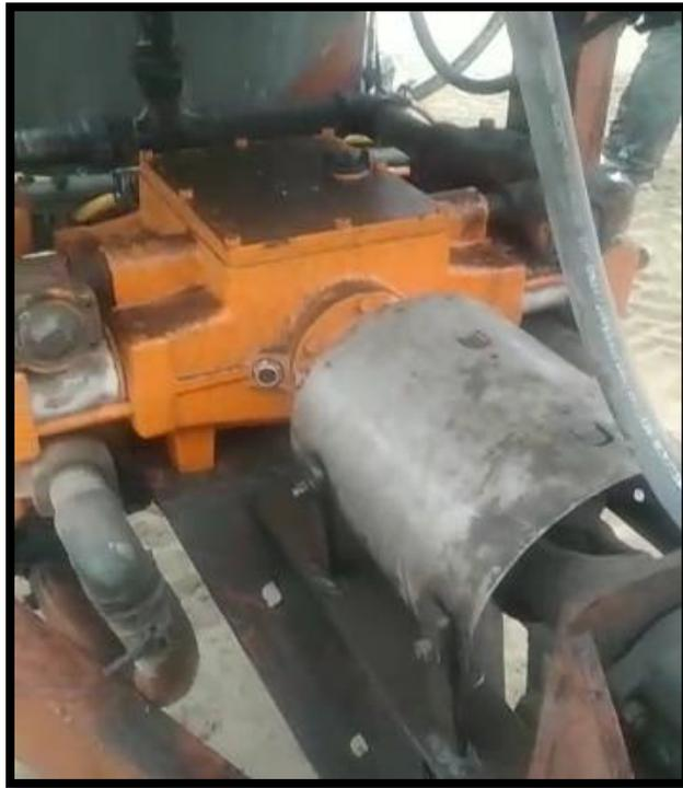
**Imagen 09.** *Colocación de Guarda de Seguridad.*
