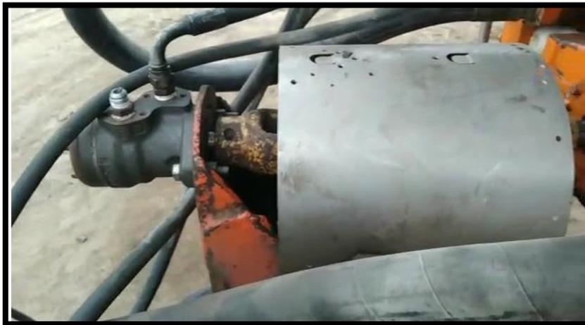
**Imagen 10.** *Motor Hidráulico - Cardan de 40 cm – Guarda de Seguridad acoplados a BDP.*
