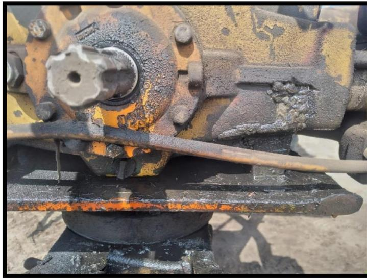
**Imagen 02.** *Desgaste en las estrías del cigüeñal - Fugas excesivas de aceite por el retén de cigüeñal - Roturas de carcasa especialmente en bases de fijación de bomba.*
