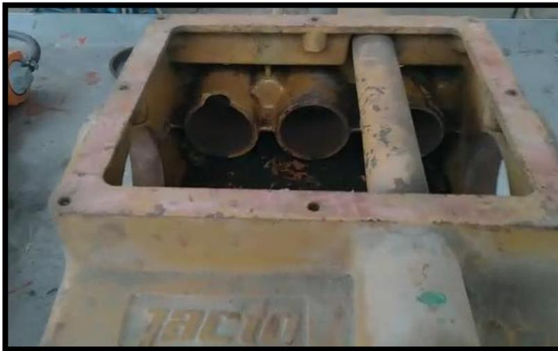
**Imagen 12.** *Rotura de Cilindros internos ocasionada por falla de biela en BDP.*
