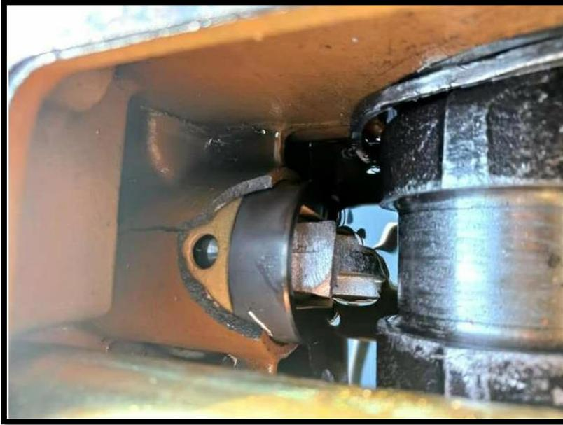
**Imagen 11.** *Rotura de Cilindro interno de BDP.*
